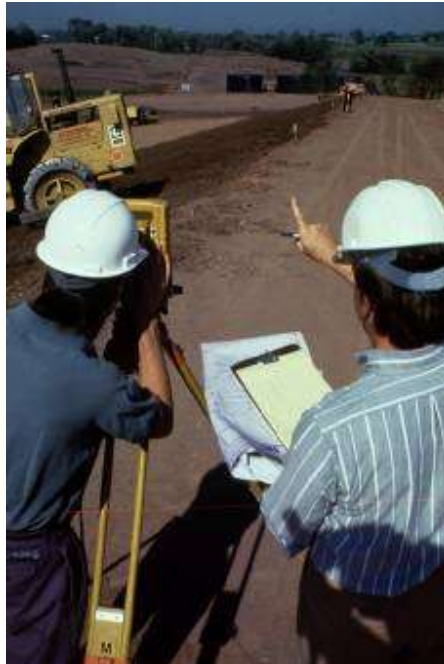
Figura 5. El ingeniero de la izquierda mira a través del ocular de la Estación Total hacia la 'mira' que sostiene un segundo ingeniero en la carretera. Las medidas topográficas que se realizan son las distancias horizontales y los ángulos vertical y horizontal. El tercer miembro del equipo toma nota de los datos.
