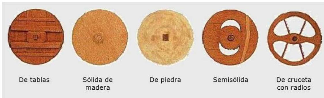
Fig. 1.1 – Diferentes tipos de rueda empleados en la antigüedad.
