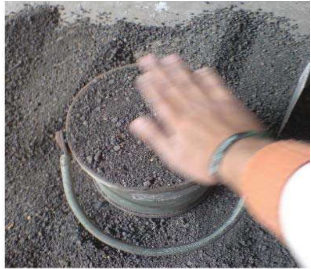
Peso y enrasado del agregado.
