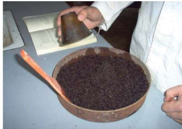
Saturado del agregado y uso del cono metálico.
