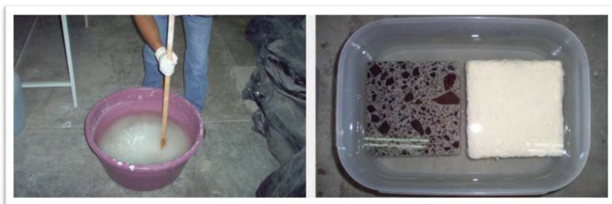
De izquierda a derecha, preparado de la solución e inmersión de los especímenes en la solución.
