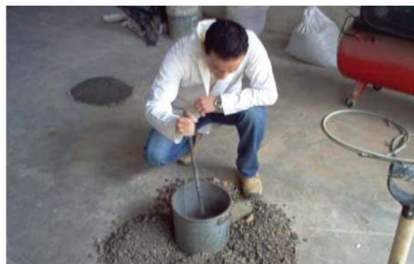
Varillado del agregado.
