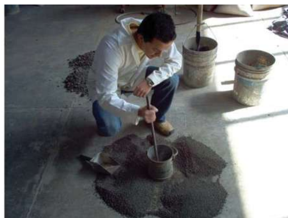
Compactación del agregado por medio del varillado.
