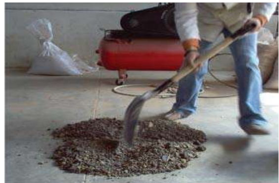
Cuarteo de grava y arena con pala.
