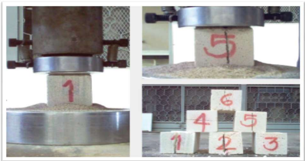
Cubos sometidos a compresión utilizando para esto la máquina universal Forney.
