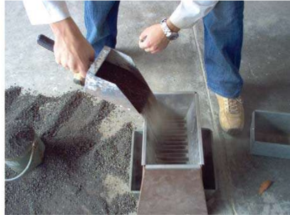
Cuarteo de arena usando un divisor de muestras.
