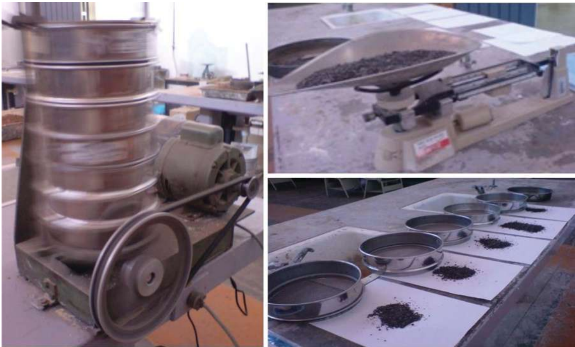
Peso, agitación y distribución de la arena para la realización del análisis granulométrico.
