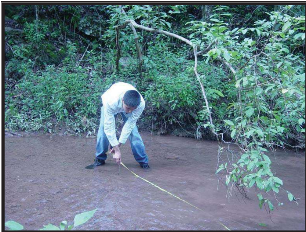
Foto 4. Medición indirecta del caudal en el sitio del manantial
