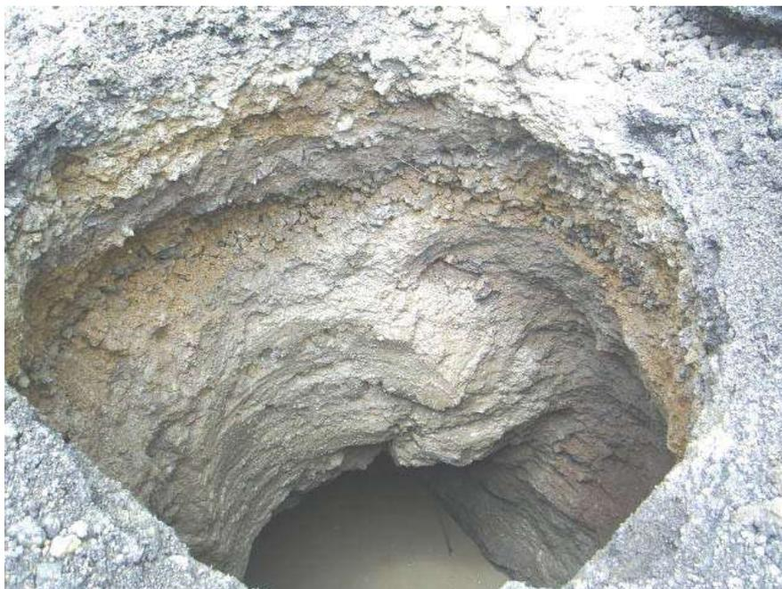
Foto 1: Cavernas por inestabilidad del terreno y presencia del agua freática.
