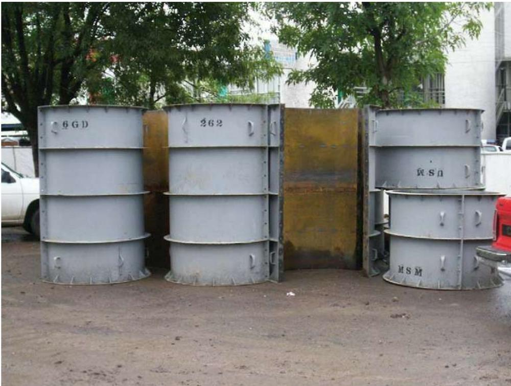
Foto 5: Cimbra deslizante de acero de 1, 2 y 2.5 m de longitud, diámetro de 1.20 y 1.40 m.
