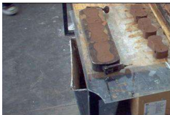
Fig. 34. Briquetas coladas y descimbradas.
