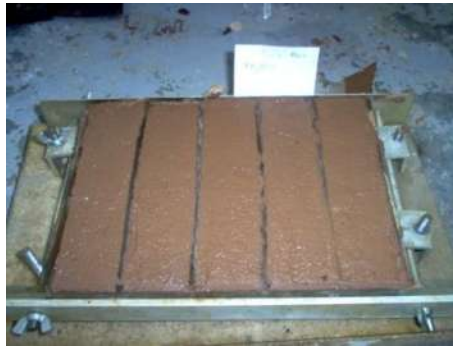
Fig. 37. Colado de las vigas de arcilla.
