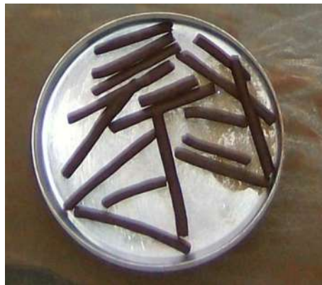
Fig 26. Rollitos de 1/8" para determinar el límite plástico.
