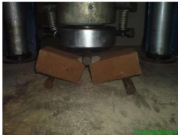
Fig. 38. Aplicación de la carga a la viga.
