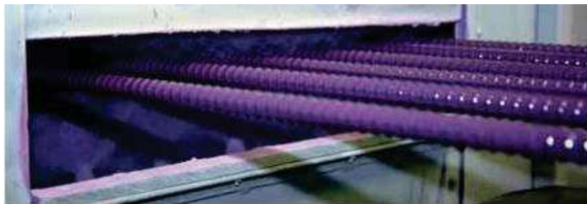
Fotografía 2.1. Proceso de Aplicación del recubrimiento Epoxi Fundido (FBE). 1
