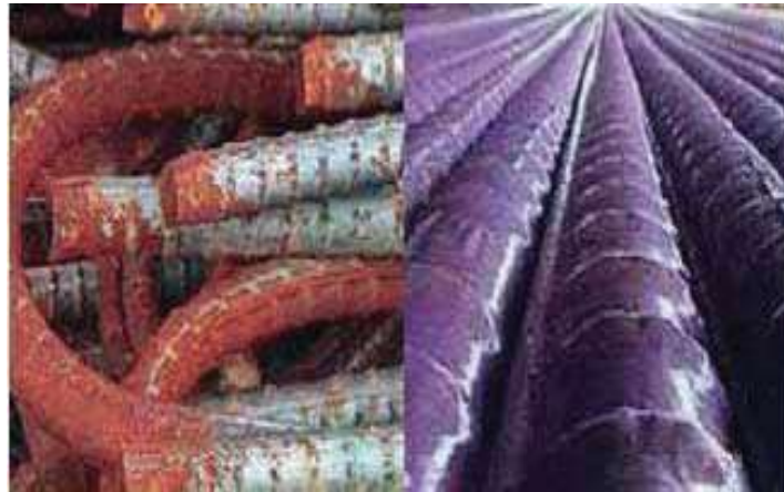
Fotografía 2.6. Barras antes y después de ser recubiertas con inhibidores MCI. 1
