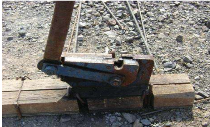
Fot. 21 Cortadora de acero por medio de palanca, para ésta operación se necesitan dos operarios.
