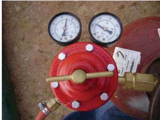
Fot. 23 Manómetro para tomar lecturas de presiones
