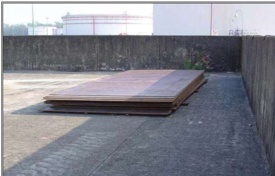
Fig. 2.2.- Almacenamiento y estiba de placas.
