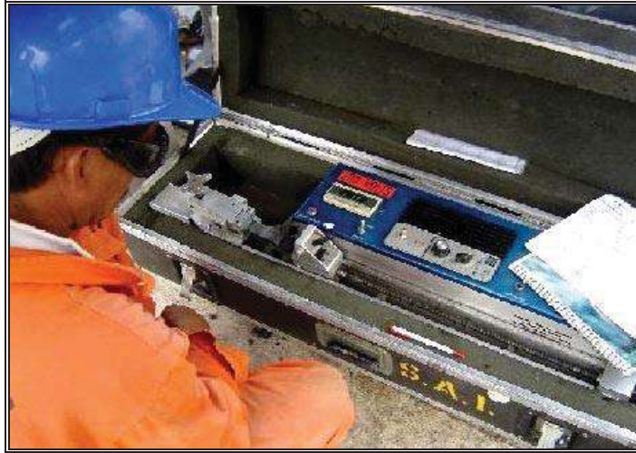
Fig. 4.10.- Tensómetro para pruebas de soldadura
