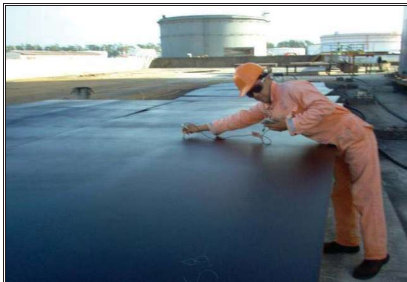
Fig. 5.5.- Calibración de espesor de recubrimiento primario RP-5.
