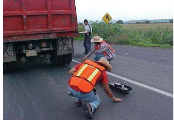
Medición en las llantas lado derecho a cada 20 Mts en tramos representativos.
