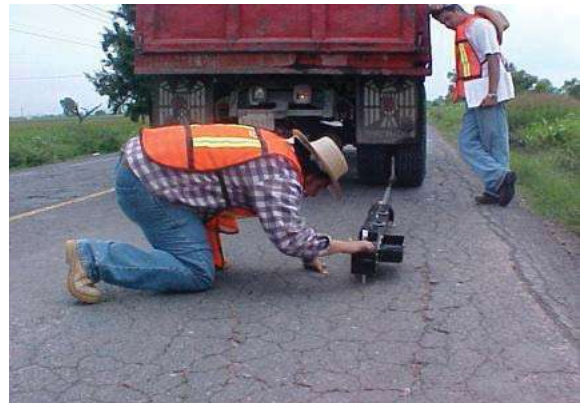
en cada lectura hay que volver a colocar el mano metro en un buen rango de movimiento para no obtener resultados erróneos.
