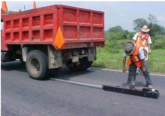
toma de lectura del lado izquierdo del eje para obtener resultado mas exactos de las deflexiones.
