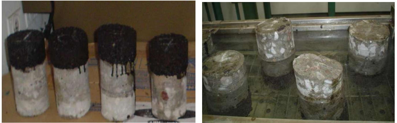
FIGURA 6.4 PROBETAS EN SECO Y TRAS INMERSIÓN, RESPECTIVAMENTE
