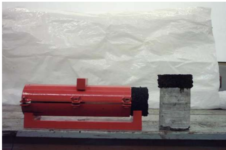
FIGURA 6.3 PROBETA FUERA DEL MOLDE DE ACERO Y PROBETA LISTA PARA SER ENSAYADA
