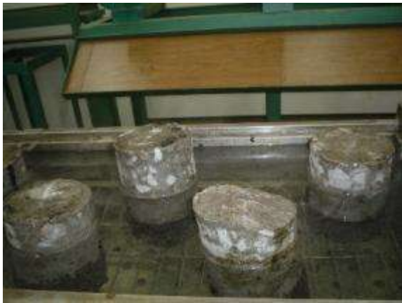
Probetas sumergidas en agua para realizar ensayos en su modalidad tras inmersión.
