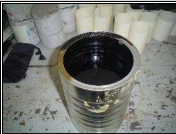
Muestra de 3kg de Asfalto AC-20 convencional, parte del asfalto fue modificado con polímeros.
