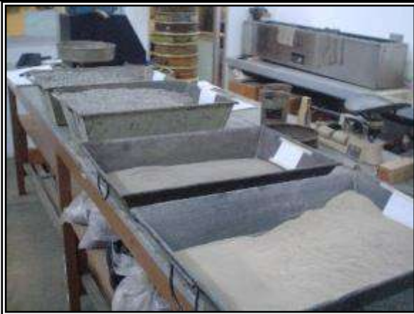
Material pétreo cribado para fabricación de mezcla asfáltica.
