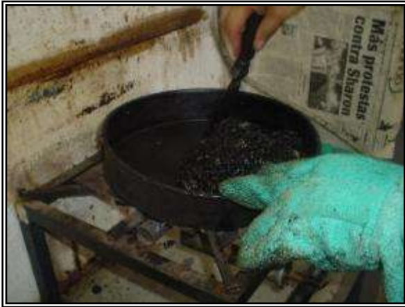
Incorporación en caliente de asfalto AC-20 al agregado pétreo.
