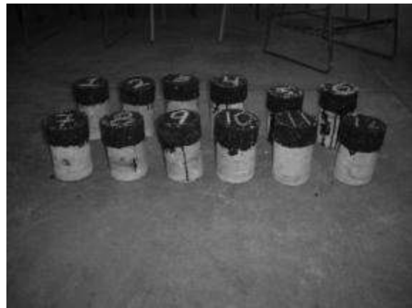
Corazones de concreto hidráulico ligados a pastillas de mezcla asfáltica.
