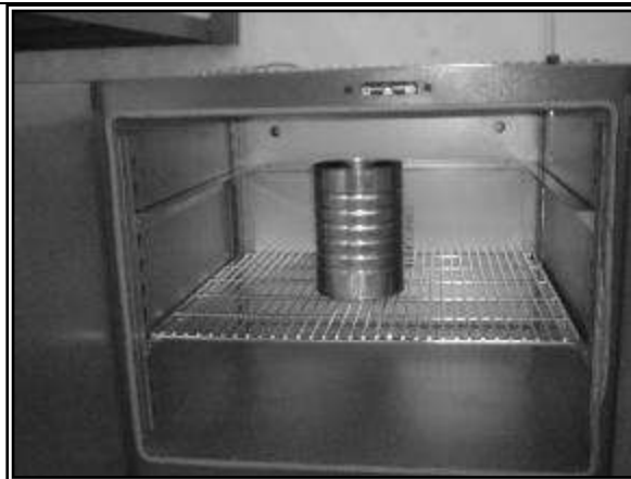
Las muestras del AC-20 convencional, se calentaron en un horno eléctrico, para poder ser modificado mediante la adición del porcentaje requerido de polímero.
