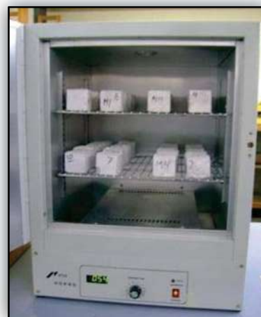
Figura 16.- Secado a 60^\circ\text{C} .
