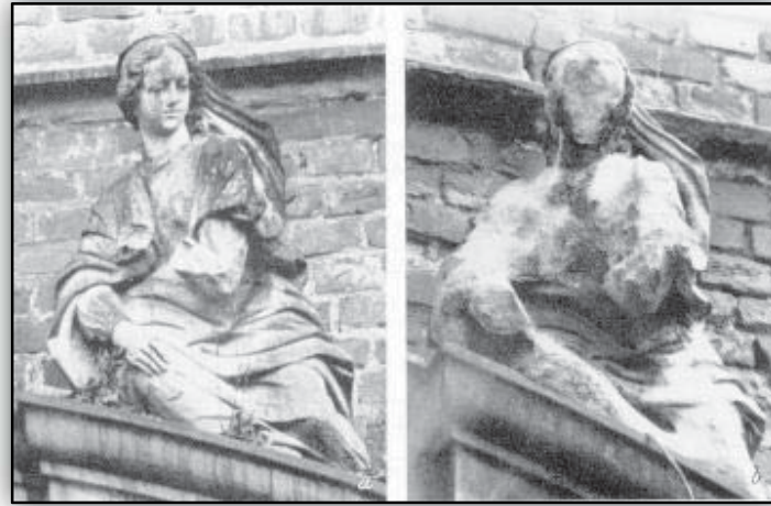
Figura 4.- Deterioro acelerado en ambientes contaminados. Escultura de arenisca del Castillo de Herten, Recklinghausen, localizado en la cuenca del Rhin (Alemania) y construido en 1702. Aspecto del motivo en 1908, mostrando deterioro moderado, y en 1969, Prácticamente destruido [Winkler, 1997].
