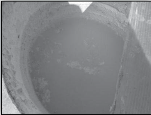
Figura 1.- Cal apagándose en recipiente metálico.
