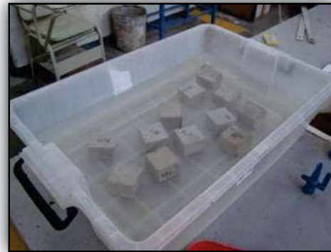
Figura 23.- Proceso de enfriamiento, sumergidos en agua con temperatura a 100°C.
