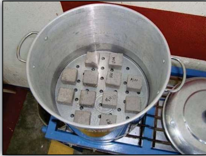
Figura 21.- Especímenes en proceso de saturación total, sometidos a un proceso de hervido en agua.
