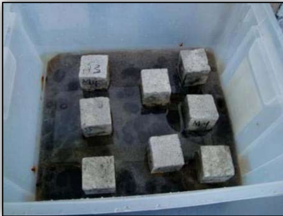
Figura 17.- Probetas sobre esponja húmeda con tirante de 3mm.
