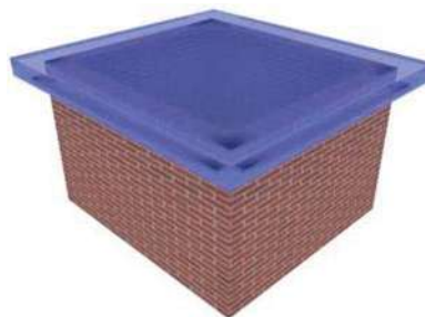
LOSA EN DOS DIRECCIONES
