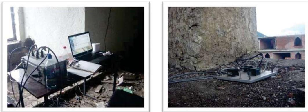
*Figura 5.2. Equipo de medición empleado durante la prueba de vibración.*
