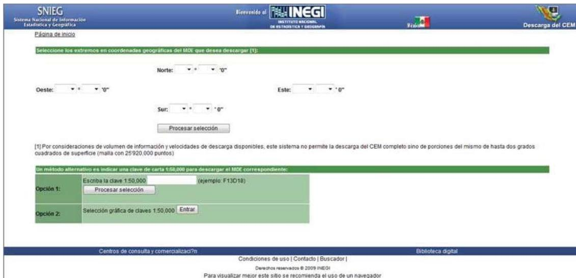
Figura 5.4, Muestra la ventana de INEGI, en la cual podemos hacer descargas por medio de coordenadas geográficas o con la clave del MDE que deseamos bajar.
