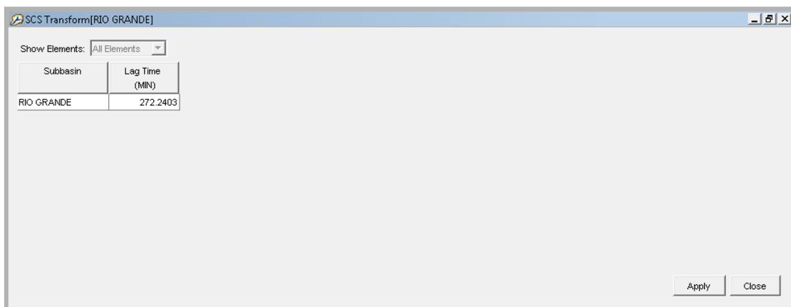
Figura 5.241, Muestra la manera de colocar el tiempo de concentración en minutos.
