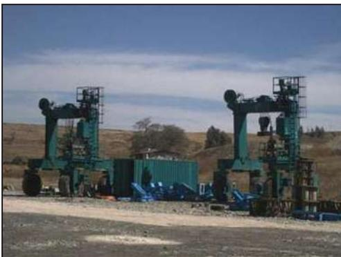
El izaje se realiza por medio de 2 equipos de maquinaria pesada: en esta figura se muestran pórticos neumáticos, con capacidad de izaje de 50 toneladas efectivas cada uno.
