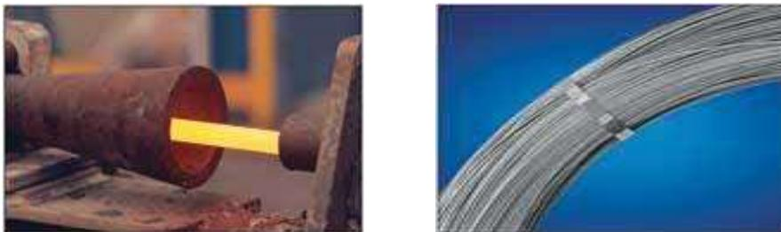
Fig. 1.39.- Alambre de presfuerzo [12].
