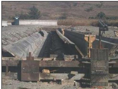
Se observan 2 camas de presfuerzo que contienen plataformas para las bases y cabezales en los extremos para anclar los torones una vez que se hayan tensado, se emplean para fabricar las vigas tipo IV. Se fabrican 2 traveses por cada cama.
