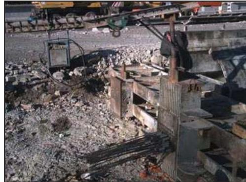
Se observa los cabezales de las camas de pretensado, en los cuales se fijan los torones después del tensado por medio de cilindros y cuñas o mordazas. También se observa una polea para levantar el gato de tensado, así como la unidad de bombeo que le proporciona la presión.
