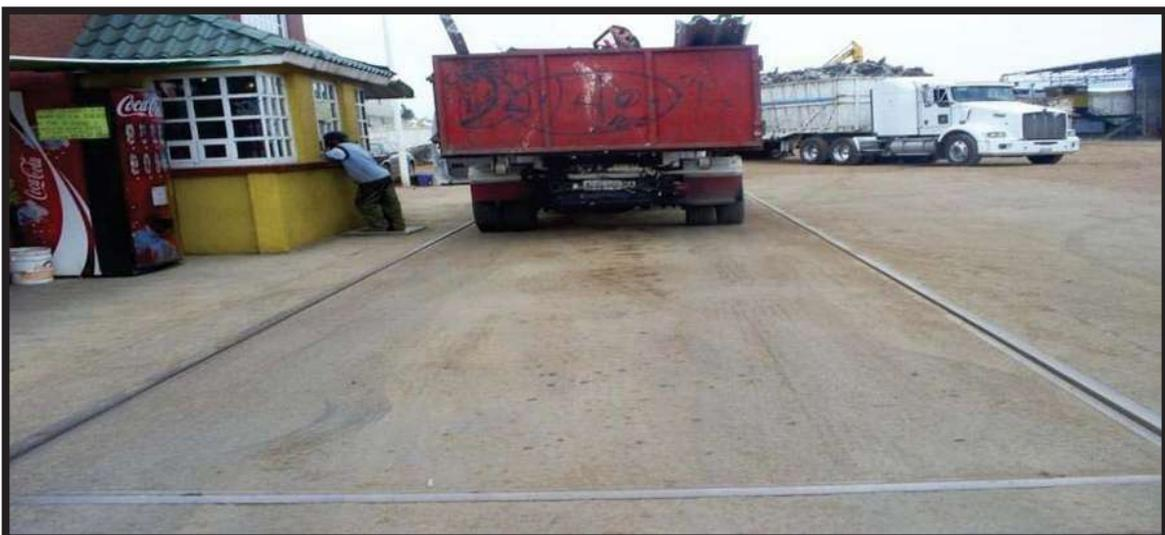
Figura 6.13. Báscula eléctrica y mecánica con capacidad 120 ton.
