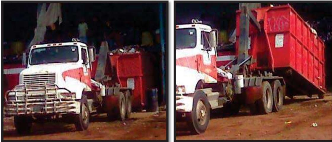
Figuras 6.22. Proceso de carga de un camión jalador
