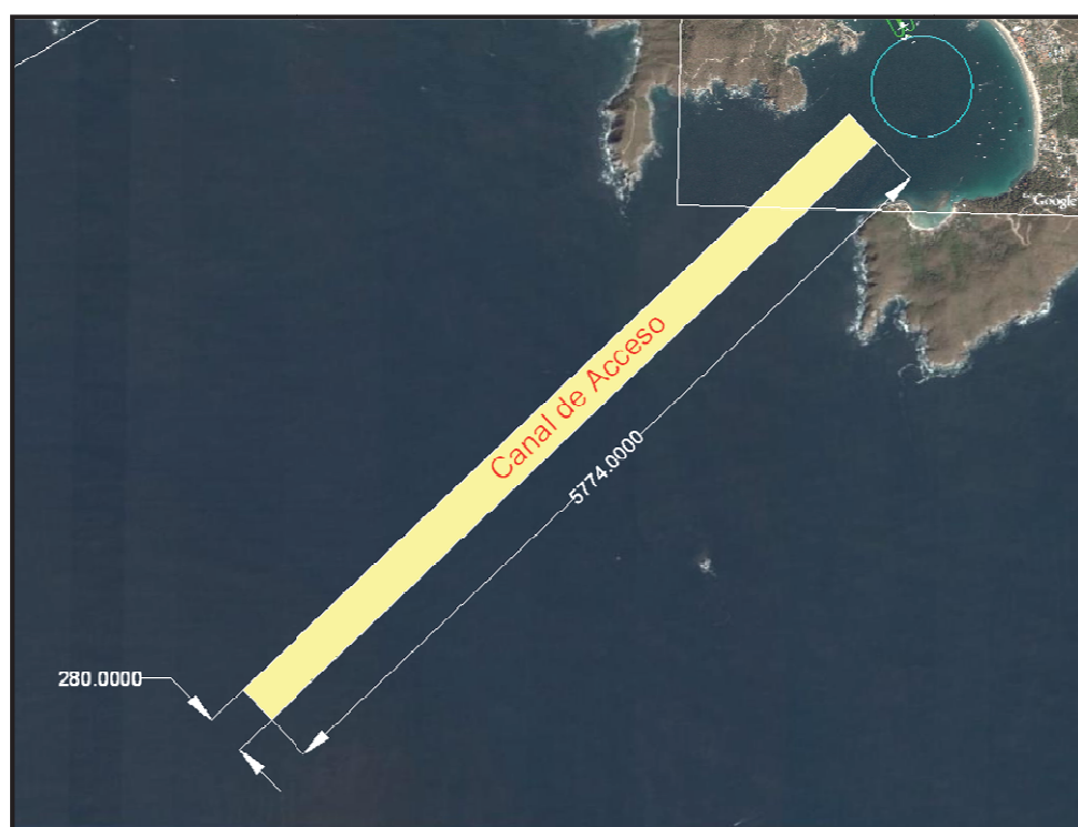
Figura XI.2.1.1 Dimensionamiento del Canal de Acceso.
