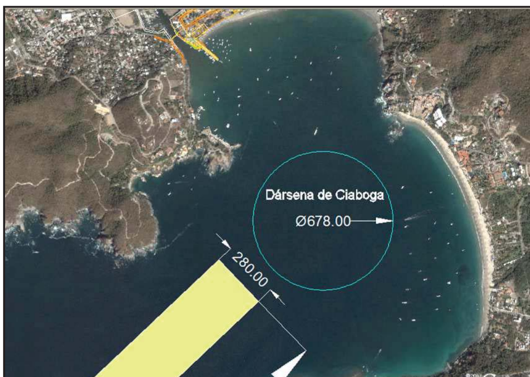
Figura XI.2.1.2 Dimensionamiento de la Dársena de Ciaboga.
