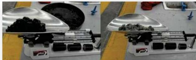
Fig. 4.3 Humedad de absorción en gravas.
