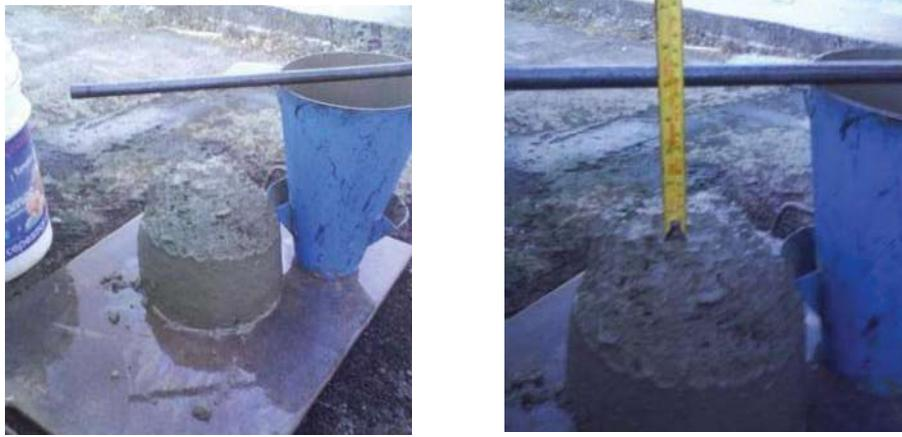
**Fig.6.3 Verificación del revenimiento**
