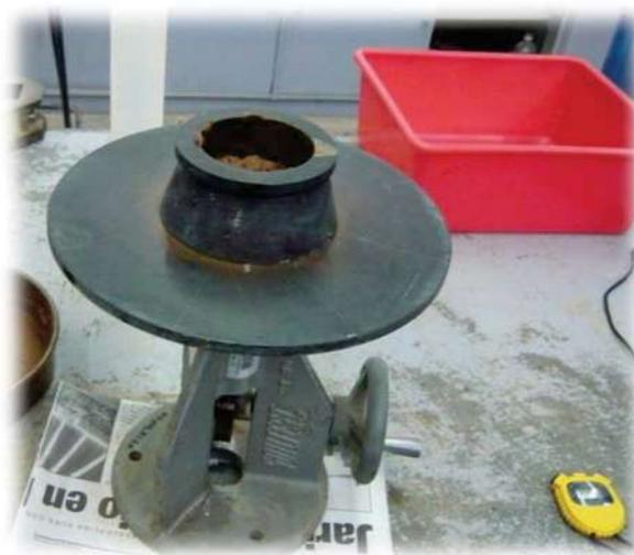
Figura 20. Mesa para la prueba de fluidez.
