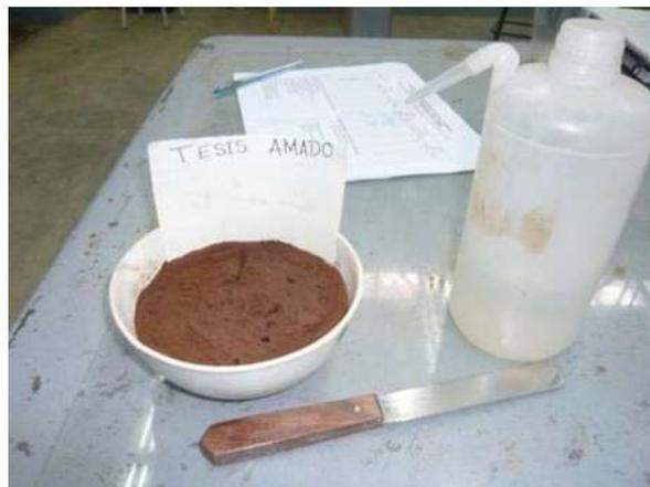
Figura 11. Muestra saturada.
