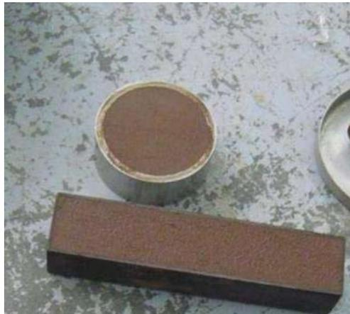
*Figura. 16. Cápsulas de contracción.*
