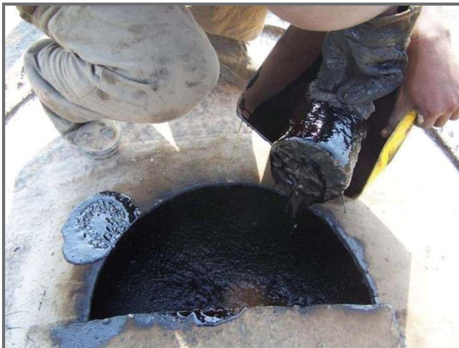
Figura 4.3 Extracción del cemento asfáltico que se utilizó para la elaboración de pastillas
