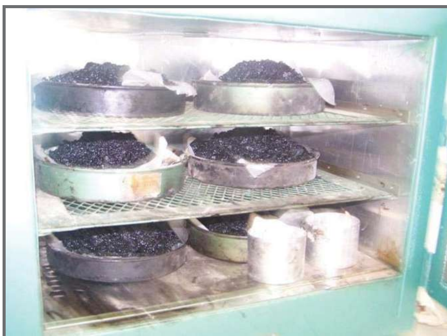
Figura 7.1 Mezcla en el horno lista para iniciar con la temperatura de compactación
