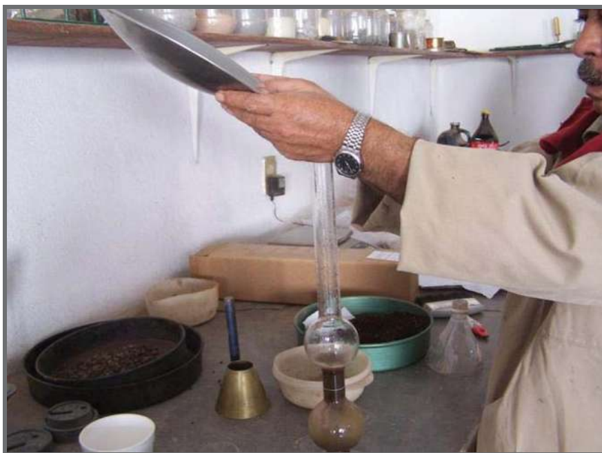
Figura 5.2 Prueba de densidad del material tezontle
