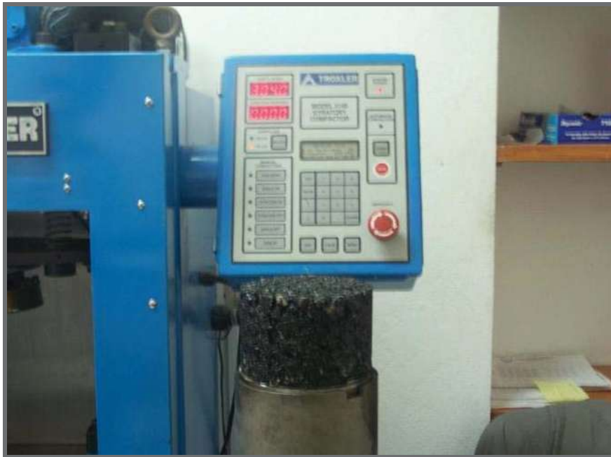
Figura 7.2 Pastilla de material triturado después de la compactación
