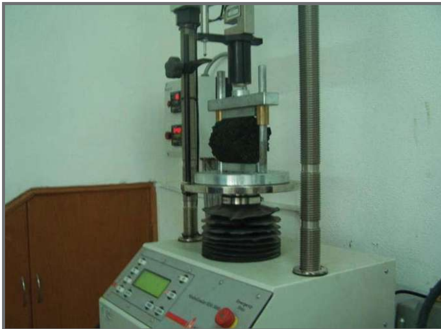
Figura 7.7 Configuración de carga de una pastilla en la Mordaza Lottman
