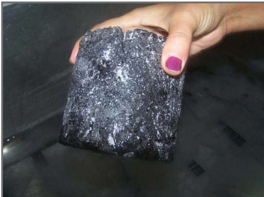
Figura 7.5 Pastilla congelada antes de entrar al baño de agua tibia que durará 24 hrs.
