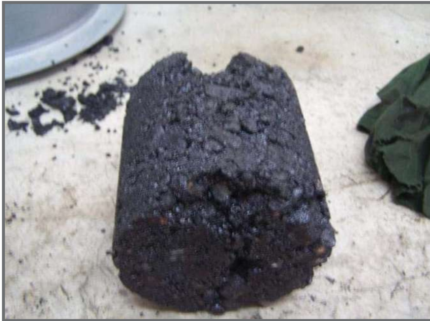
Figura 7.8 Pastilla después de ser probada y sometida a carga hasta observar agrietamiento
