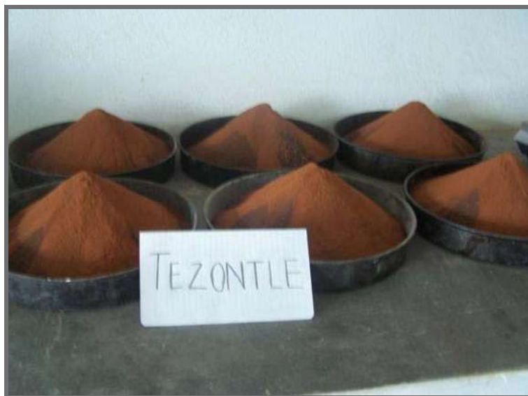
Figura 6.2 Charolas con los porcentajes de material pétreo correspondientes para elaborar las pastillas de material tezontle
