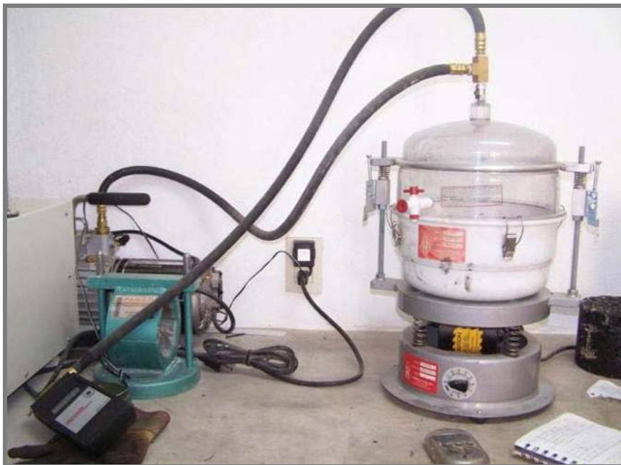
Figura 6.4 Recipiente de vacío armado y encendido durante la realización de la prueba de densidad rice
