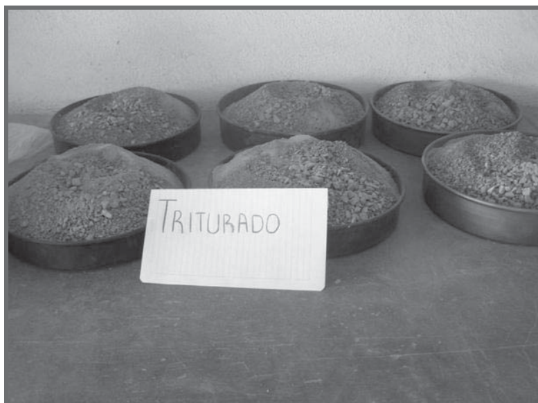
Figura 6.1 Charolas con los porcentajes de material pétreo correspondientes para elaborar las pastillas de material triturado
