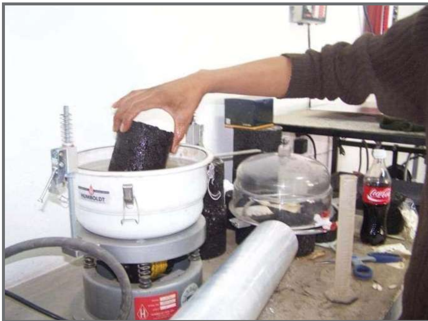
Figura 7.3 Pastilla de material triturado saliendo del recipiente de vacío, para darles el grado de saturación requerido
