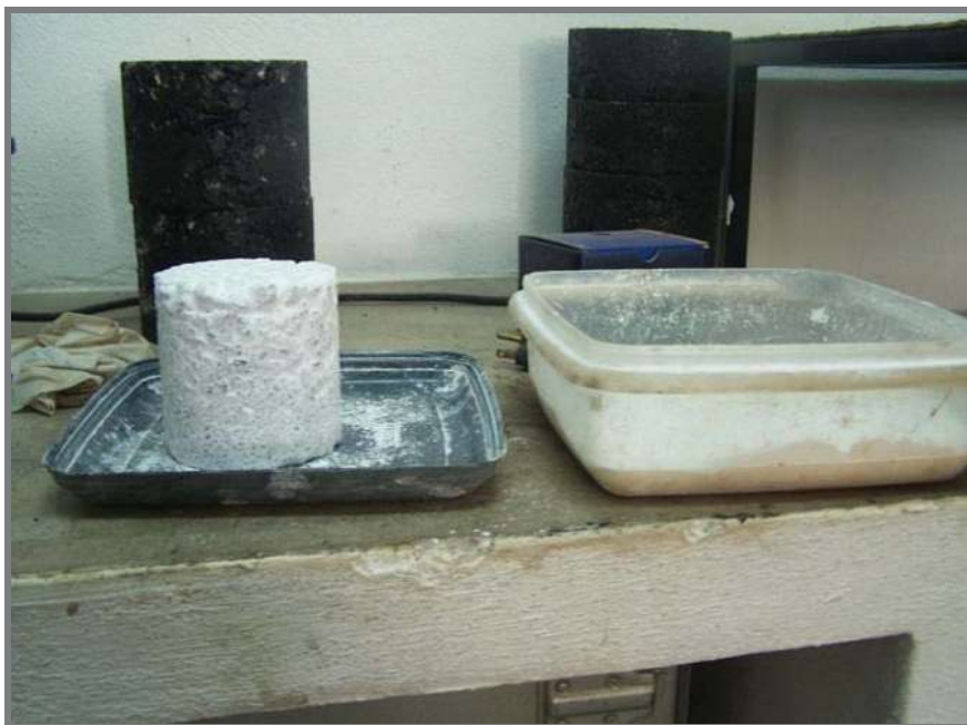
Figura 6.7 Pastilla de material tezontle cubierta con estearato de zinc por su gran contenido de absorción
