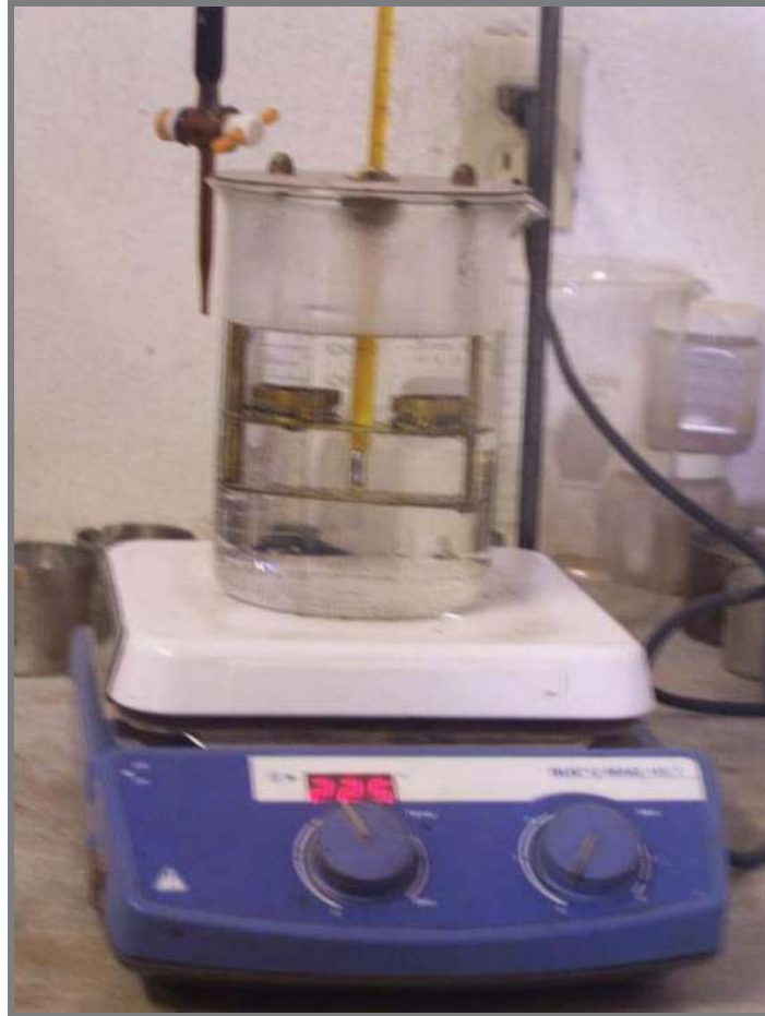
Figura 5.6 Prueba de punto de reblandecimiento del asfalto
