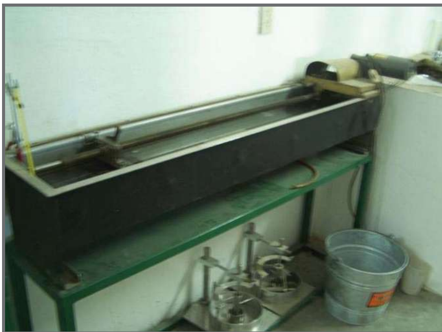
Figura 5.5 Prueba de ductilidad al asfalto
