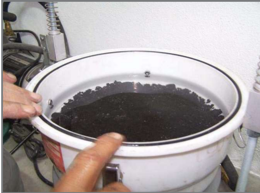
Figura 6.3 Colocación del material pétreo en el recipiente de vacío durante la prueba de densidad rice
