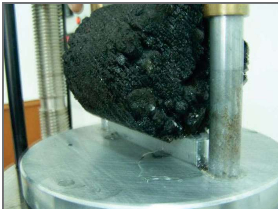
Figura 2.10 Ensayo de especímenes a tensión indirecta
