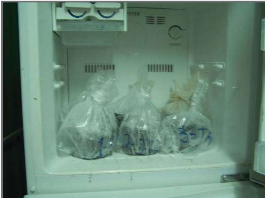
Figura 7.4 Pastillas en bolsas de plástico durante el proceso de congelamiento las cuales permanecerán hay por un periodo de 16 horas mínimo
