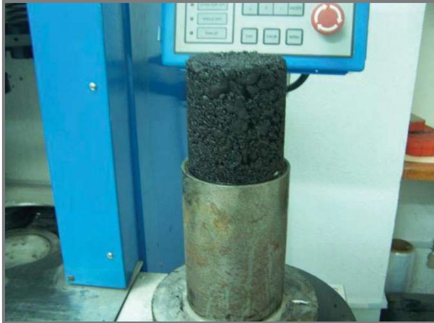
Figura 6.6 Pastilla para volumetria de material tezontle saliendo del compactador giratorio, donde se observa que tiene un gran número de vacíos debido a la segregación del material
