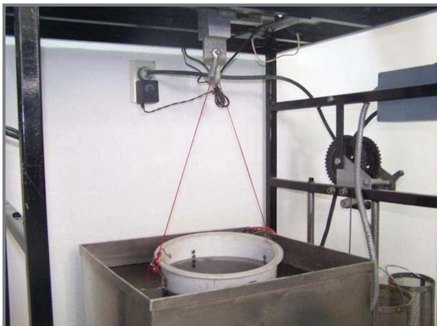
Figura 6.5 Obtención del peso del material sumergido en agua para la prueba de densidad rice
