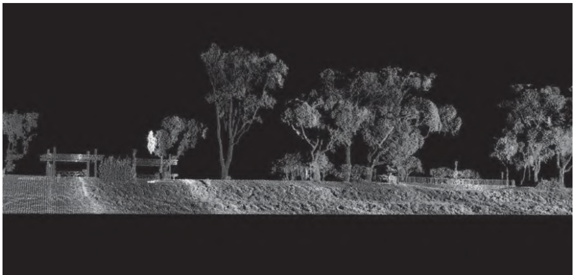
Figura 6-12. Sondeo Topográfico con Escáner LiDAR en Perfil
