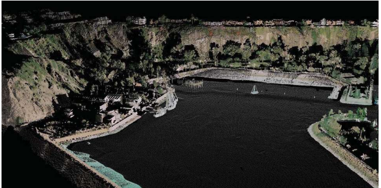
Figura 4-1. Información Topográfica obtenida con Escáner LiDAR Optech ILRIS 3D.
