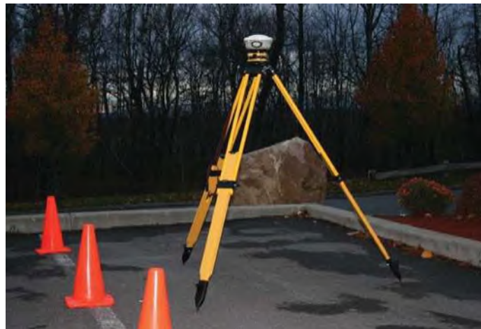
Figura 5-2. Estación Base RTK-GNSS – Trimble R-8
