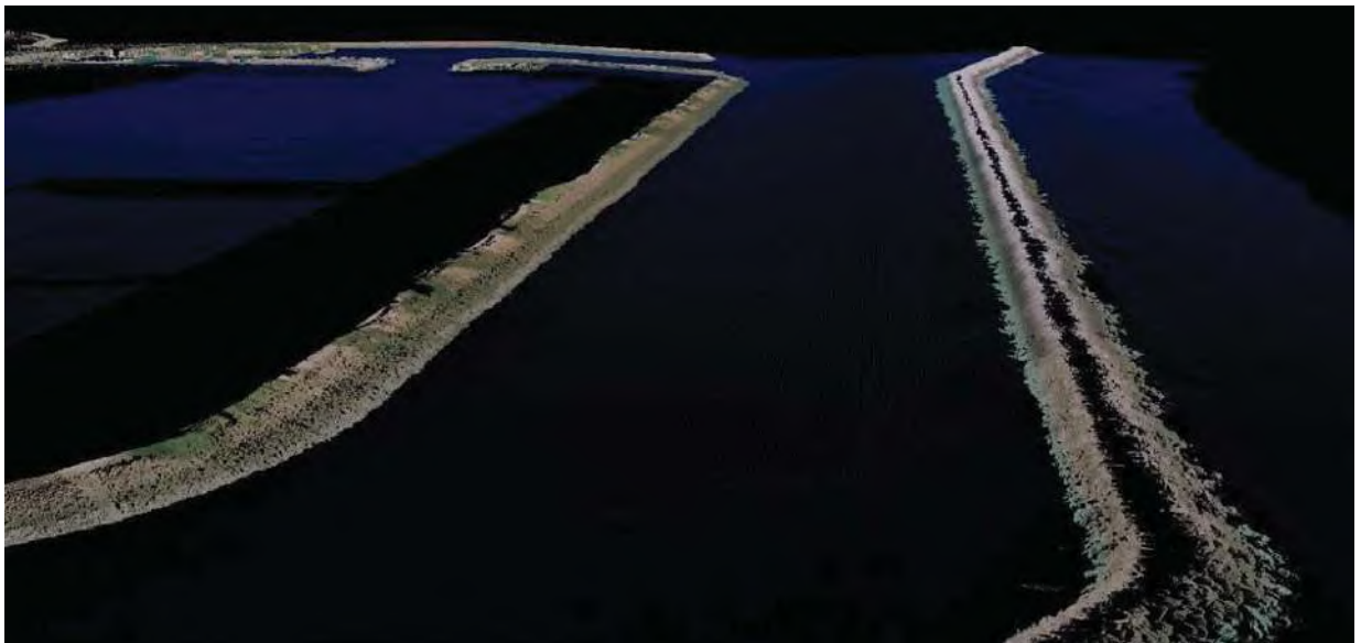
Figura 7-4. Nube de Puntos con Clasificados como Suelo
