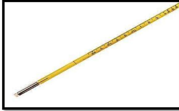
Figura III.31. Termómetro empleado para medir la temperatura del agua y del concreto.
