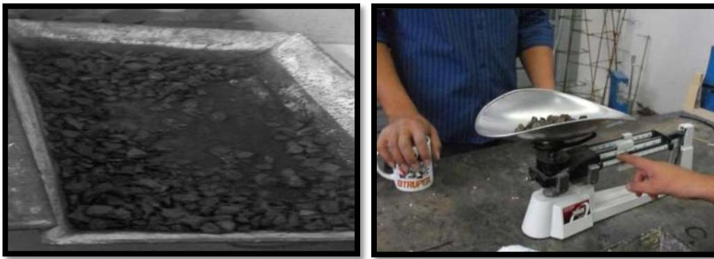
Figura III.18. Determinación de % de absorción en gravas.
