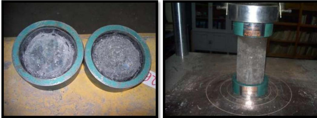
Figura III.41. Placas de neopreno usadas para el cabeceado de cilindros.
