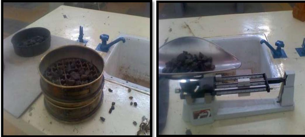
Figura III.23. Determinación de la granulometría de la gravas.
