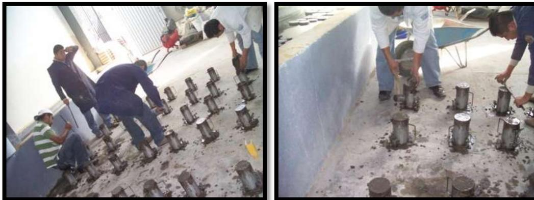
Figura III.34. Fabricación de cilindros de concreto.
