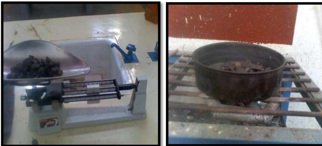
Figura III.17. Determinación de % de humedad actual en gravas.
