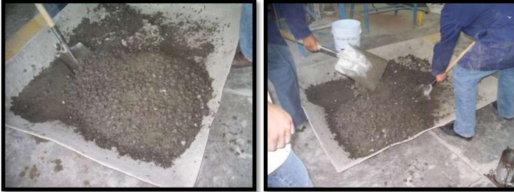
Figura III.32. Muestreo del concreto.
