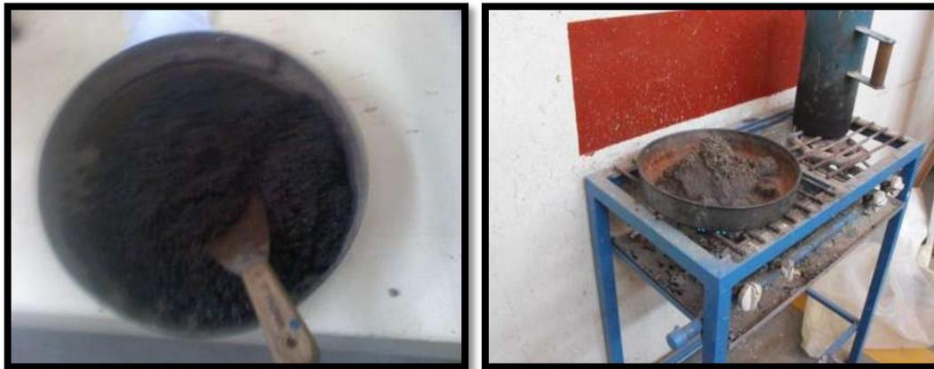
Figura III.3. Determinación del % de humedad actual en arena.
