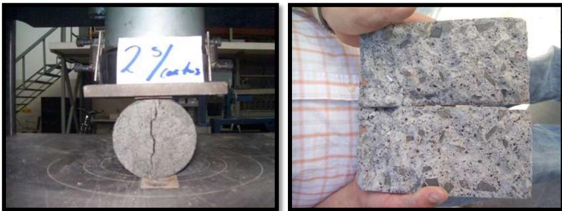
Figura III.43. Tensión indirecta en cilindros.
