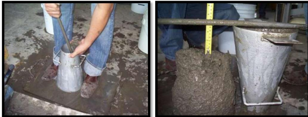
Figura III.33. Revenimiento del concreto.
