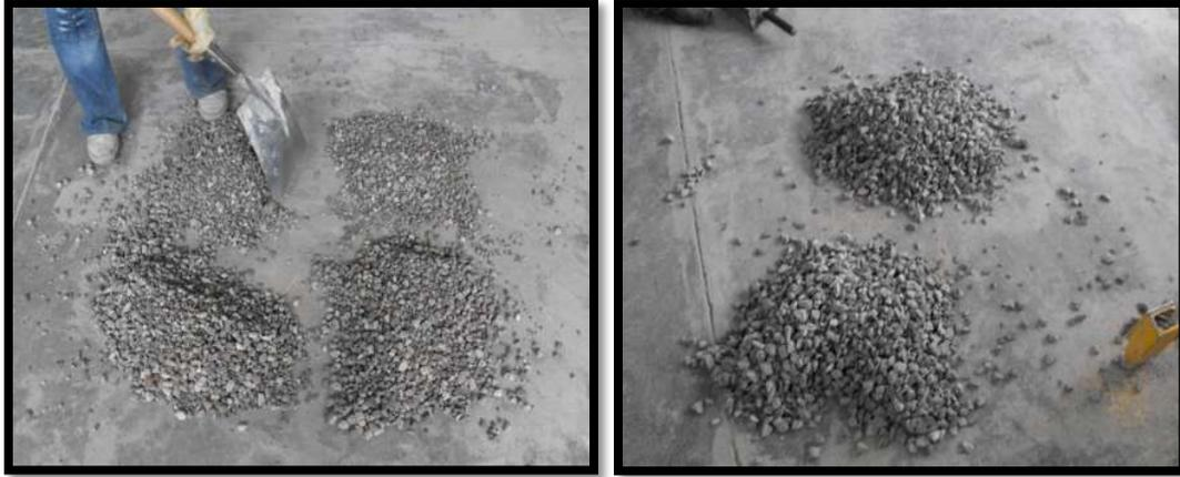
Figura III.16. Cuarteo en gravas por medio de palas.
