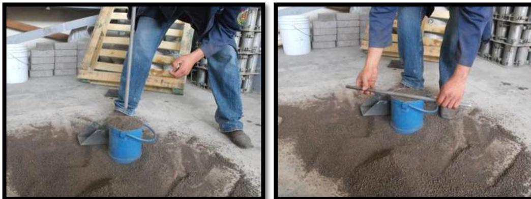
Figura III.7. Determinación de PVSV del arena.
