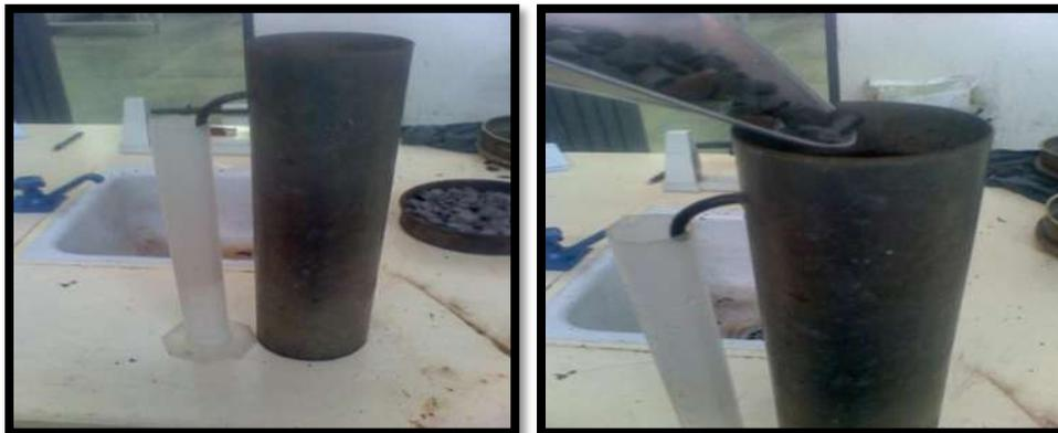
Figura III.19. Determinación de densidad en gravas.
