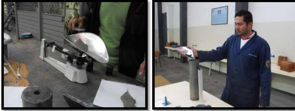
Figura III.5. Determinación de la densidad del arena.
