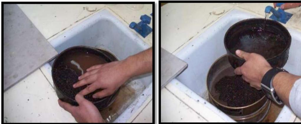
Figura III.13. Determinación de % de terrones de arcilla.
