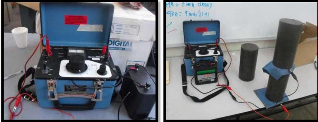
Figura III.37. Equipo usado para la Resistividad.
