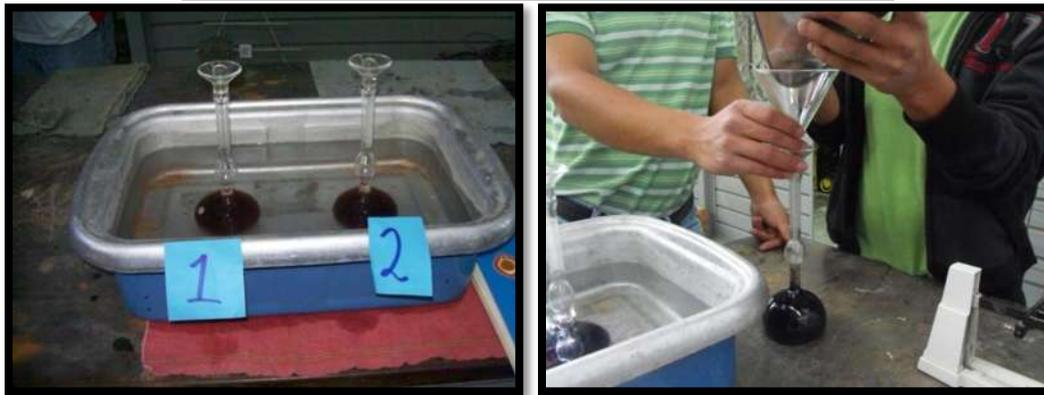
Figura III.27. Densidad del cemento.
