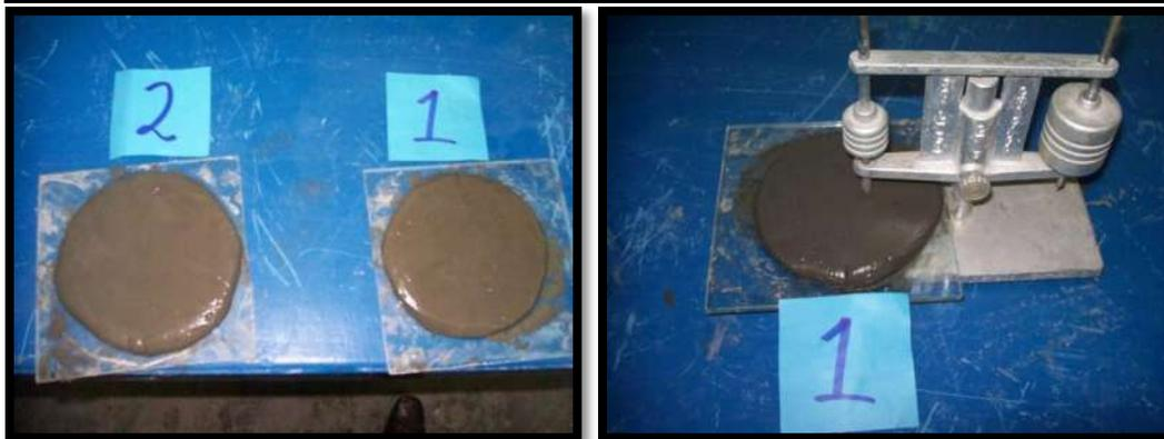
Figura III.26. Tiempo de fraguado del cemento.
