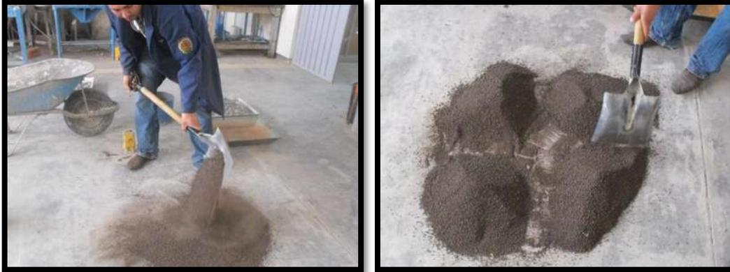
Figura III.2. Cuarteo del arena por medio de palas.
