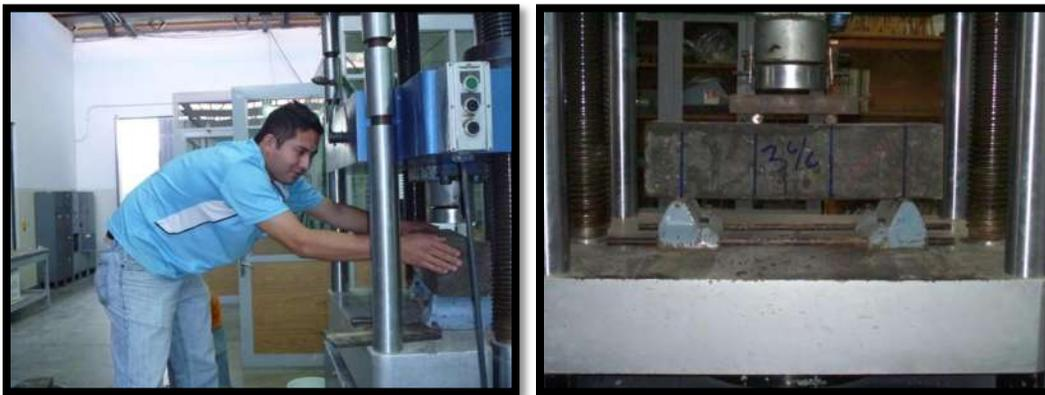
Figura III.44. Flexión en vigas.
