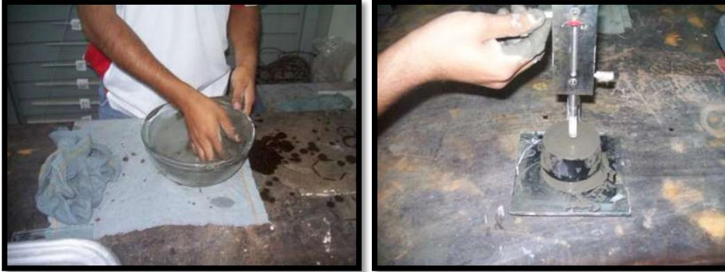
Figura III.25. Consistencia normal del cemento.
