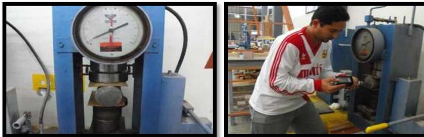
Figura III.40. Esclerómetro usado en las pruebas.
