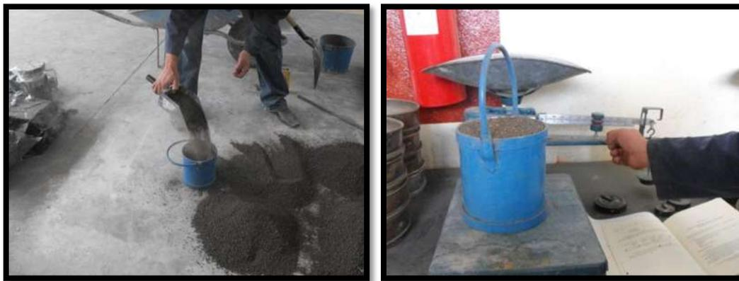
Figura III.6. Determinación de PVSS del arena.
