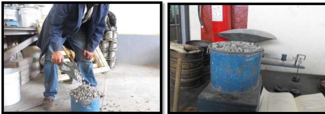
Figura III.20. Determinación PVSS en gravas.
