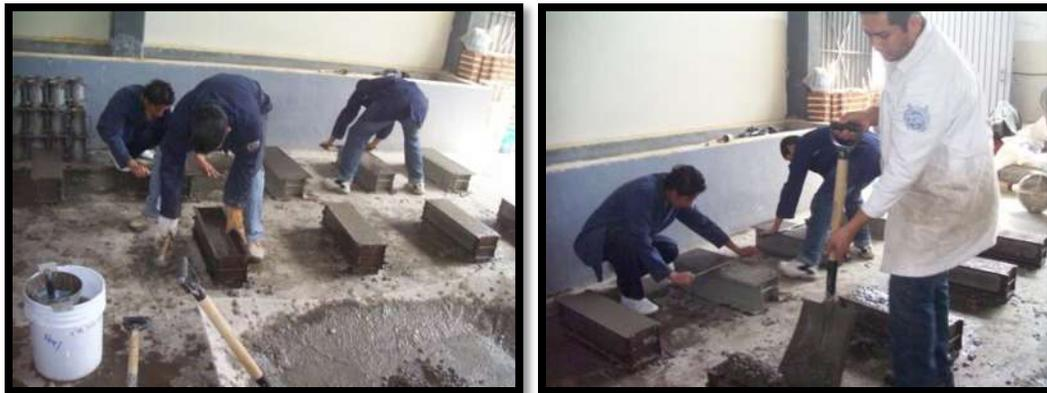
Figura III.35. Fabricación de vigas de concreto.
