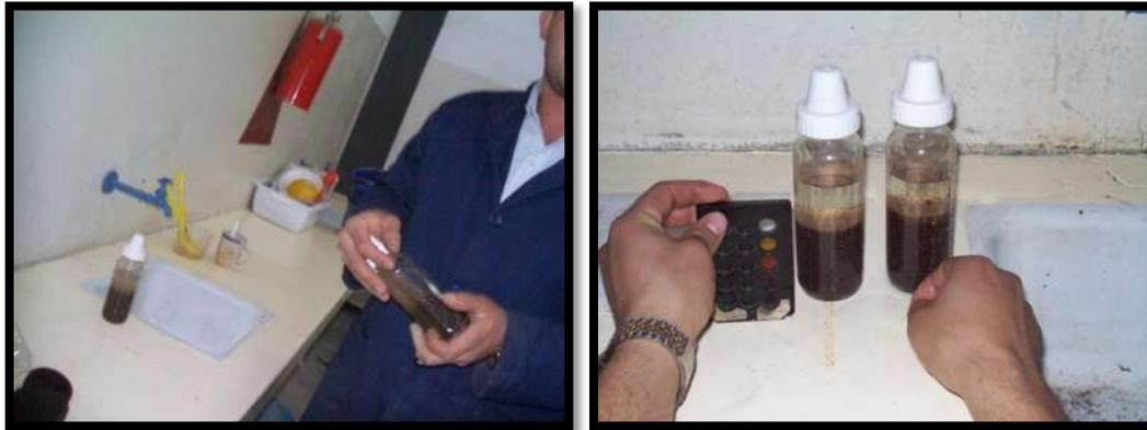
Figura III.10. Determinación de colorimetría del arena.
