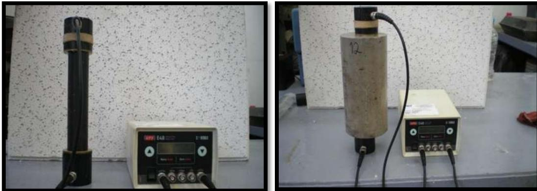
Figura III.38. Equipo de Velocidad de Pulso Ultrasónico empleado.
