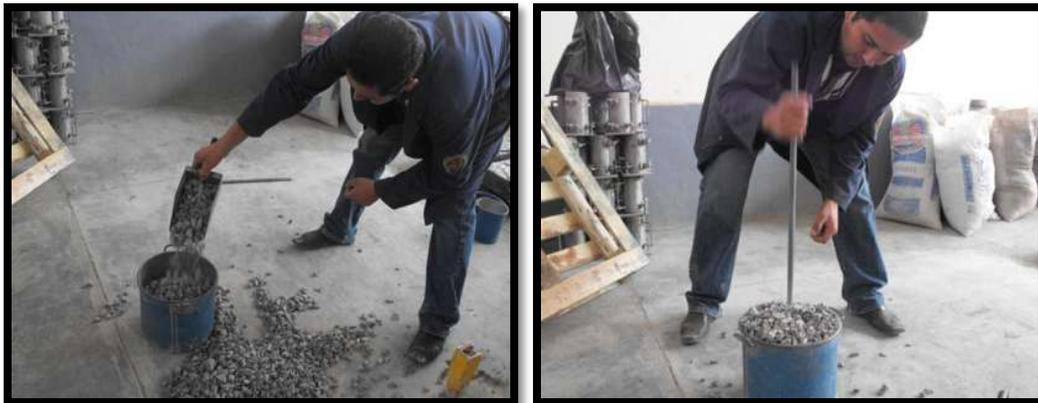
Figura III.21. Determinación PVSV en gravas.
