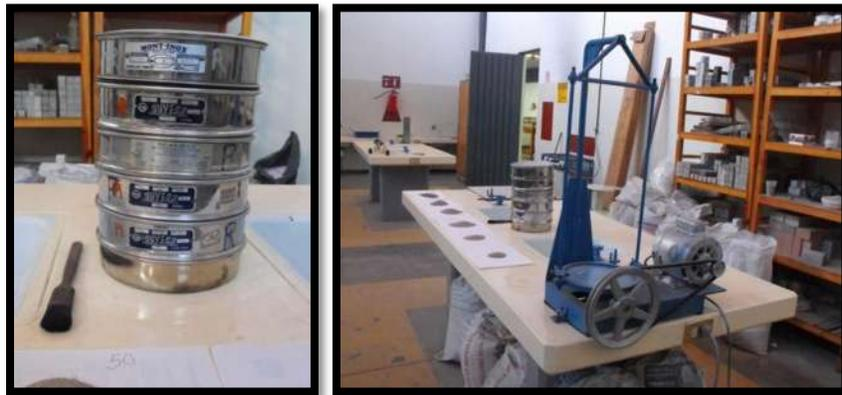
Figura III.9. Determinación de la granulometría del arena.
