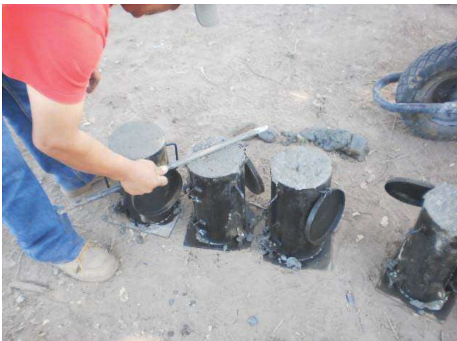
V.3.3.- Imagen 60.- Enlace de cilindros para pruebas de concreto
