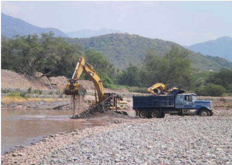
V.2.3.- Imagen 34.- Cribado en el Río Tiquicheo
