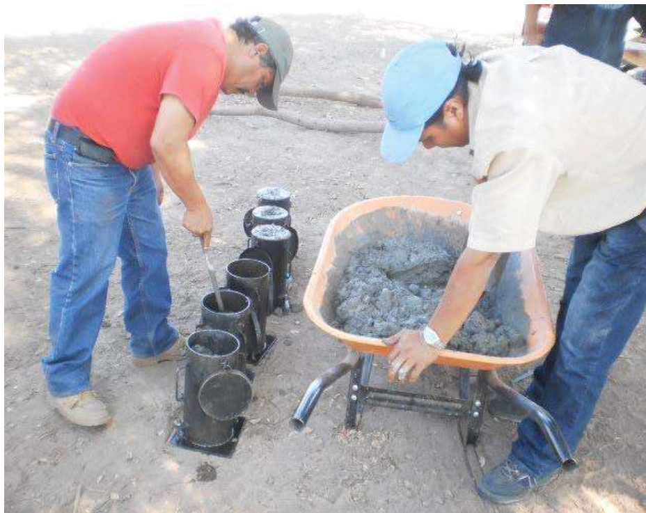
V.3.3.- Imagen 59.- Llenado de cilindros para pruebas de concreto
