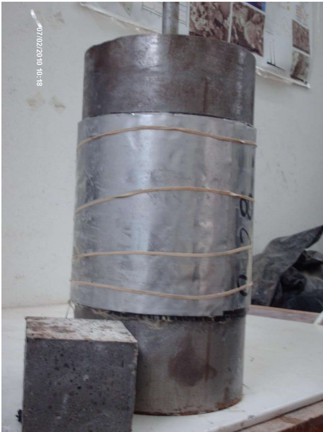
Figura 4.5.- Tubería reparada con composite tipo sándwich
