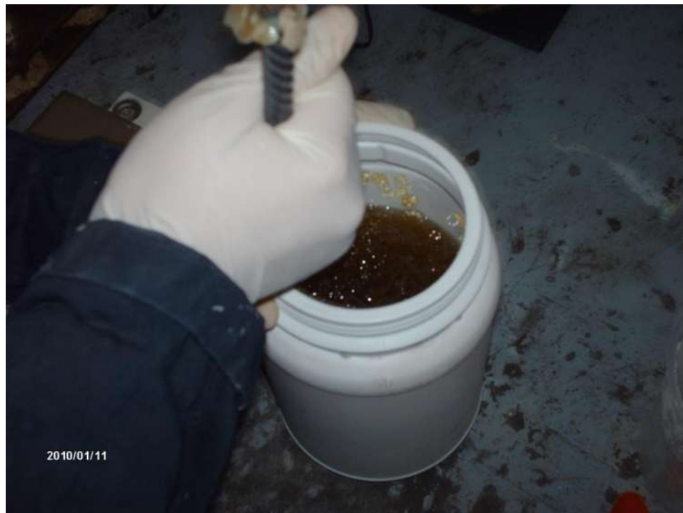
Figura 3.2- Proceso de mezclado del Polifumarato Bisfenolico y el monómero de estirenos fase 1.
