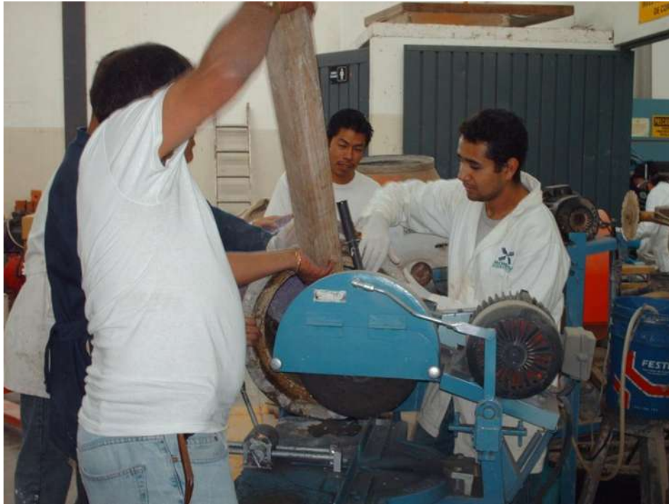
Figura 3.36- Colocación del tubo en la cortadora
