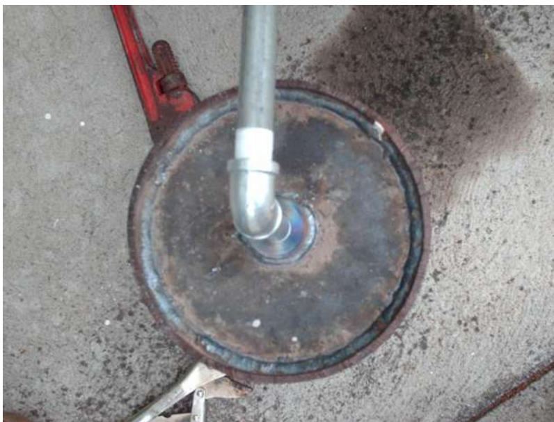
Figura 4.7.- preparación de tubería para prueba hidrostática con el primer diseño
