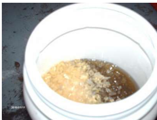
Figura 3.1- Copolímero de Polifumarato Bisfenolico-monómero de estírenos antes de empezar a mezclar para lograr la viscosidad deseada.
