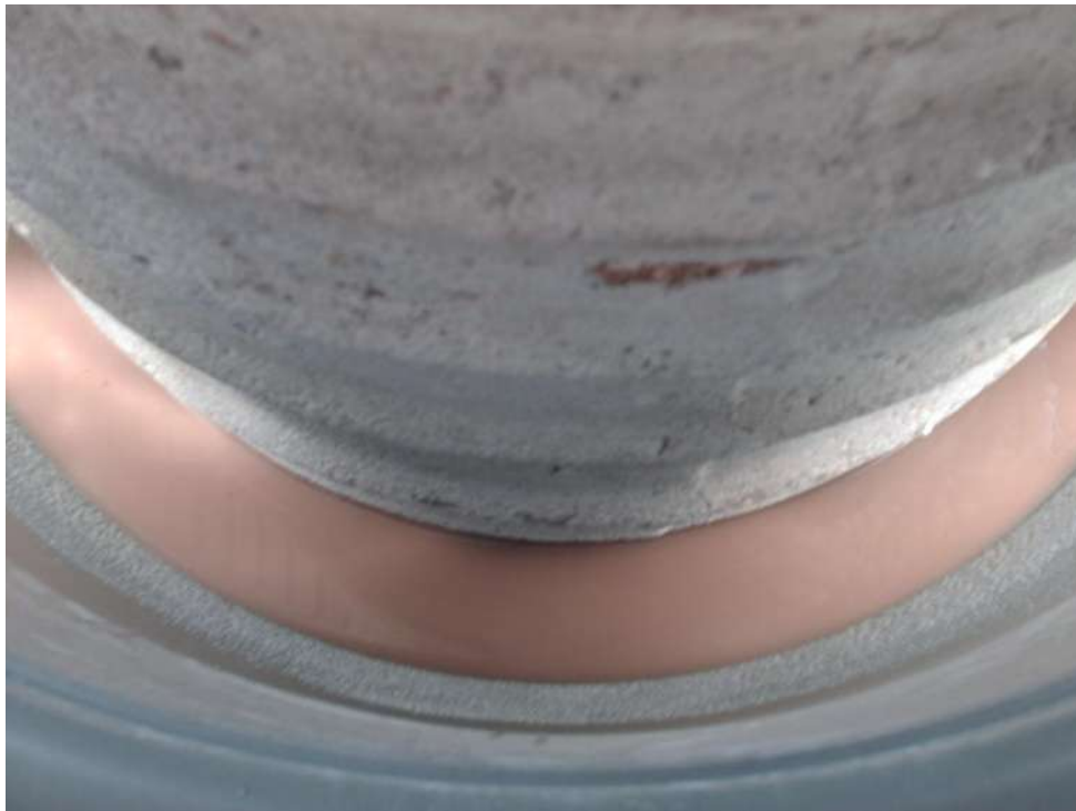
Figura 3.26- Sello en la parte del fondo del tubo y la cubeta, para que no se tire el agua (1)
