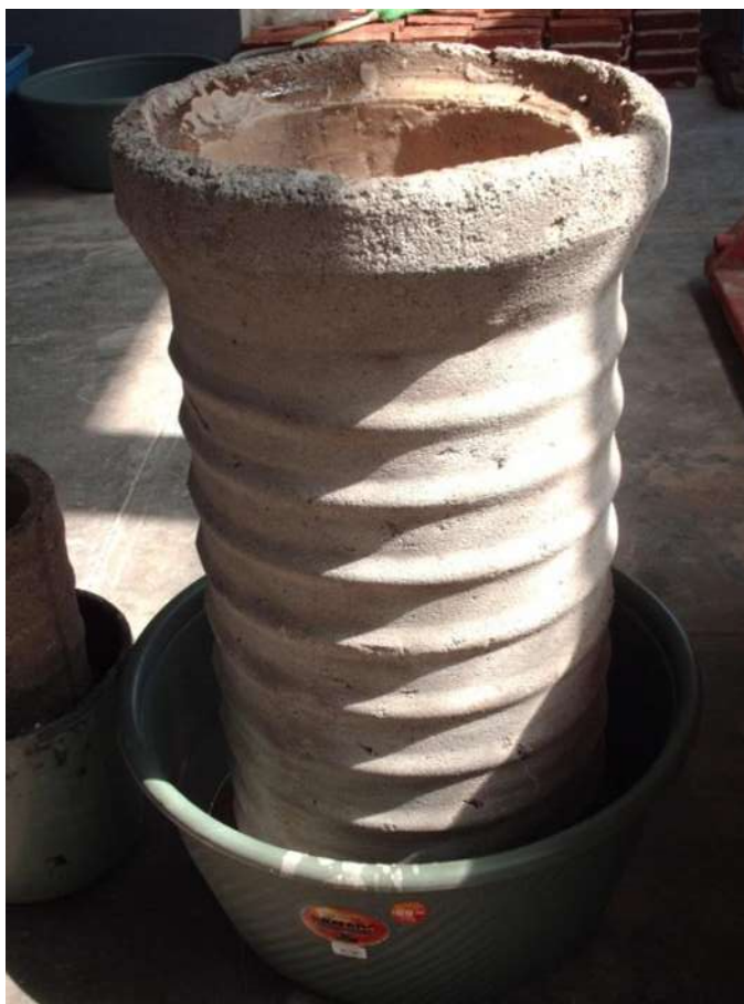
Figura 3.23- Tubería con agua en el interior, visto por fuera, demostrando que no existe percolación de agua en los costados.
