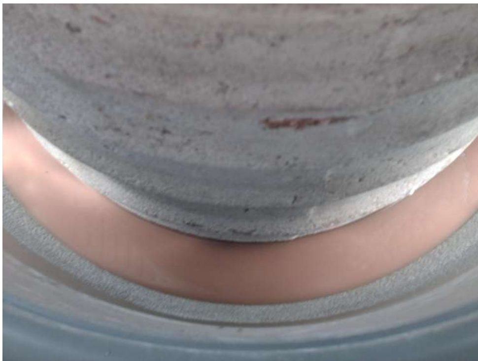
Figura 3.27- Sello en la parte del fondo del tubo y la cubeta, para que no se tire el agua (2)
