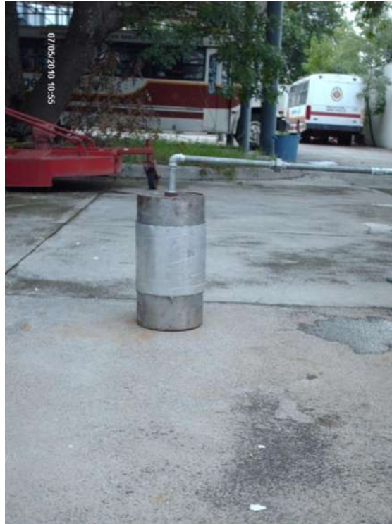
Figura 4.9.- Instalación de tubería reparada con composite tipo sándwich para prueba hidrostática
