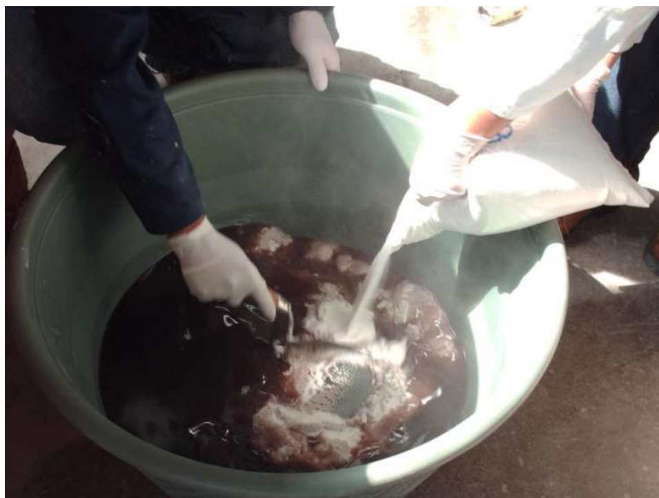
Figura 3.8- Mezcla del Polifumarato Bisfenolico y la marmolina antes de su polimerización (agregando la marmolina).
