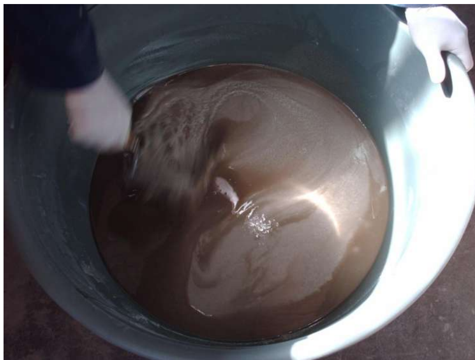
Figura 3.9- Mezcla del Polifumarato Bisfenolico y la marmolina antes de su polimerización.
