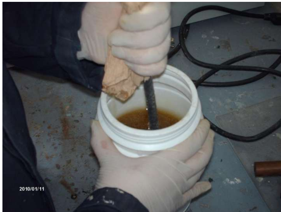
Figura 3.4- Proceso de mezclado del Polifumarato Bisfenolico y el monómero de estirenos fase 2.
