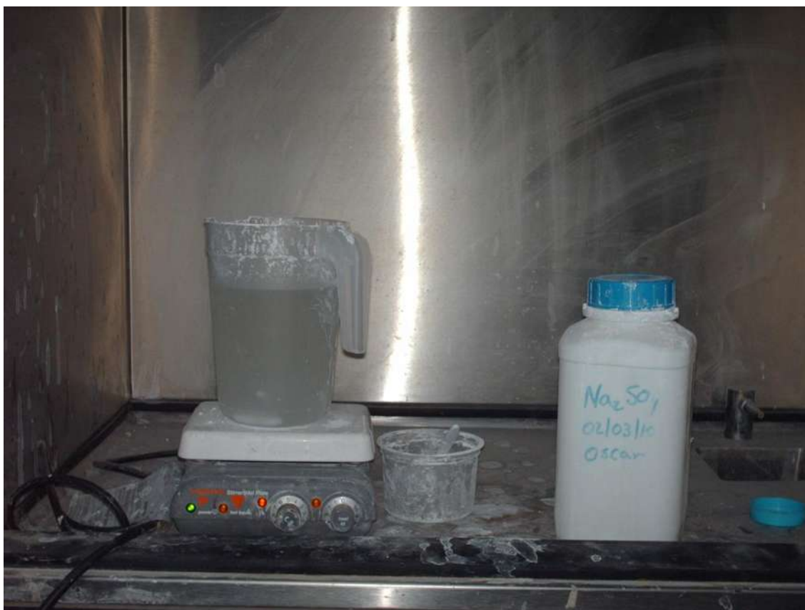
Figura 3.34.- Preparación de la solución química para la evaluación de la durabilidad.
