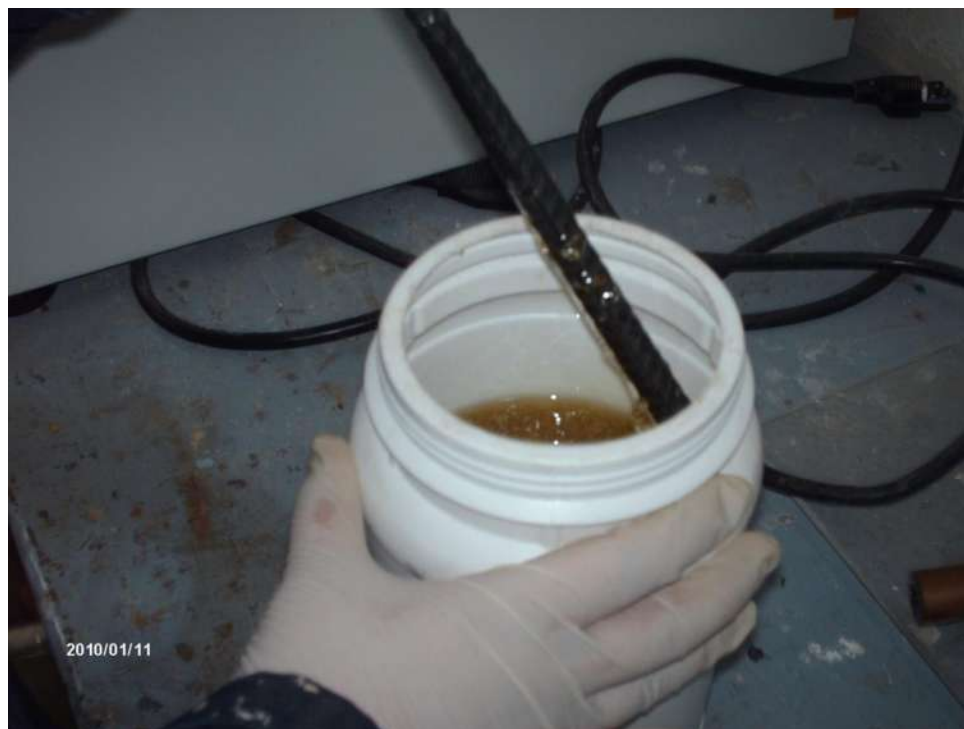
Figura 3.5- Proceso de mezclado del Polifumarato Bisfenolico y el monómero de estirenos fase 3 (estado líquido viscoso, para poder trabajar con este componente).
