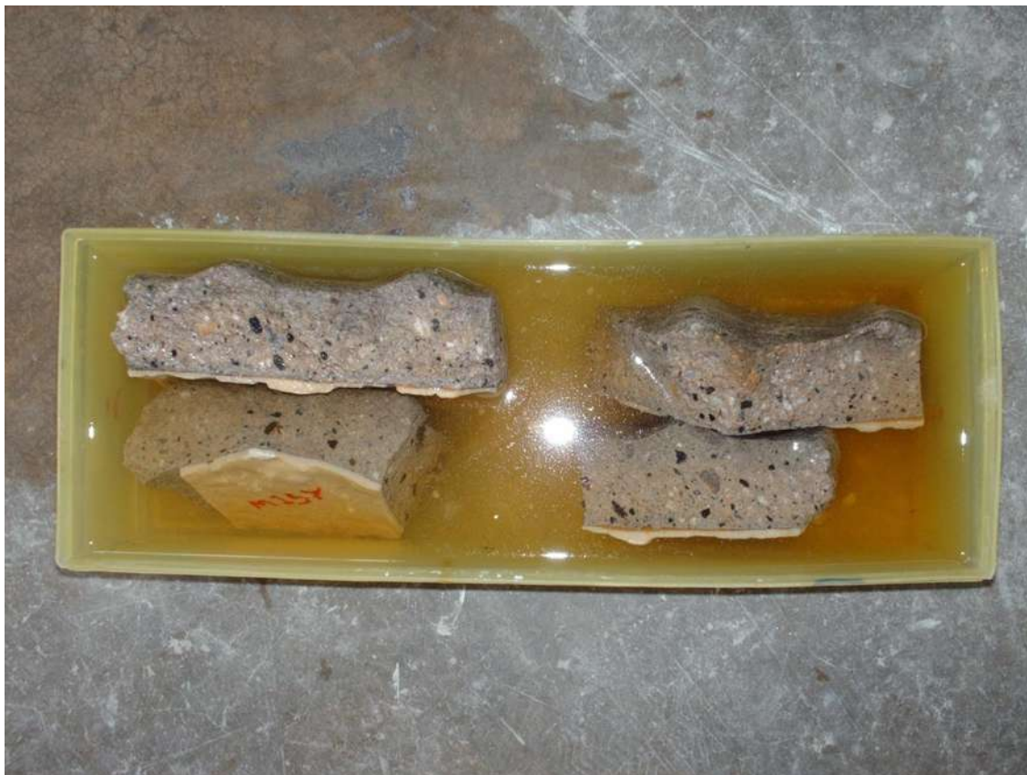
Figura 3.35.- Fragmentos del tubo-composite en proceso de prueba (ataque químico)
