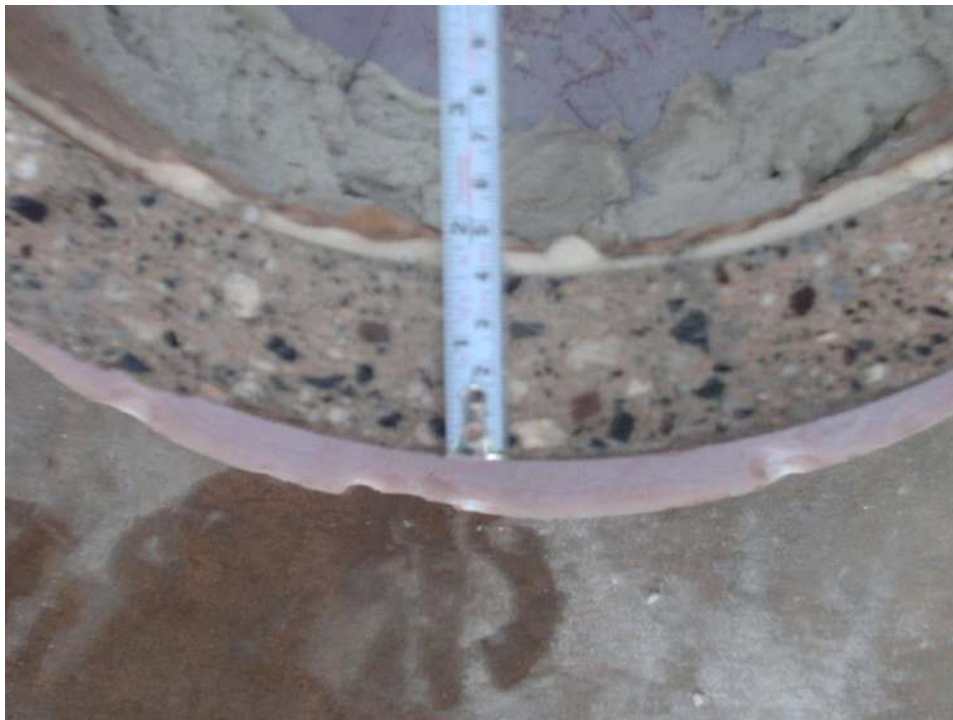
Figura 3.41- Parte del fondo o tapón del tubo midiendo el espesor del tubo
