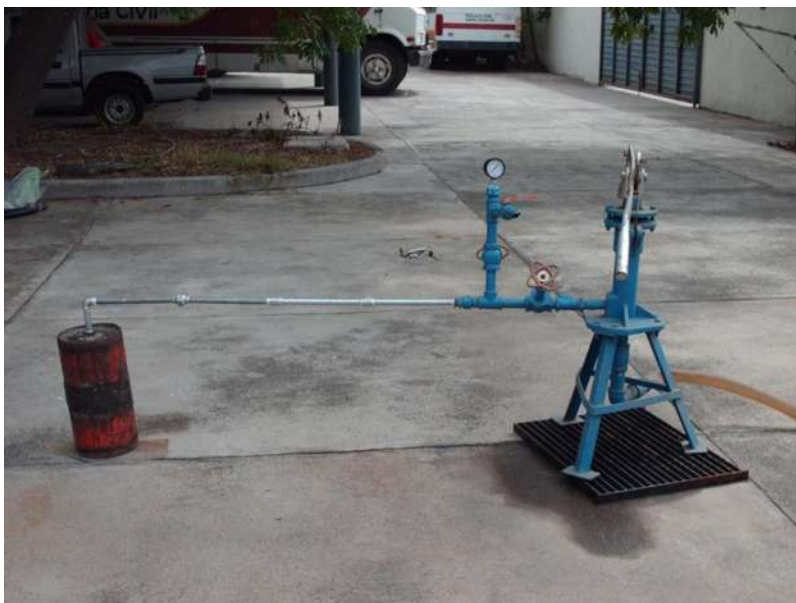
Figura 4.7.- preparación de tubería para prueba hidrostática con el primer diseño
