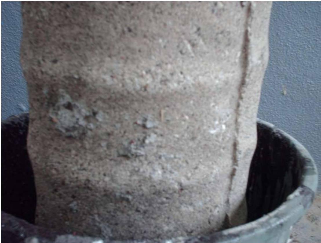
Figura 3.33- Tubería de concreto sin composite
