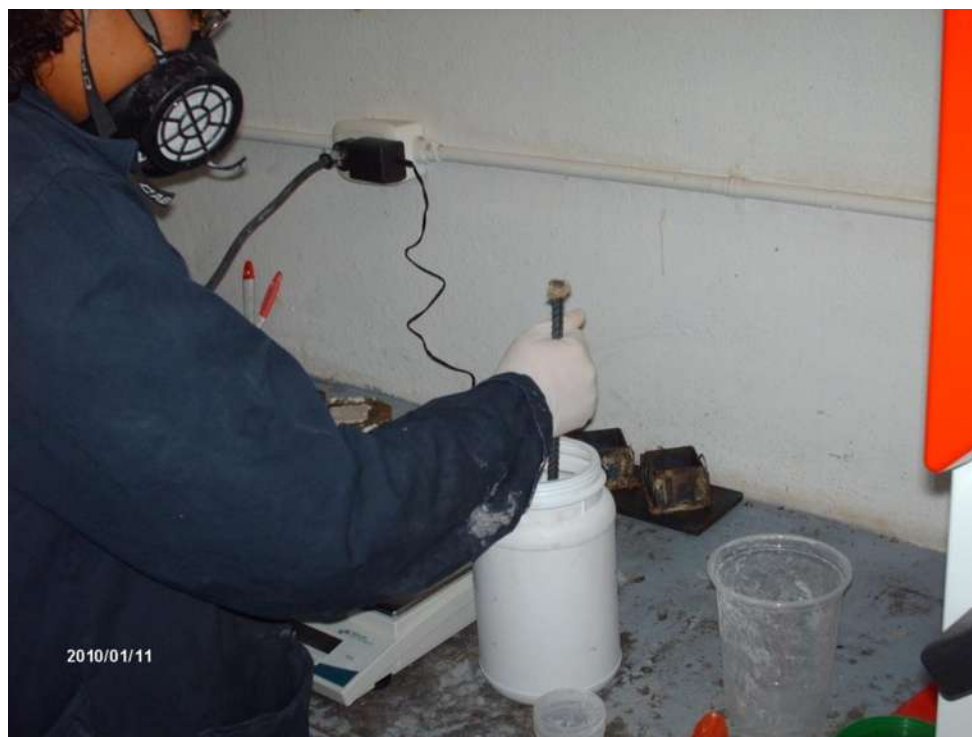
Figura 3.3- Proceso de mezclado del copolímero donde se muestra el área de trabajo.
