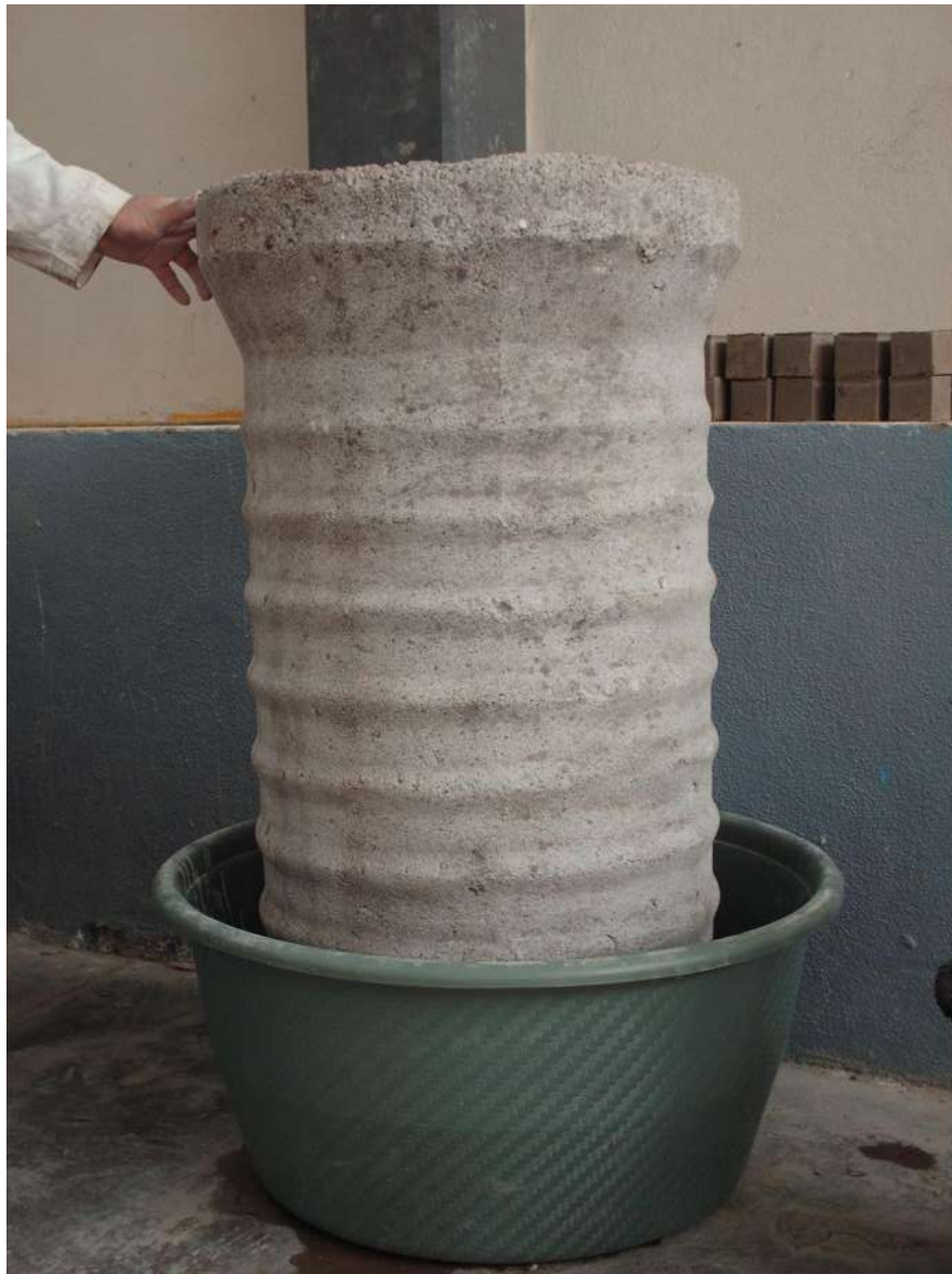
Figura 3.30- Tubo sin percolación de agua en los costados (agua en el interior del tubo)
