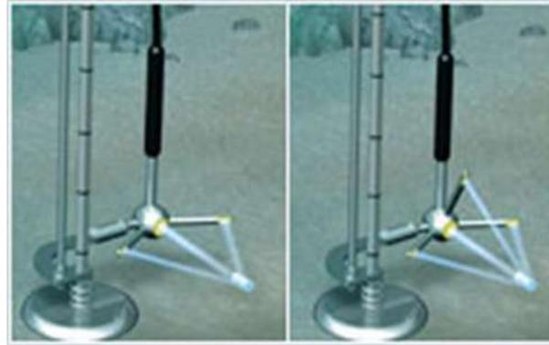
**Figura 3.8.b** Sensores del Flow Tracker para medir velocidad en 2D o velocidad en 3D respectivamente.
