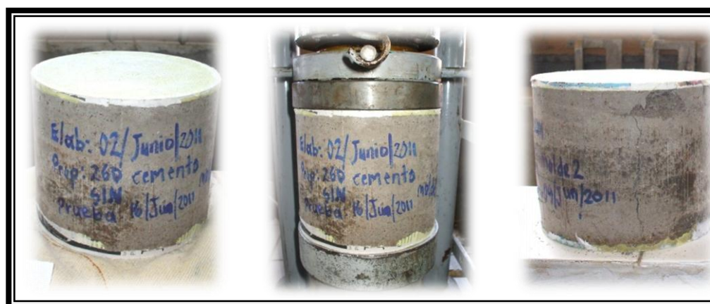
Figura 3.8.20 Antes, durante y después de la prueba a compresión simple (260/arcilla).
