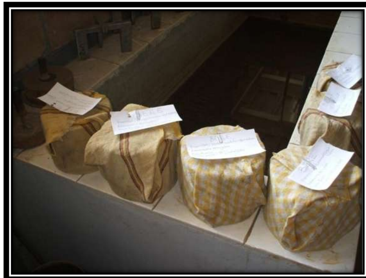
Fig. 3.7.41 Colocación de los especímenes alrededor de una pila con agua.
