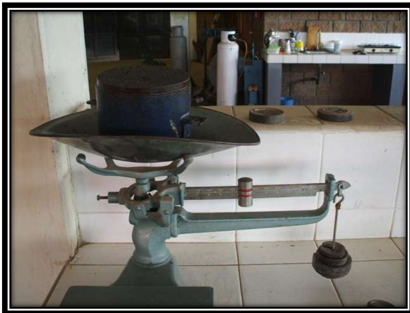
Fig.3.7.30 Obteniendo el peso de molde + suelo compactado.
