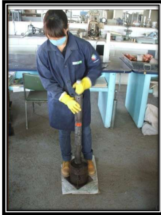
Fig. 3.7.38 Compactación de los especímenes.
