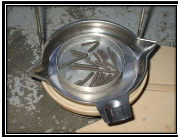
Fig. 3.7.19 Obteniendo el peso de los rollitos de material, después de que estuvieron en el horno y enfriados a temperatura ambiente.
