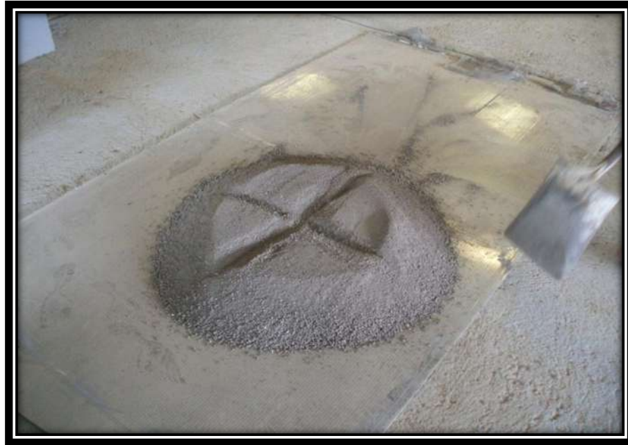
Fig. 3.7.8 Formación de los cuadrantes sobre el cono truncado.
