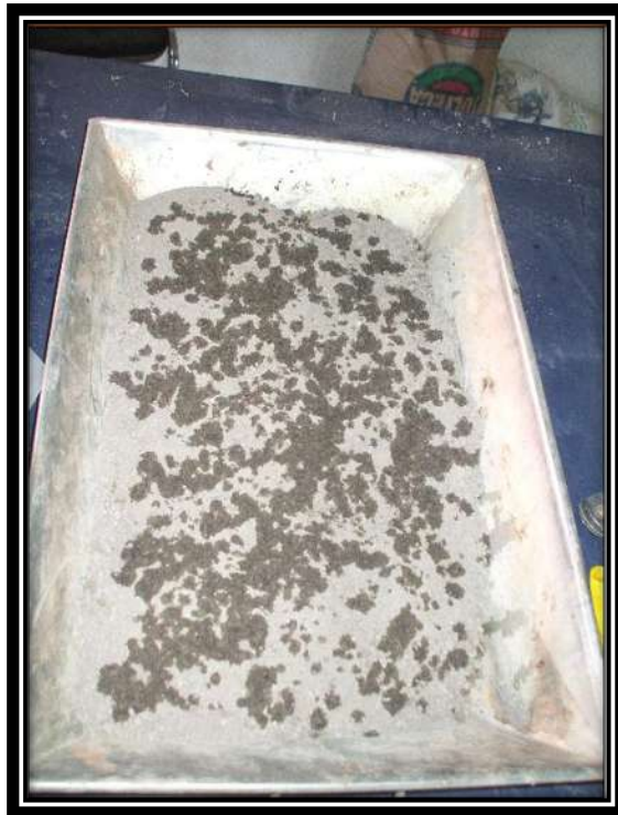
Fig.3.7.26 Colocación de agua en cantidades pequeñas, para ir uniformizando poco a poco la humedad en todo el suelo.
