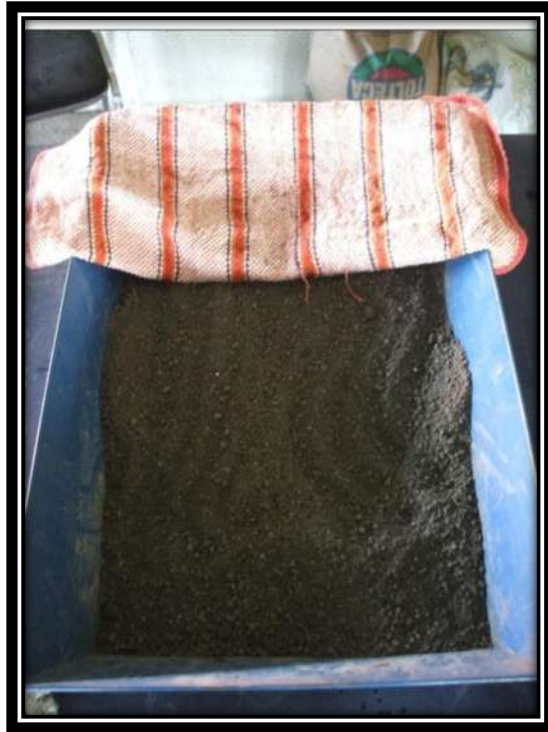
Fig. 3.7.37 Mezcla con el contenido de agua necesario, que es tapada con una franela húmeda para evitar pérdidas de agua.
