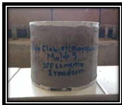
Figura 3.8.9 Muestra cabeceada, proporción: 200 kg de cemento, 2.0 kg de RoadCem y arcilla.
