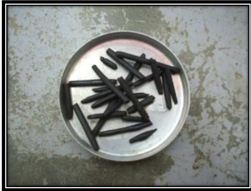
Fig. 3.7.17 Rollitos del material al presentarse la ruptura en 3 secciones, para la determinación del contenido de agua.
