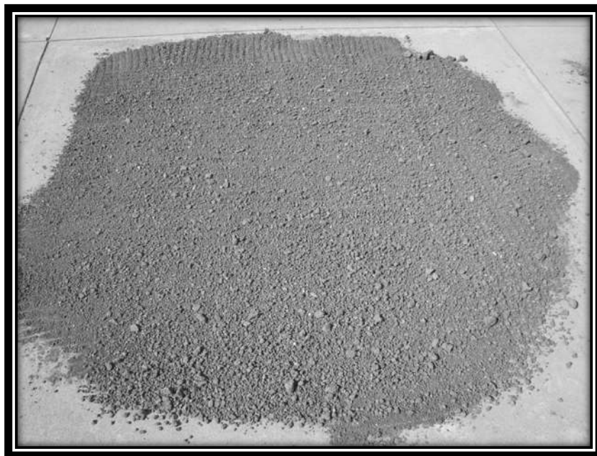
Fig. 3.7.5 Secado del material después de ser disgregado.
