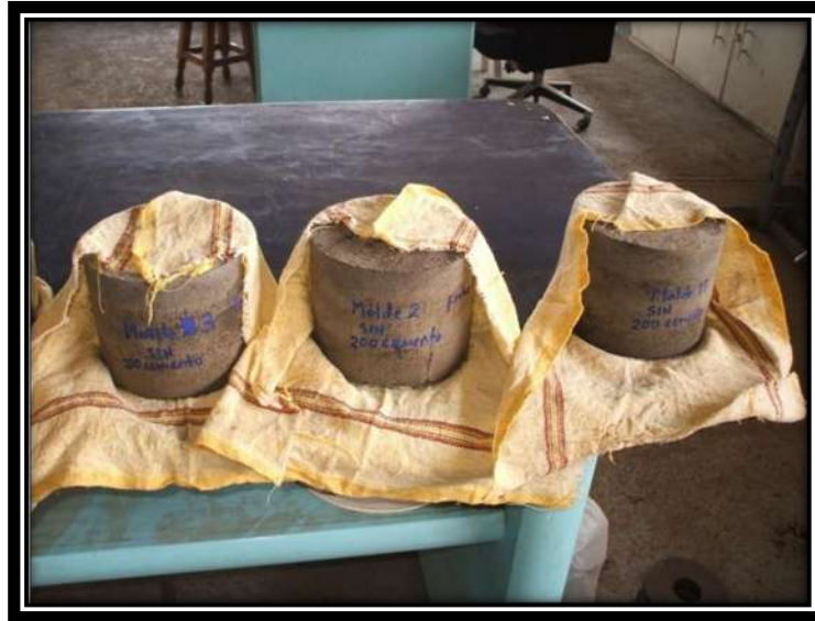
Fig. 3.7.40 Envoltura de los especímenes en franela húmeda para el procedimiento de curado.
