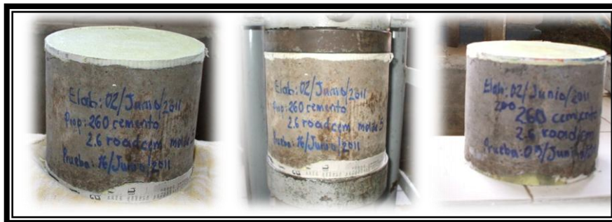
Figura 3.8.22 Antes, durante y después de la prueba a compresión simple (dosificación 260/2.6/arcilla).
