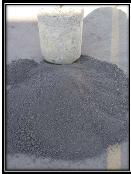
Fig. 3.7.4 Disgregado del material.
