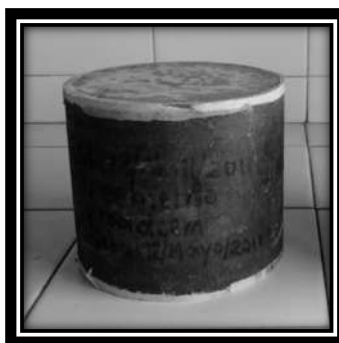
Fig. 3.8.4 Muestra cabeceada, con 180 kg de cemento, 1.8 kg de RoadCem y arcilla.
