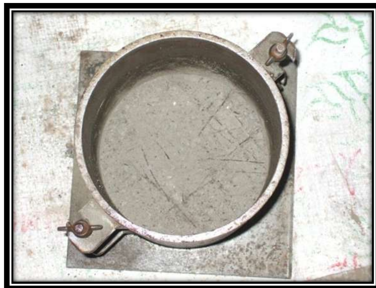
Fig. 3.7.28 Escarificación de la capa, que ayudará a la siguiente a unirse a ésta cuando se le apliquen los 56 golpes con el pisón.
