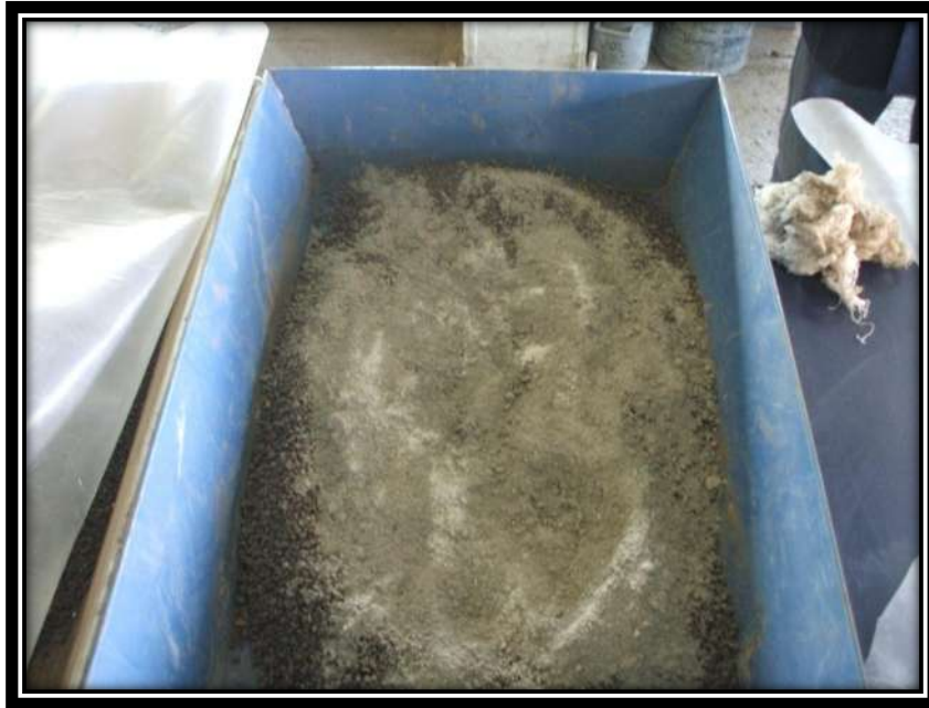
Fig. 3.7.34 Adición de arcilla, cemento y roadcem.
