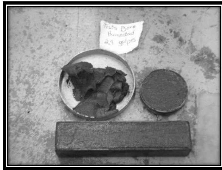
Fig. 3.7.13 Proporción del material que tuvo contacto 1/2", para determinarle el contenido de agua, y las contracciones volumétrica y lineal.
