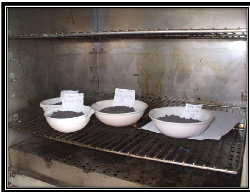
Fig.3.7.31 Proporciones de cada espécimen compactado puesto en el horno para determinar su humedad.
