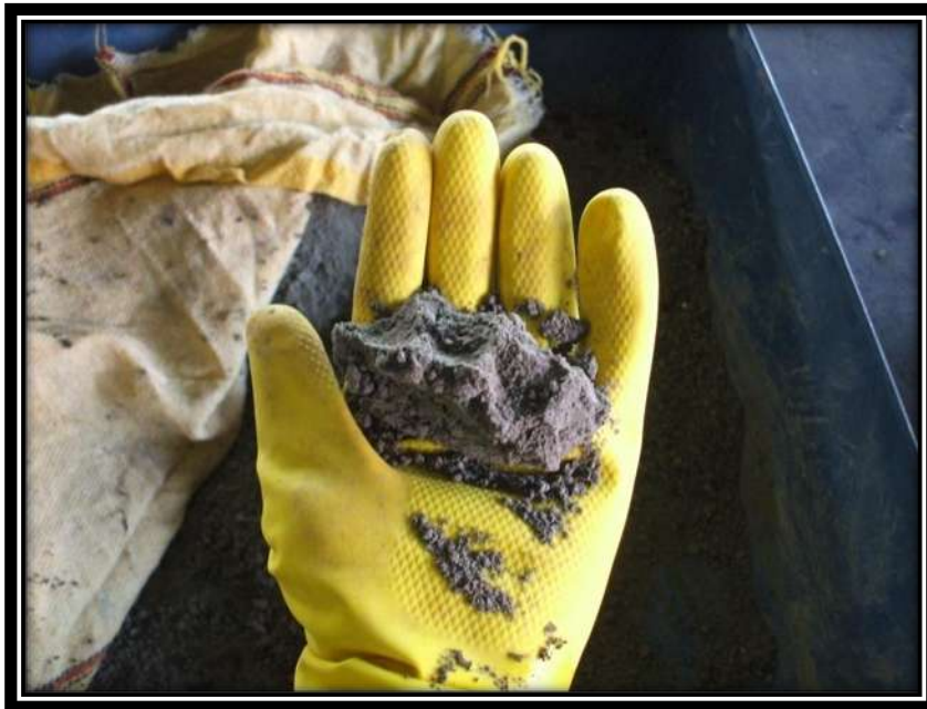
Fig. 3.7.36 Formación de un terrón formado por un apretón con la mano, después de la adición del agua.
