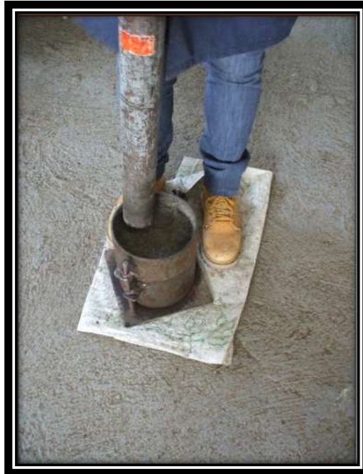
Fig.3.7.27 Compactación AASHTO Modificada, donde se observa una repartición uniforme en toda el área del molde.
