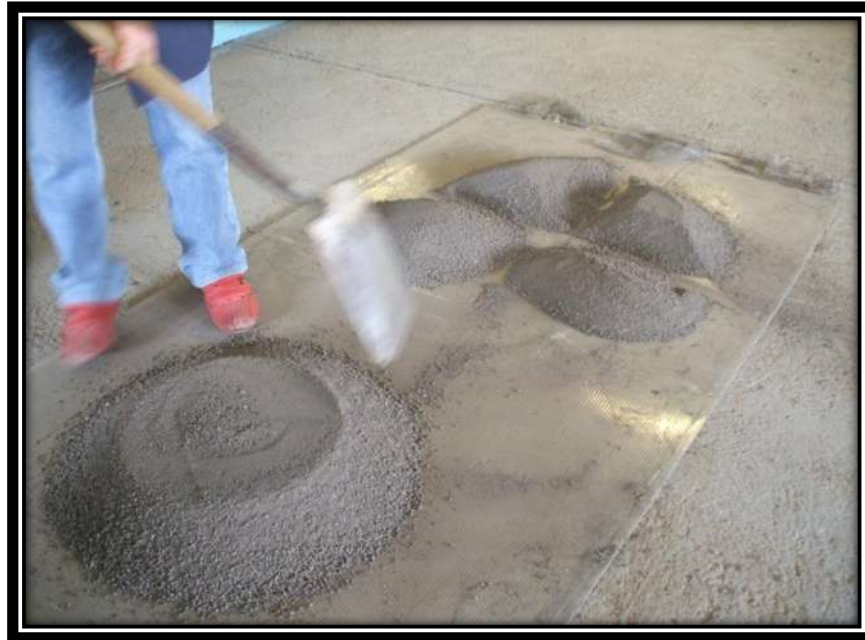
Fig. 3.7.7 Formación del Cono Truncado y la formación de los cuadrantes en el cuarteo de la muestra.
