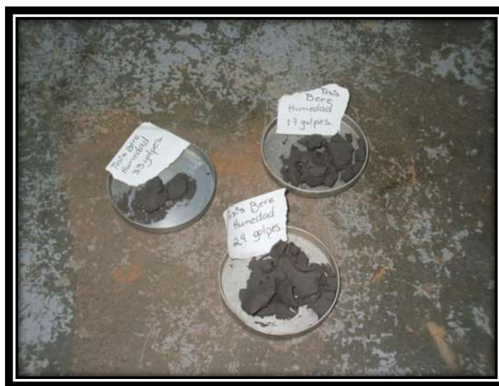
Fig. 3.7.14 Proporción del material que tuvo contacto 1/2", para la determinación del contenido de agua, después del secado en horno.
