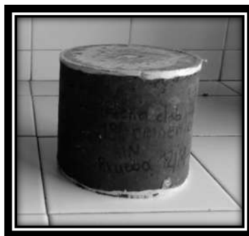
Fig. 3.8.2. Muestra cabeceada, con 180 kg de cemento, arcilla y sin RoadCem.
