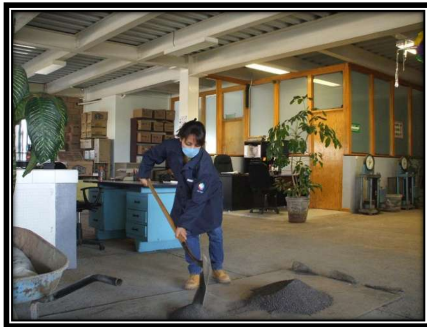
Fig. 3.7.6 Traspaleo del material después de ser disgregado, colocado en una superficie que permite recogerlo fácilmente.
