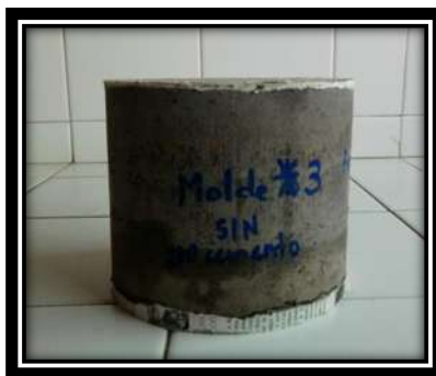
Figura 3.8.7 Muestra cabeceada, con 200 kg de cemento y arcilla.
