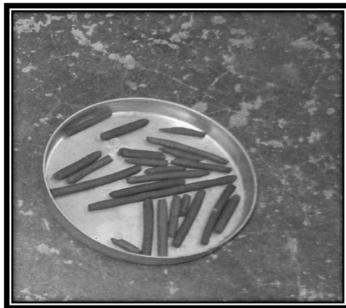
Fig.3.7.18 Rollitos de material, recién salidos del horno, enfriándose a temperatura ambiente para determinar su contenido de agua.
