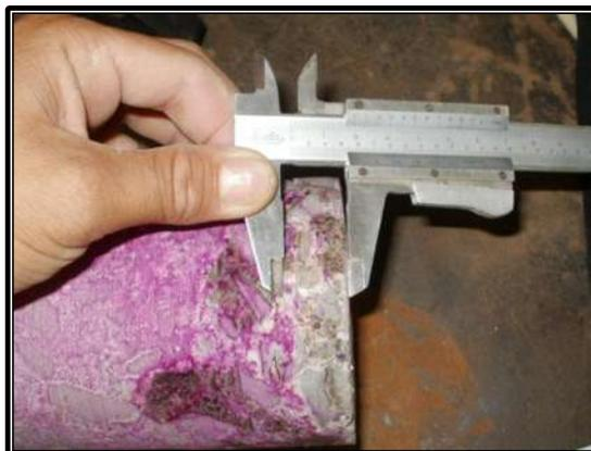
Figura VII.3 Medición de la profundidad de carbonatación.
