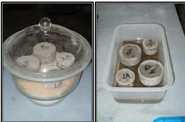
Figura VII.12 Probetas en el desecador y cubeta de fondo plano.
