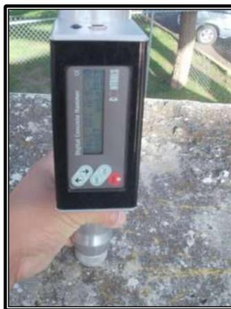
Figura VII.11 Esclerómetro digital.
