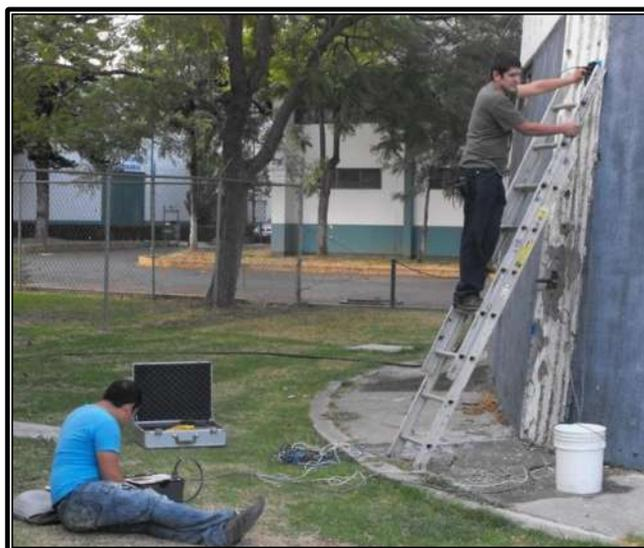
Figura VII.19 Colocación del equipo necesario para la medida de velocidad de corrosión.
