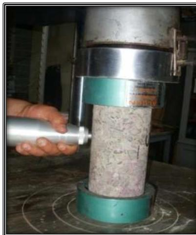
Figura VII.9 Toma de lecturas con esclerómetro en prueba de pulso ultrasónico combinada.
