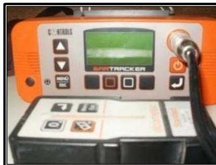
Figura VII.14 Equipo utilizado para localización y determinación de la profundidad de la armadura.
