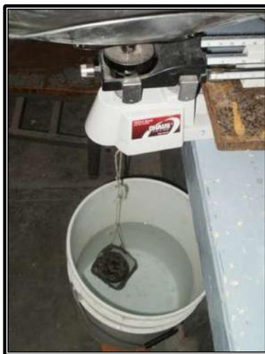
Figura VII.13 Determinación del peso sumergido.
