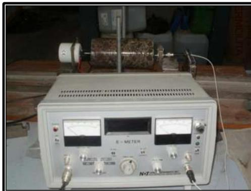
Figura VII.10 Sonómetro comercial utilizado para determinar Frecuencias de resonancia.
