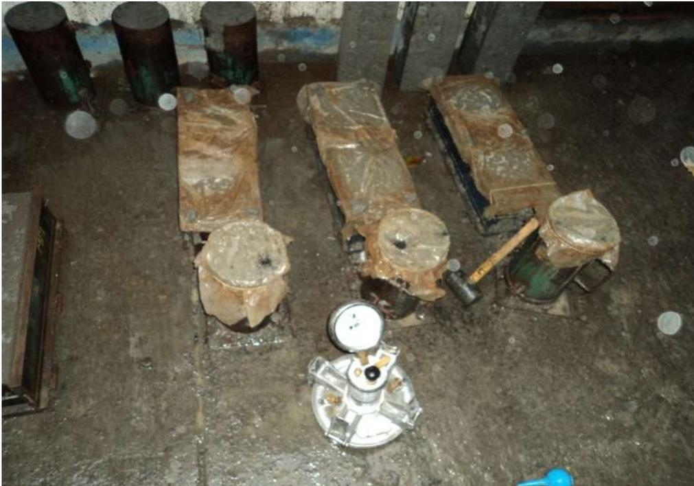
Fotografía 40. Elaboración de cilindros y vigas de concreto en laboratorio.
