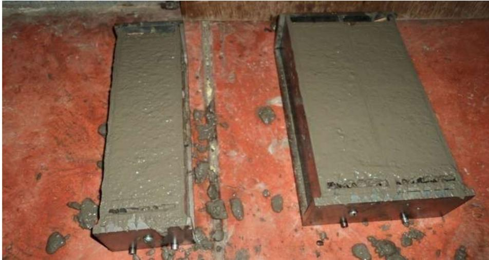
Fotografía 42. Elaboración de barras para medición de expansión.
