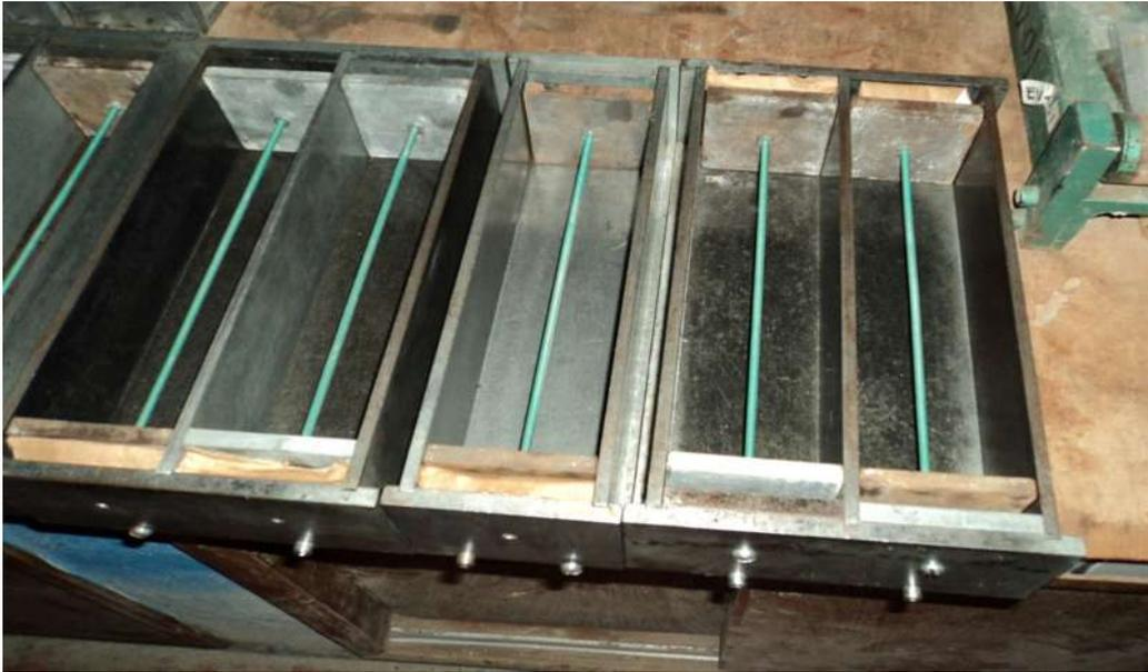
Fotografía 41. Armado de moldes para elaboración de barras (medición de expansión).
