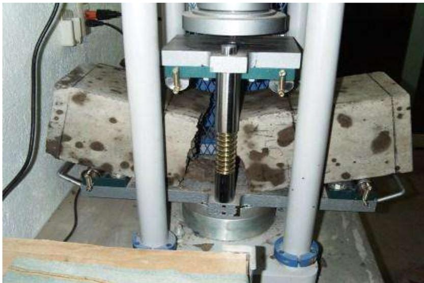
Fotografía 17. Ensayo a flexión de viga de concreto (carga aplicada en los puntos tercios).
