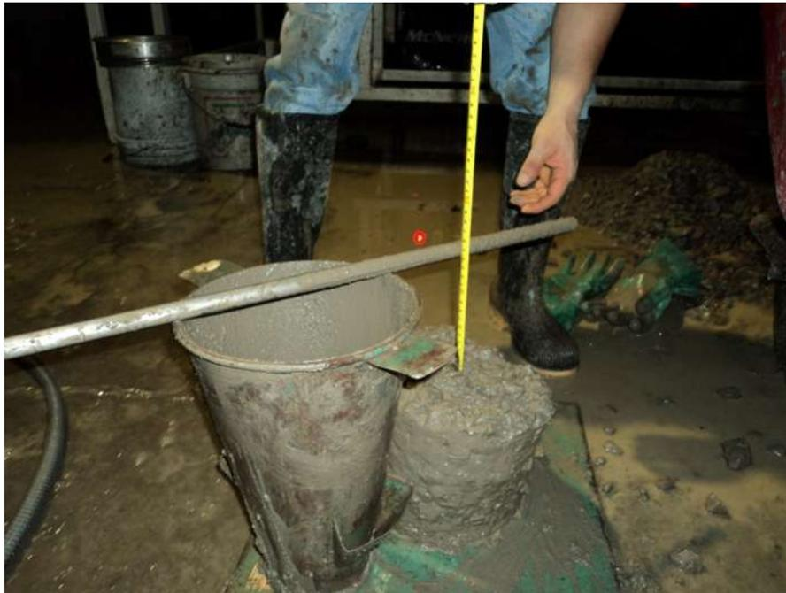
Fotografía 38. Medida del revenimiento de un concreto.
