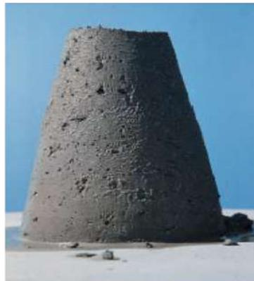
Fotografía 15. Concreto con consistencia rígida.
