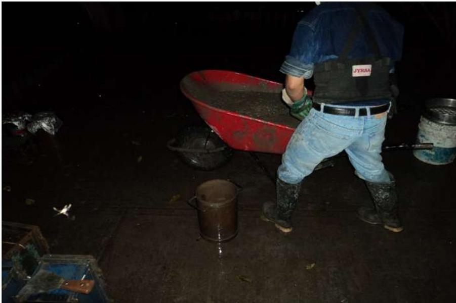
Fotografía 39. Preparación de la muestra para la masa unitaria.
