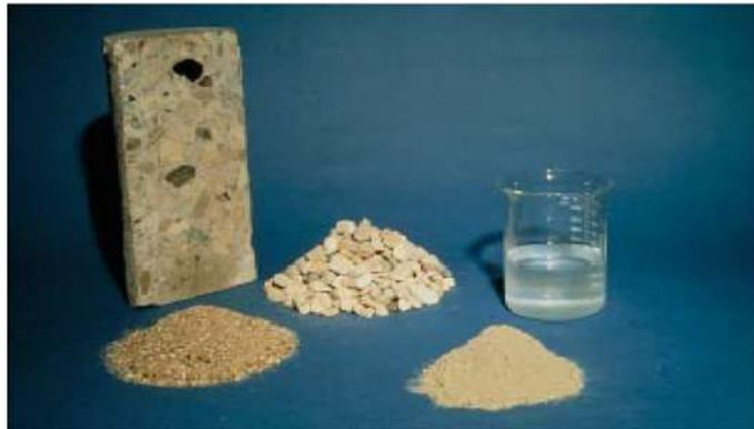
Fotografía 7. Componentes básicos del concreto: cemento, agua, agregado grueso, agregado fino.
