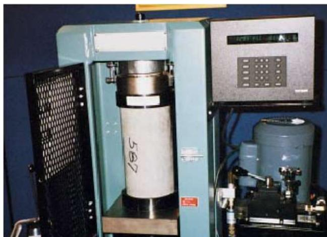
Fotografía 16. Ensayo a compresión de cilindro de concreto.
