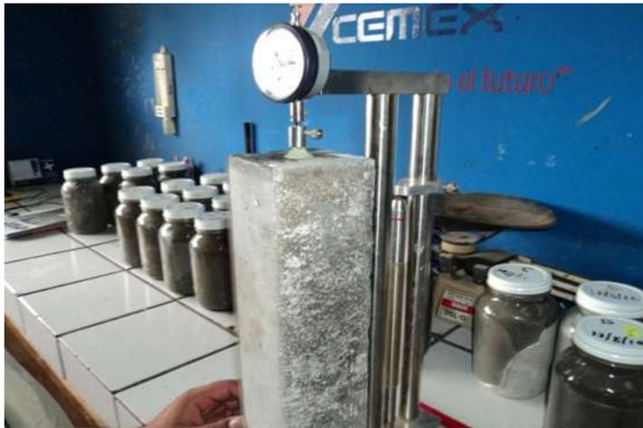
Fotografía 43. Medidor de expansión.
