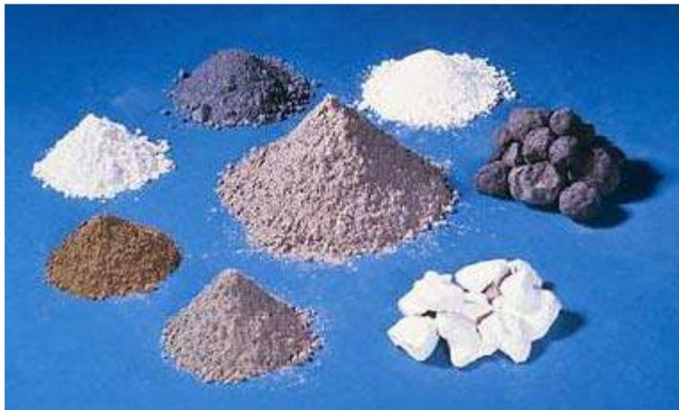
Fotografía 3. Al centro cemento adicionado rodeado por (derecha y en el sentido del reloj) clinker, yeso, cemento portland, ceniza volante, escoria, humo de sílice y arcilla calcinada.
