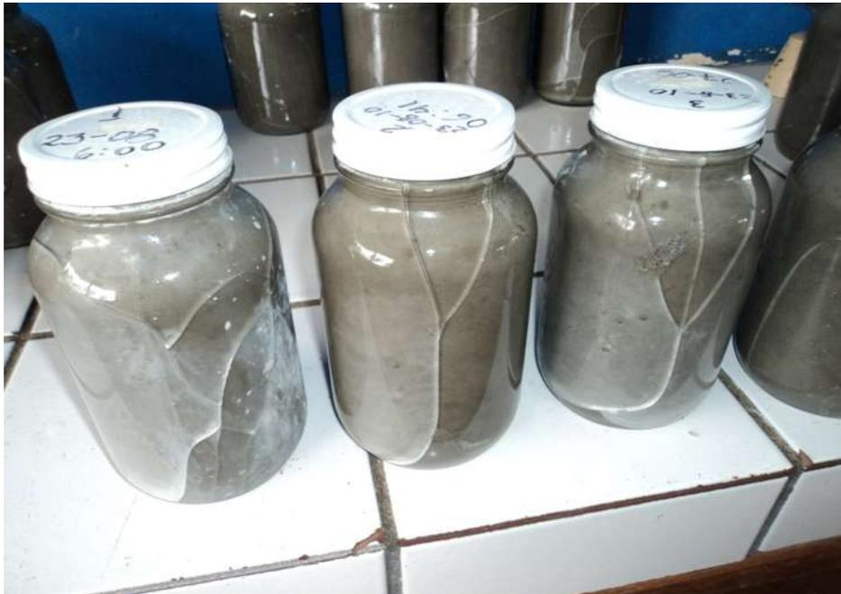
Fotografía 44. Expansión de concreto en frascos de vidrio.
