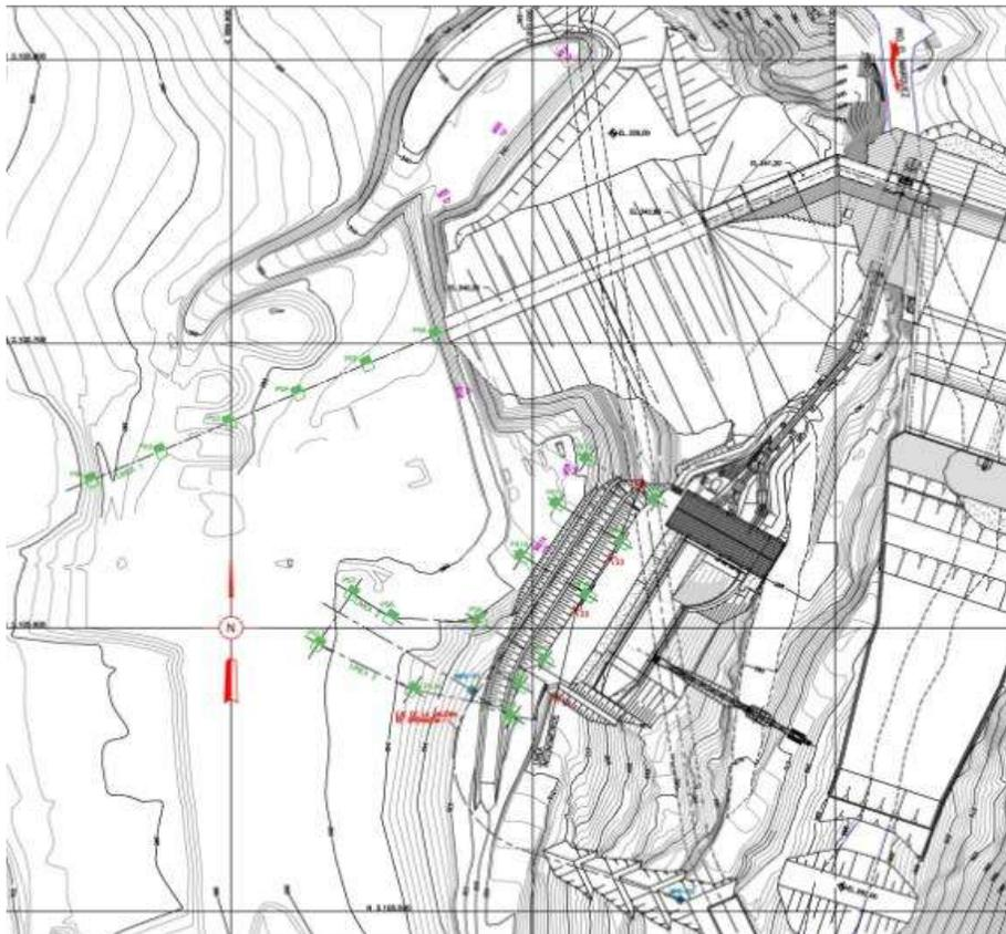
La solución adoptada comprende una excavación del conglomerado y el cierre de una presa de núcleo con enrocamiento que prevé un tapete impermeable hasta la elevación 325,00, constituyendo el elemento previsto para alargar el camino de percolación en el perímetro de contacto con la excavación del conglomerado. Teniendo en cuenta que la línea freática no desciende a niveles que aseguren la estabilidad al deslizamiento con
