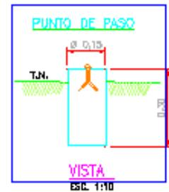
*Control Planimétrico.* Para ello el proyecto previó la instalación de puntos de control por bujes de centrado forzoso donde se instalarán señales de puntería.
