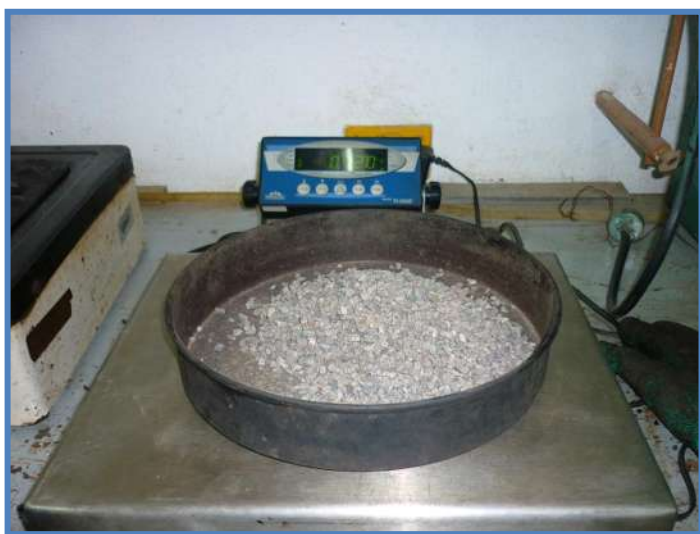
Figura 4.11. Pesado de material pétreo fracción gruesa
