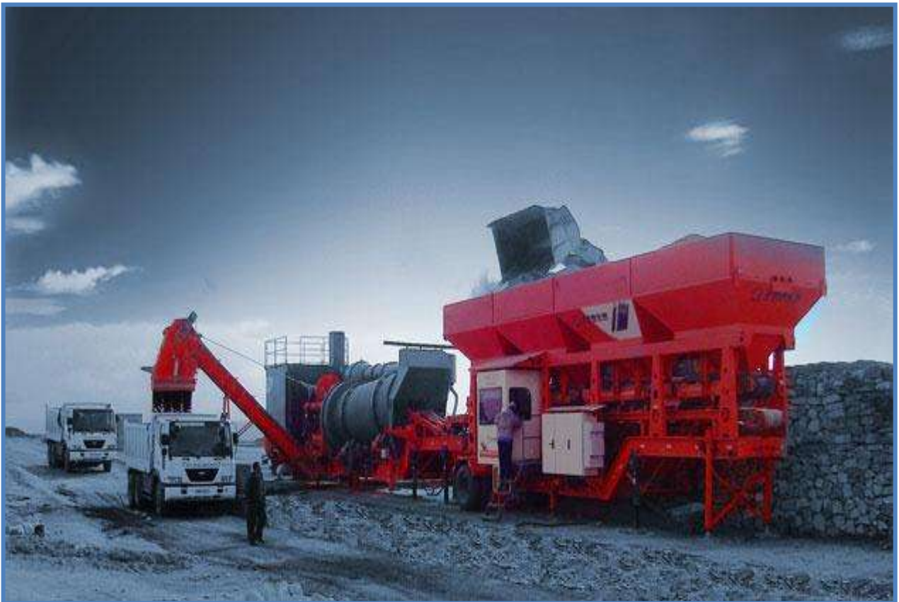
Figura 2.5. Planta de asfalto para elaboración de mezclas en caliente (Fuente: http://www.ciber.com.br/es/tecnologias/plantas-de-asfalto-contrafujo/Counter-flow_Aspphalt_Plant.html?gclid=CIDgpoapy68CFQpY7AodIhP3bw ).
