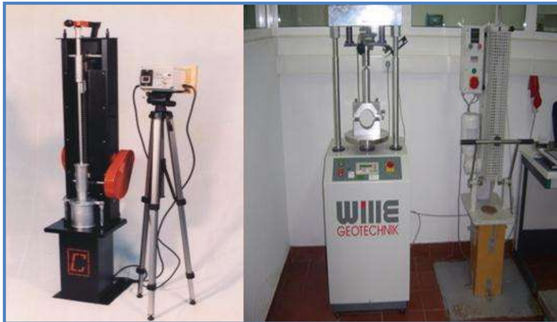
Figura 2.7. Equipo Marshall, prensa y compactador
