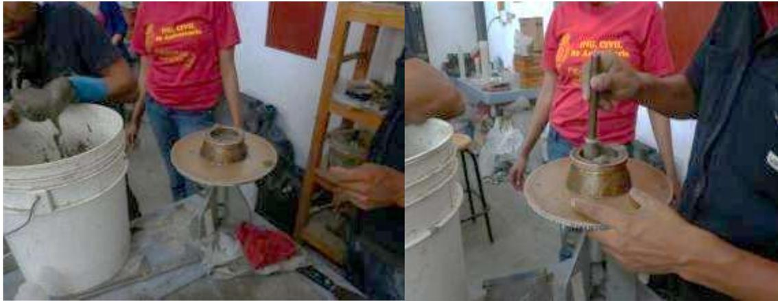
*Figura 7.18. a) Mesa de fluidez; b) Apisonamiento de la mezcla.*
