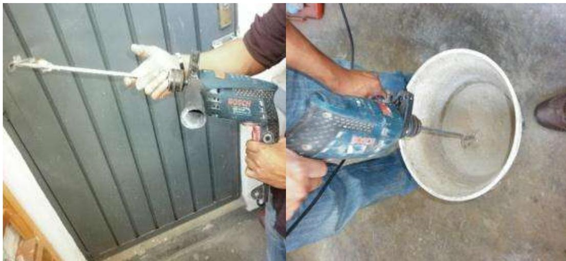
*Figura 7.20. a) Taladro eléctrico con aspa; b) Elaboración de la Mezcla.*
