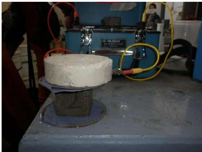
*Figura 7.37. Especimen prismático colocado entre las dos placas de cobre lista para tomar la resistencia eléctrica.*
