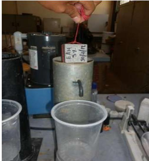
*Figura 7.32. Determinación de la densidad de especímenes cúbicos.*
