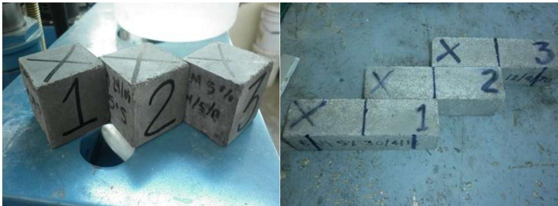
Figura 7.34. Especímenes cúbicos y primas etiquetados y medidos.
