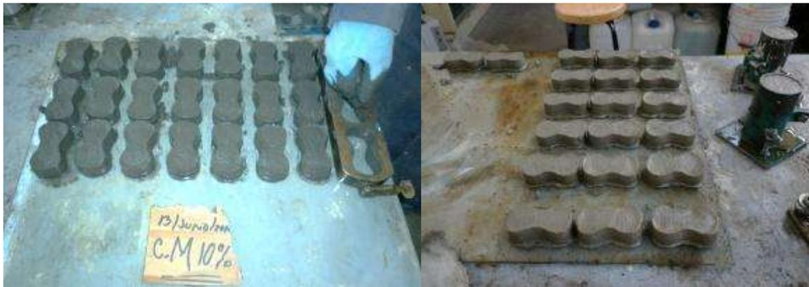
Figura 7.28. Creación de las briquetas de mortero.
