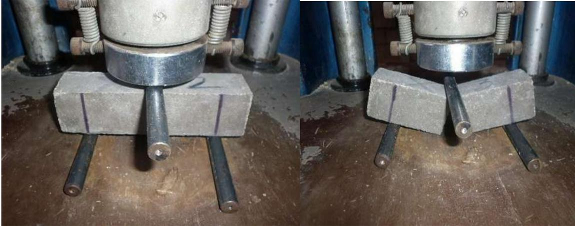
Figura 7.40. a) Colocación de los apoyos y del prisma, b) Ruptura del prisma.
