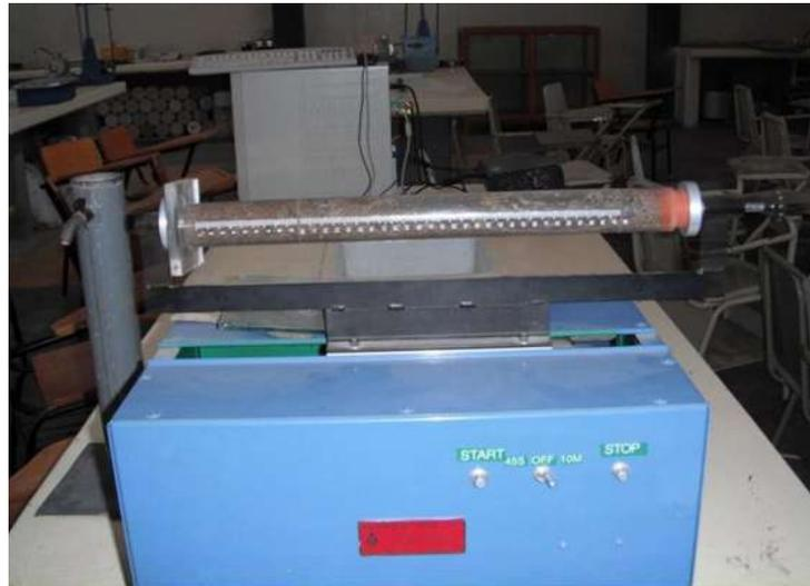
Figura 7.16. Obtención de la equivalencia de arena.
