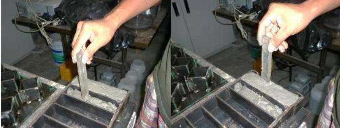
*Figura 7.25. Llenado de los moldes prismáticos.*
