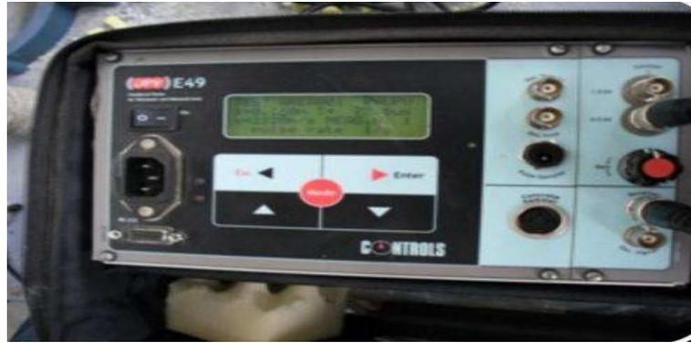
Figura 7.33. Equipo para medir la velocidad de pulso.
