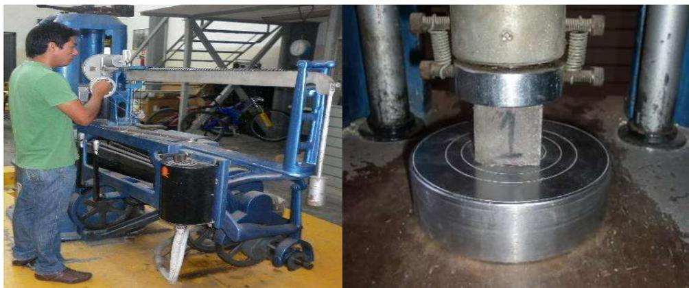
Figura 7.38. a) Maquina universal TiniusOlsen, b) Especimen colocado en la platina.
