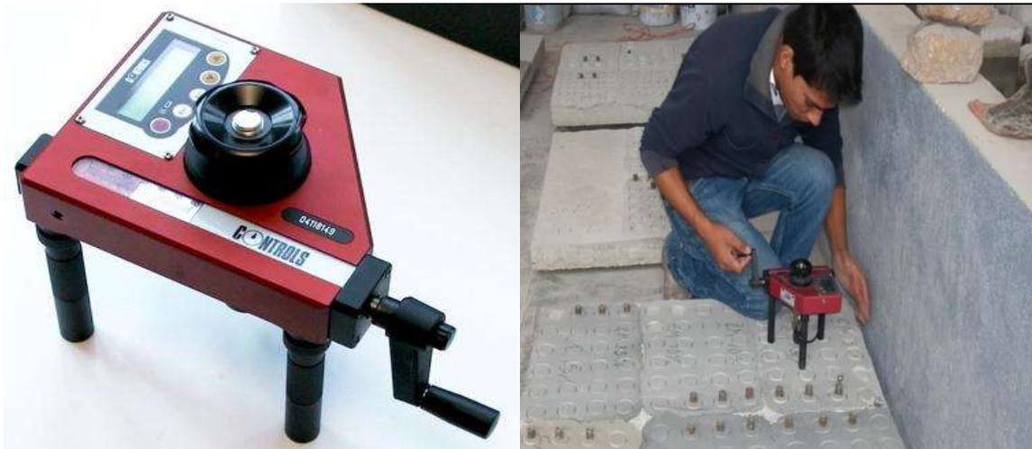
*Figura 7.43. Instrumento de prueba de adherencia y aplicación de la prueba.*
