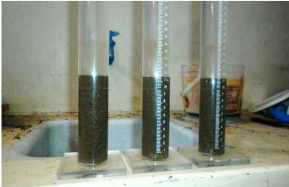
Figura 8.2. Determinación de equivalente de arena.
