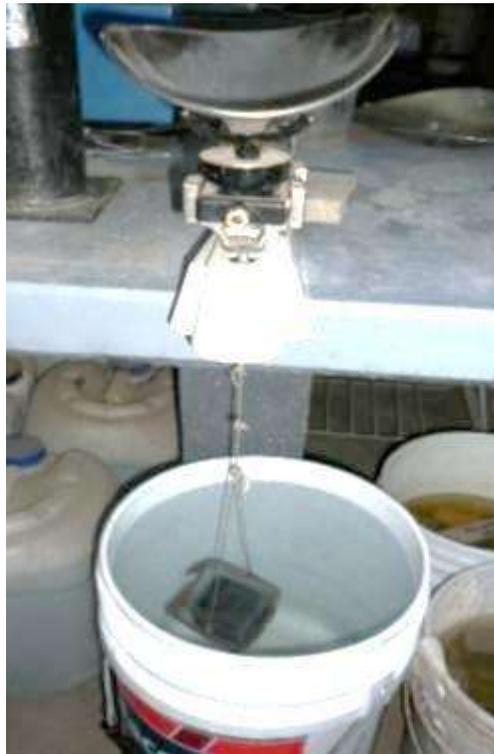
*Figura 7.31. Determinación de la gravedad específica.*
