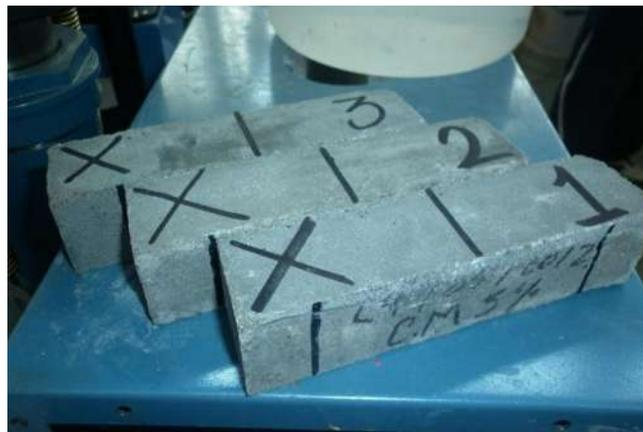
Figura7.39. Prismas marcados a 1in de los extremos y a ½ de la longitud.
