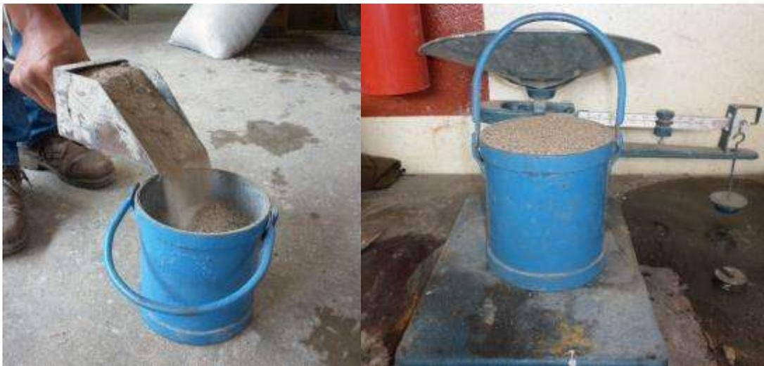
Figura 7.11. Determinación del PVSS.
