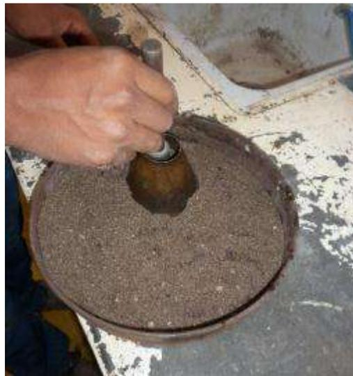
*Figura 7.10. Determinación de la Humedad Actual.*
