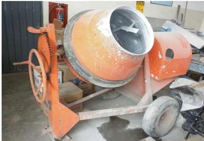
Figura 7. 29. Revolvedora automática con motor eléctrico.
