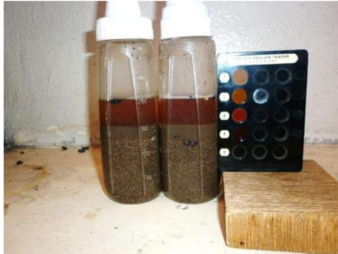
Figura 7.13. Determinación de la colorimetría. Propias del autor.
