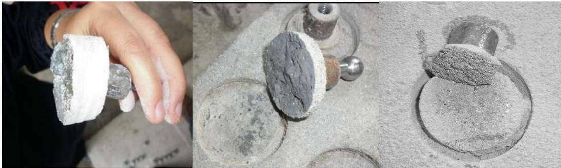
*Figura 7.45. Facturas del EAH, a) falla del concreto; c) falla por interface; falla del mortero.*
