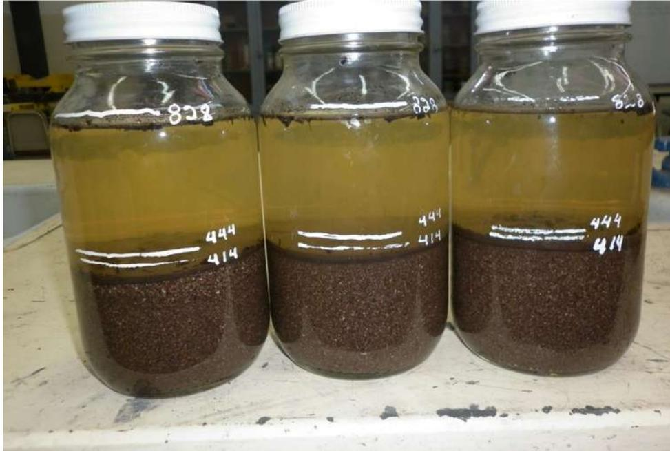
Figura 8.1. Determinación de sedimentos en la arena.
