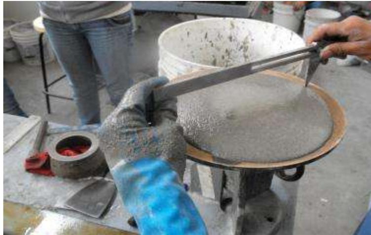
*Figura 7.19. Medición de la fluidez.*
