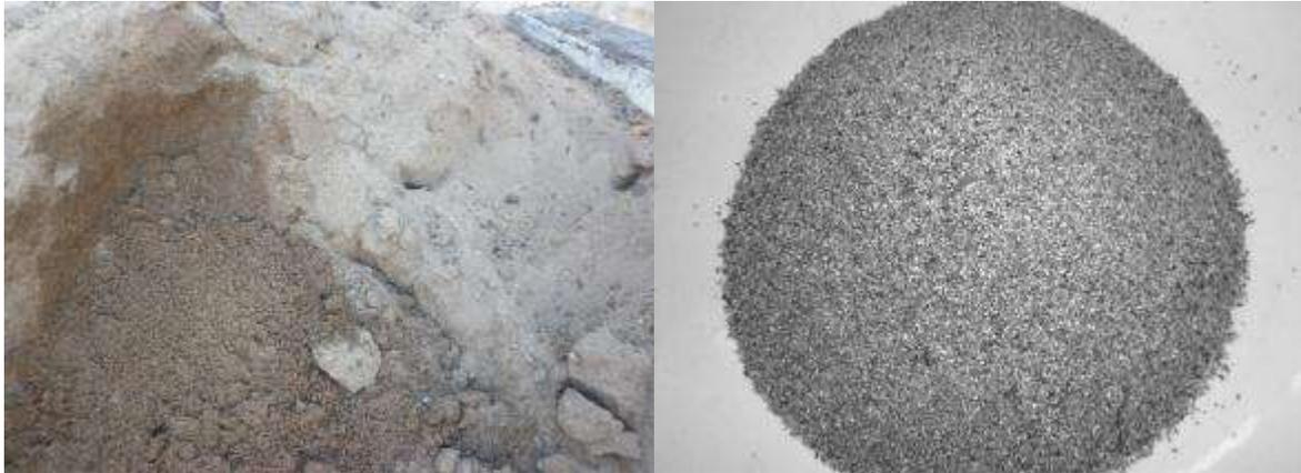
*Figura 7.8. Arena de río Lerma sin cribar y arena cribada.*
