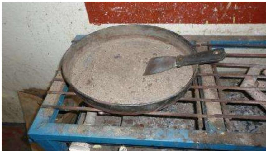
*Figura 7.9. Secado de arena de río para la obtención de Humedad actual.*
