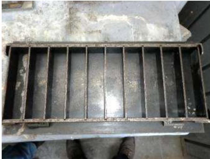
*Figura 7.24. Moldes de prismas con 10 cavidades.*
