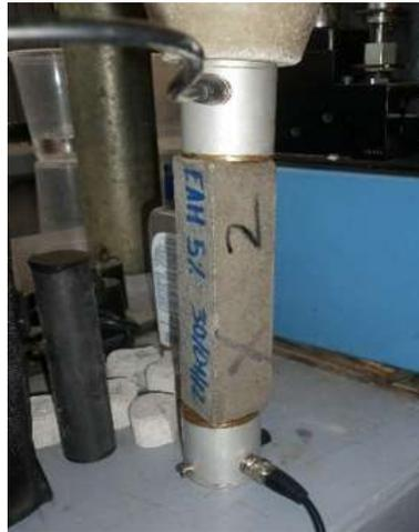
Figura 7.35. Especimen prismático en prueba de velocidad de pulso.
