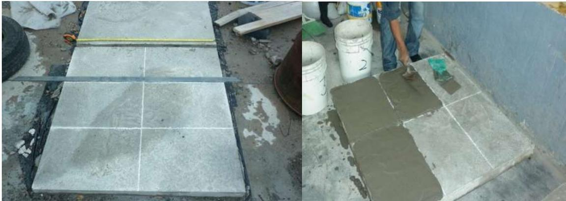
Figura 7.30. Preparación de las losas para la prueba de adherencia.
