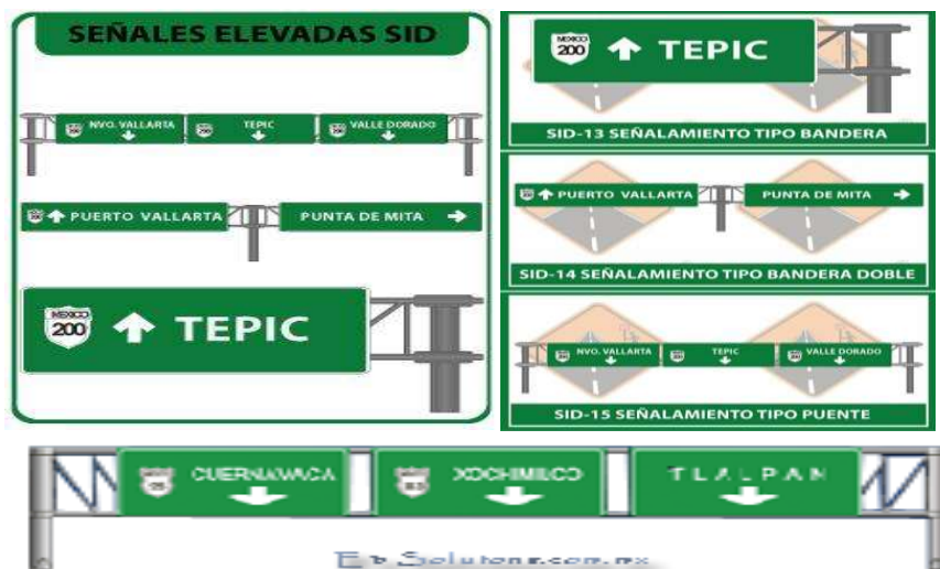
Fig.3.71 SEÑALES VERTICALES ELEVADAS (SID).
