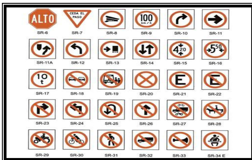
Fig.3.62 SEÑALAMIENTO RESTRICTIVO (SR).
