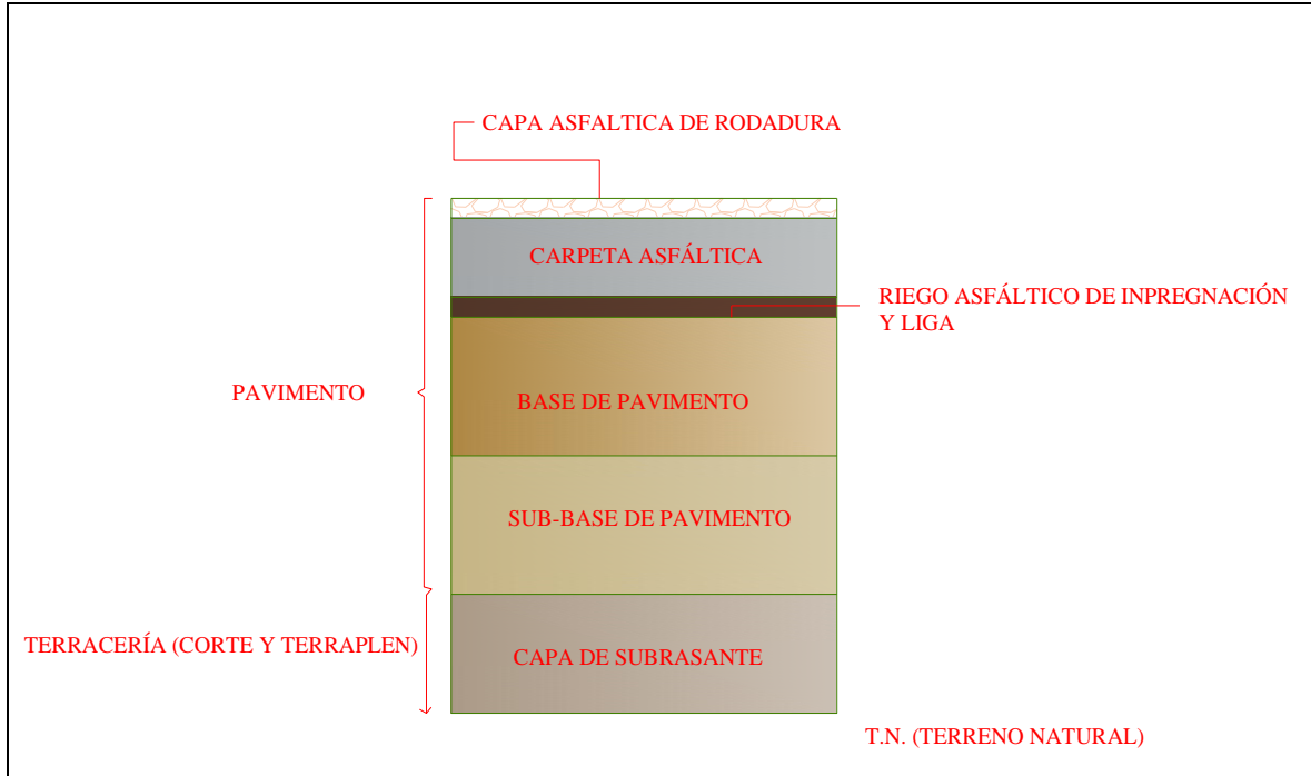
Dibujo 2.3 capa asfáltica de rodadura.
