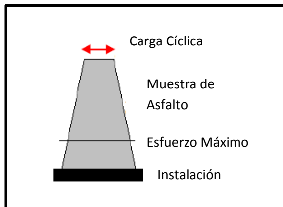
Figura 34. Esquema de la muestra de la prueba de tensión de flexión en los 2 puntos.
