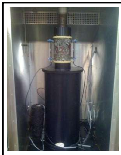
Figura 22. Imagen de la cámara GCTS para Módulo Dinámico. José Eduardo García Servín.
