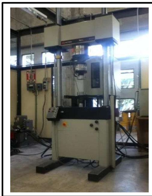
Figura 32. Prensa Universal utilizada para ensayos de Compresión en el Instituto Mexicano del Transporte (IMT). José Eduardo García Servín.
