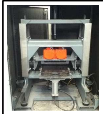
Figura 52. Vista Interior del Compactador Lineal.
