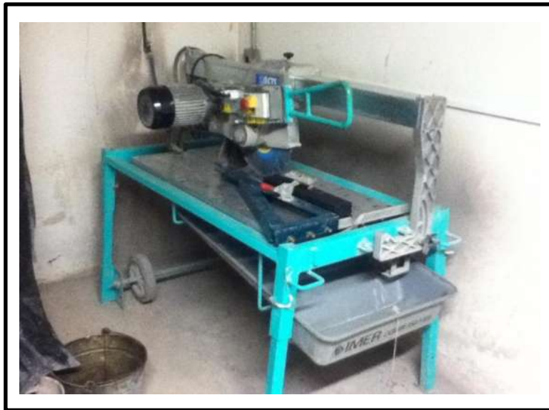
Figura 54. Imagen de la Viga en la Sierra de Corte, con la cual se modifican las dimensiones hasta Contar con las que Indica la Norma. José Eduardo García Servín.
