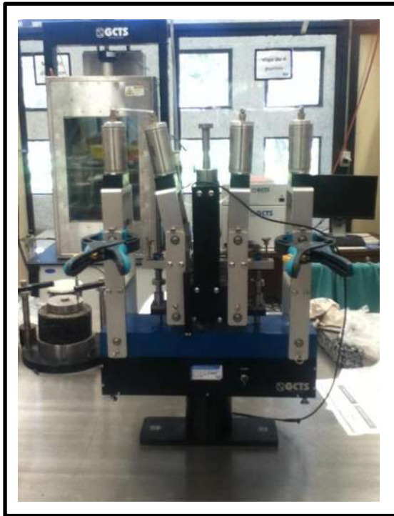
Figura 57. Imagen del equipo utilizado en el ensayo a la Fatiga con Viga de 4 Puntos.
