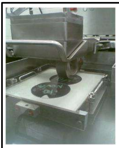
Figura 18. Rueda Cargada de Hamburgo.
