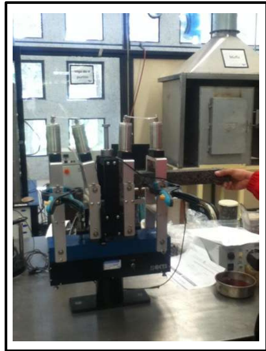
Figura 58. Colocación de la Viga en el equipo de Fatiga.
