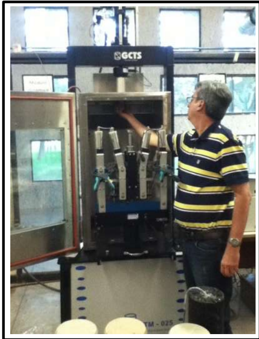
Figura 23. Imagen del Equipo GCTS, Exterior (Izquierda) e Interior (Derecha) para el Ensayo de Fatiga Empleando la Viga de Flexión de 4 Puntos. José Eduardo García Servín.
