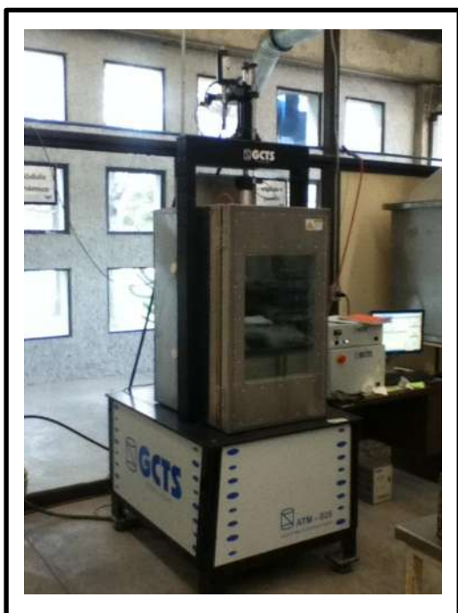
Figura 49. Imagen del Equipo Utilizado en la Prueba de Módulo Dinámico y Fatiga. Figura 50. Compresor y Equipo de Cómputo Donde se registra la Información de la Prueba.
