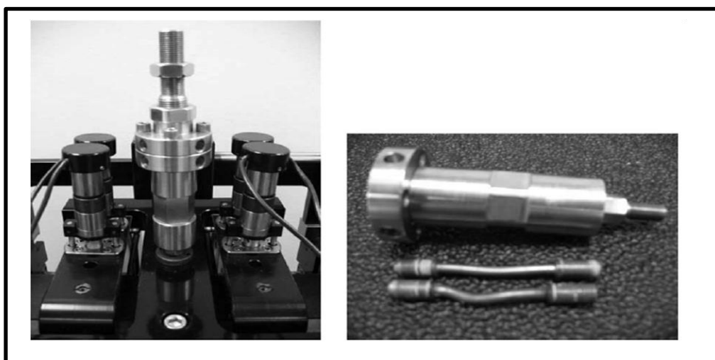
Figura 66. Acoplador de la barra de tensión, conectar el accionador a la estructura en H (abrazaderas interiores).
