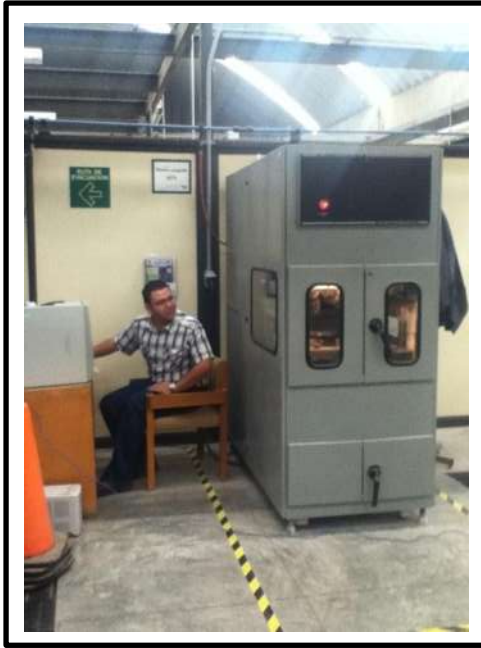
Figura 19. Analizador de Pavimentos Asfálticos.
