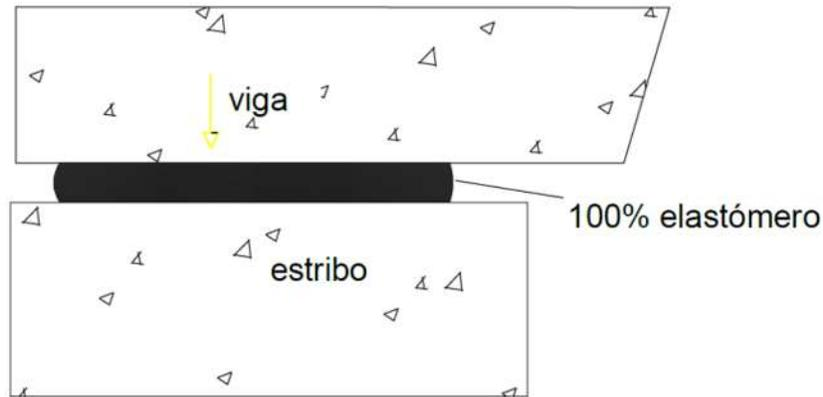
Figura 13. Colocación de neopreno 100% elastómero.
