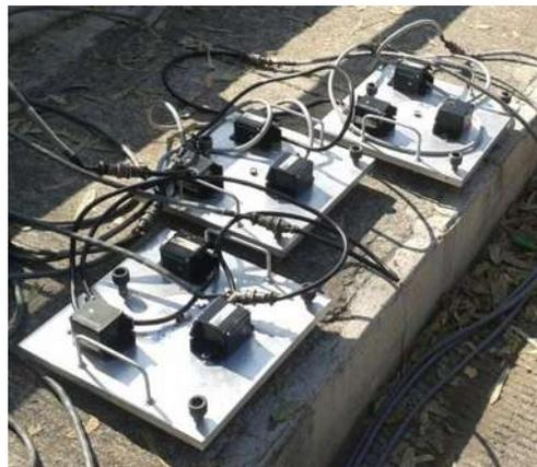
Figura 46. Conexión de los sensores sobre las placas.
