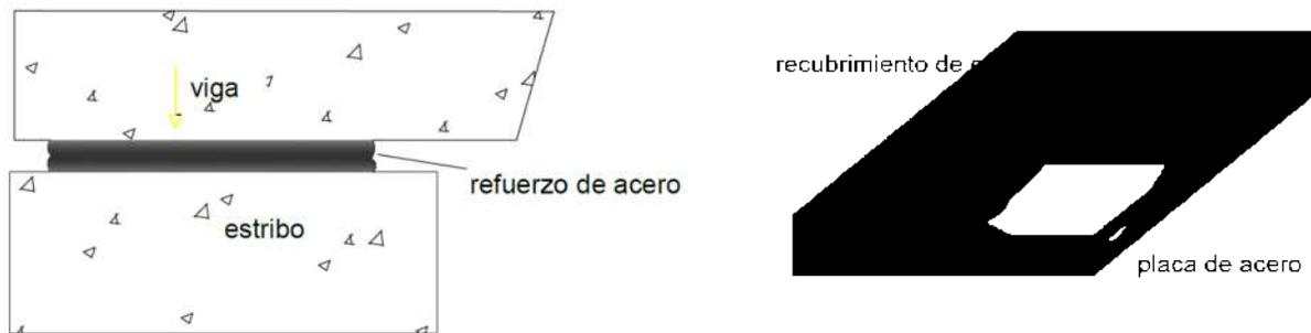
Figura 14. Neoprenos con placas de acero.
