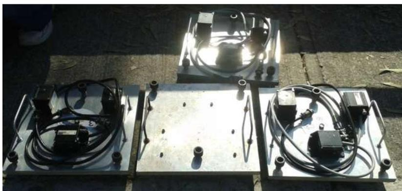
Figura 42. Placas de aluminio con sensores uniaxiales ES-U2
