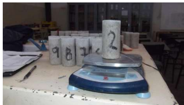
Ilustración 78. Para cada ciclo de prueba, se pesaron todos los especímenes.
