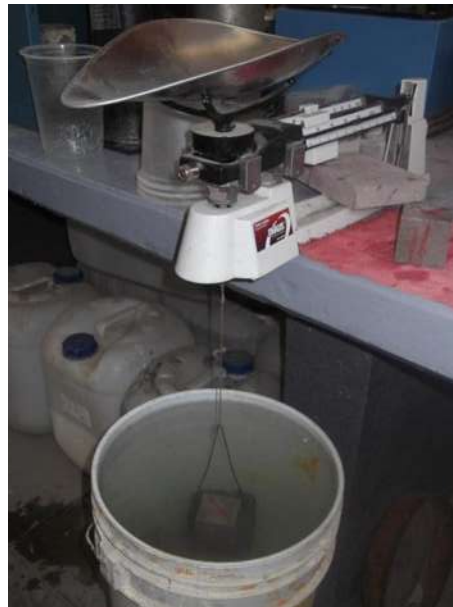
Ilustración 55. Determinación de la gravedad específica.
