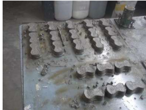
Ilustración 43. Briquetas de mortero con adición de Metacaolín.
