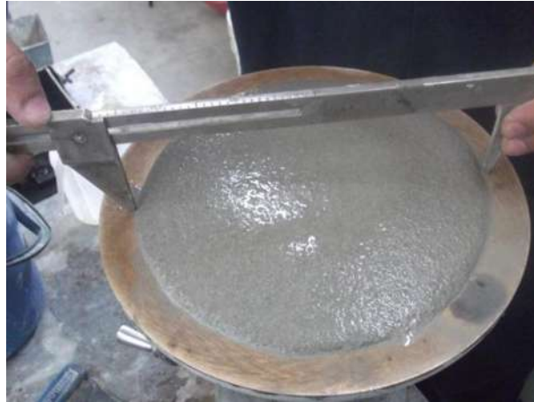
Ilustración 30. Medición de la mezcla con ayuda del Vernier especial para esta medición.
