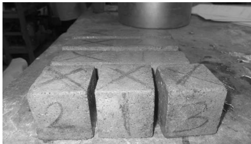
Ilustración 47. Especímenes marcados para realizar las pruebas programadas.
