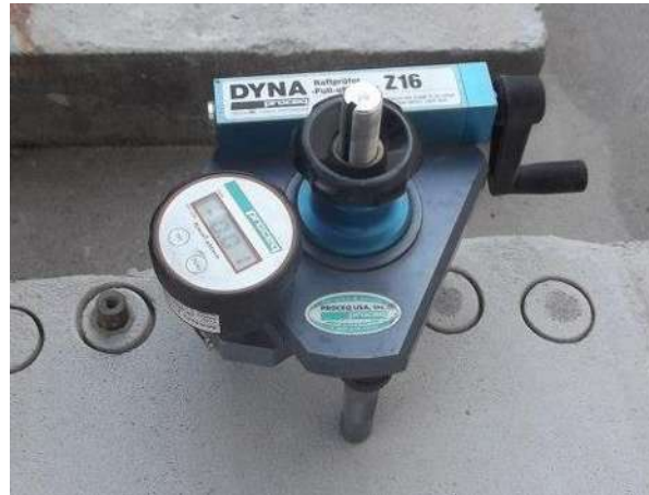
Ilustración 69. Equipo para prueba Pull Off marca DYNA.
