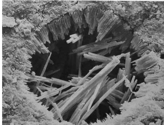
Ilustración 25. Depósitos blancos de etringita secundaria en un vacío. Ancho del campo 64 \mu\text{m} .
