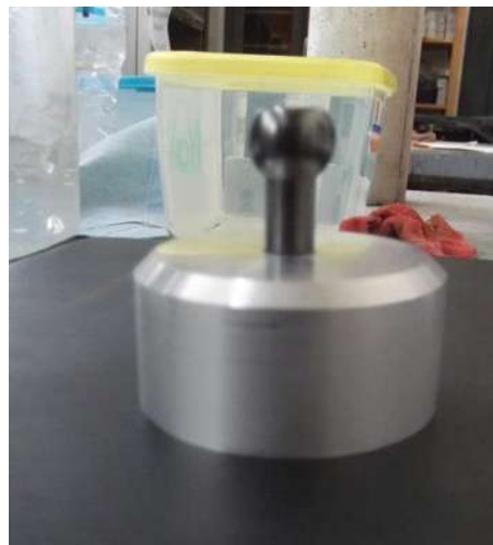
Ilustración 70. Perno con adaptador para el aparato de Prueba Pull Off.
