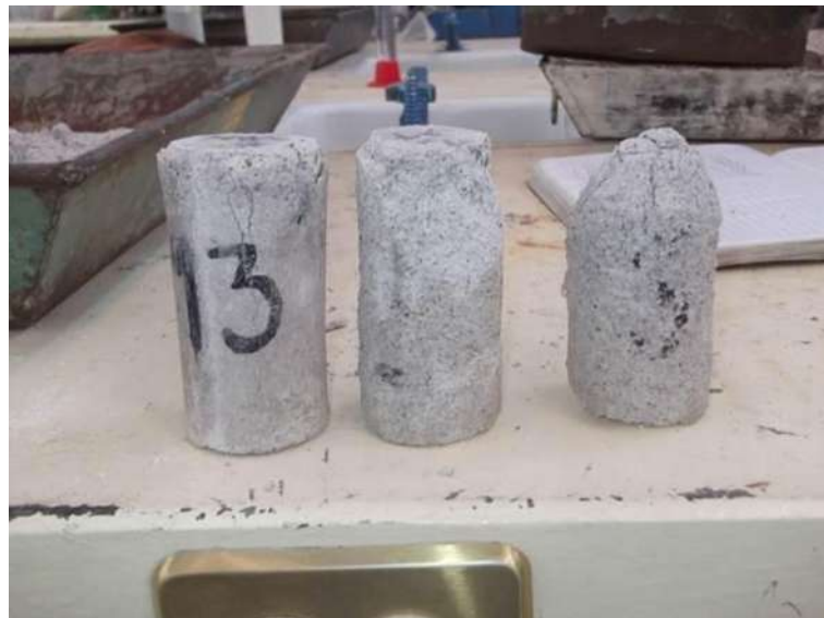
Ilustración 84. Comportamiento de los cilindros de MK, estos no resistieron los 5 ciclos de prueba.
