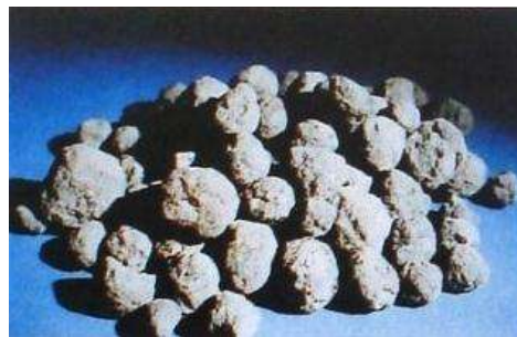
Ilustración 5. El clínker de cemento portland se forma por la calcinación en el horno del material crudo calcáreo y sílice. Este clínker específico tiene un diámetro de 20 mm (3/4 pulg.)
