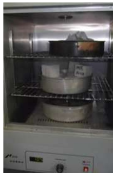
Ilustración 56. Especímenes en el horno para obtener el peso seco.
