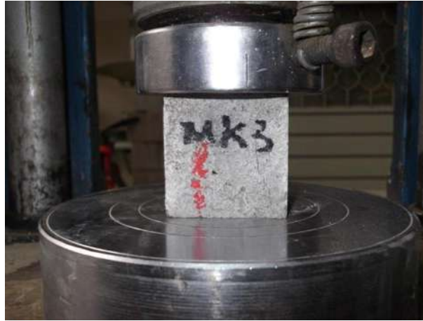
Ilustración 58. Espécimen probado a compresión utilizando la máquina universal Tinius Olsen.
