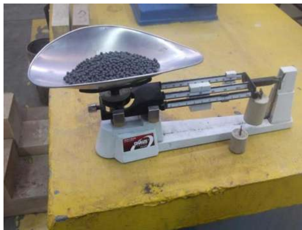
Ilustración 63. Peso de las municiones en la bascula con aproximación al decimo de gramo.
