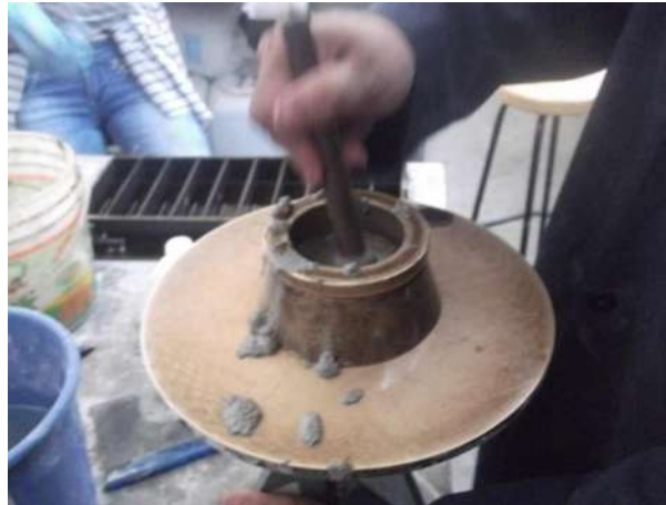
Ilustración 29. Pisón prueba de fluidez
