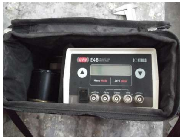
Ilustración 53. Equipo de velocidad de pulso ultrasónico, modelo 58-E0048 marca CONTROLS.
