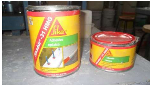
Ilustración 67. El epóxico utilizado es marca Sikadur-31 Hi-Mod Gel.
