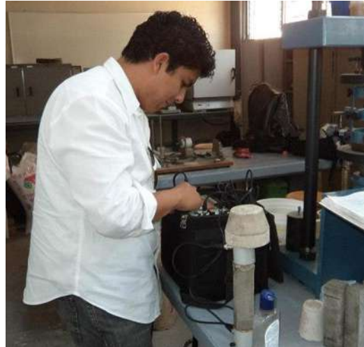
Ilustración 52. Realización de la Prueba de Velocidad de Pulso.
