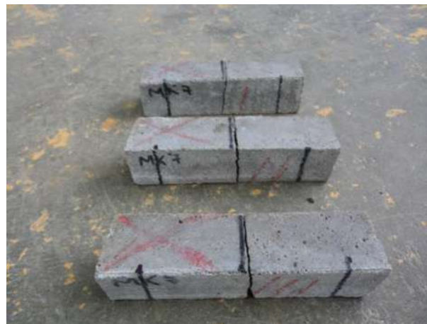
Ilustración 59. Se puede apreciar cómo se marco el espécimen y el tipo de falla presentado en esta investigación de la prueba de flexión en prismas.
