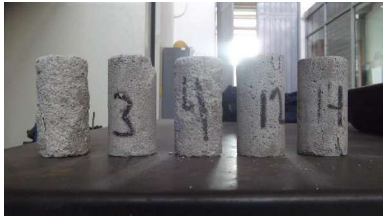
Ilustración 83. Comportamiento del poliestireno durante los 5 ciclos de prueba, como se puede notar no están destruidos por lo que se nos permitió probar a compresión cada ciclo.
