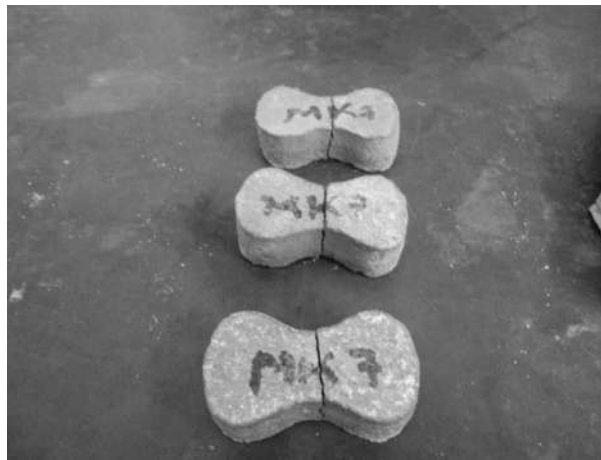
Ilustración 64. Tipo de falla presente en la gran mayoría de las briquetas probadas, al centro de la briqueta.
