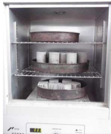
Ilustración 77. Especímenes cilíndricos en el horno de secado.
