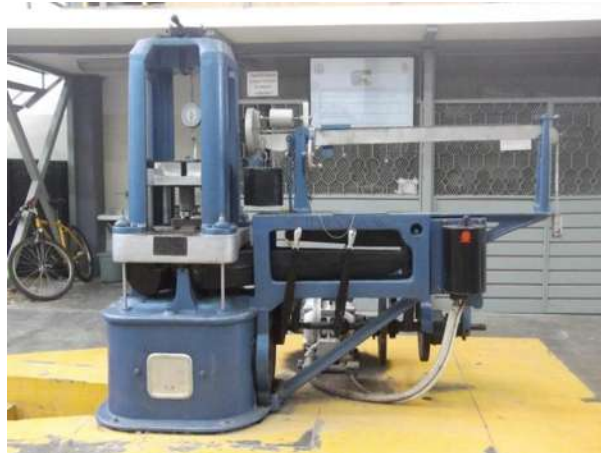
Ilustración 57. Prueba de Resistencia en cubos utilizando la máquina universal Tinius Olsen.
