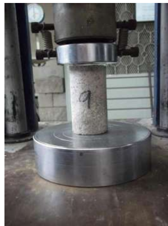
Ilustración 82. Espécimen Testigo sometido a compresión 2º Ciclo.
