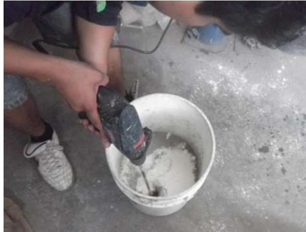
Ilustración 32. Taladro marca Bosch con potencia de 750w y 3500 RPM.
