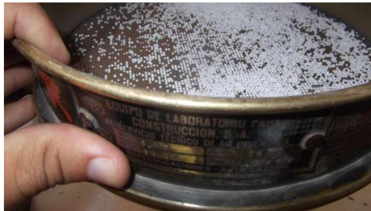
Ilustración 16. Las perlas de poliestirenos fueron retenidas en la malla numero 16 (1.19 mm o 11.90 micras) con lo que nos damos una aproximación de cuanto tienen de diámetro.
