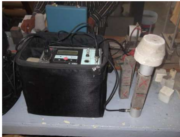
Ilustración 51. Equipo de velocidad de pulso ultrasónico, marca CONTROLS, modelo 58-E0049/B.
