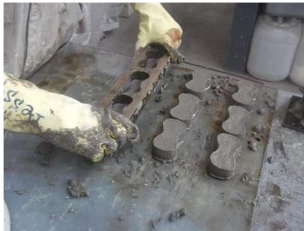
Ilustración 42. Elaboración de Briquetas.
