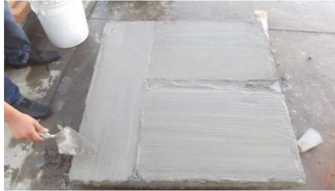
Ilustración 46. Colocación de la mezcla de Poliestirenos en sus tres porcentajes.
