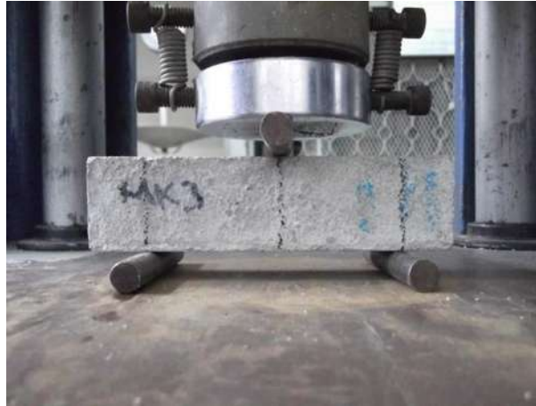
Ilustración 60. Prueba de flexión se realizó utilizando la máquina universal Tinius Olsen.
