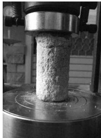
Ilustración 81. Espécimen de MK sometido a compresión 2º Ciclo.
