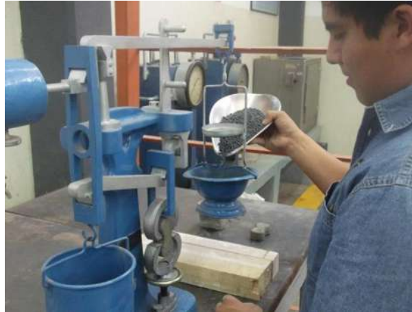
Ilustración 62. Aplicación de la carga lentamente por medio de las municiones hasta la presencia de falla en la briqueta.
