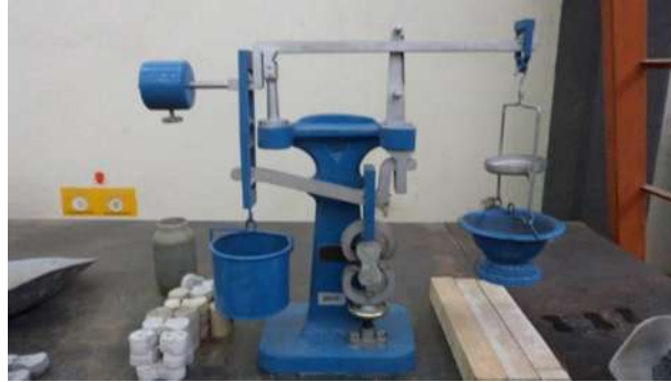
Ilustración 61. Máquina Michaelis para prueba a tensión en briquetas.
