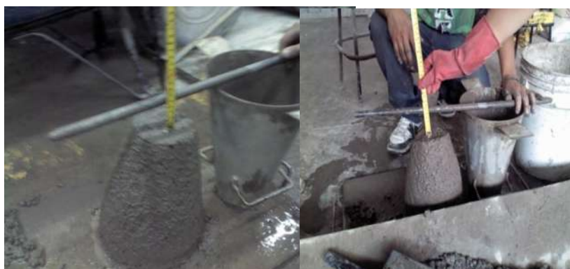
Ilustración 35.a Revenimiento de la mezcla realizada con baja relación agua/cemento Ilustración 30.b Revenimiento de la mezcla testigo.
