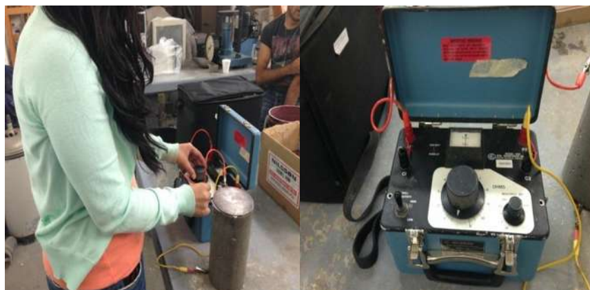
Ilustración 23 Toma de la lectura para la prueba de resistividad eléctrica
