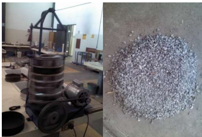
Ilustración 12 Maquina raf-Tap y dimensionamiento del agregado Fino.
