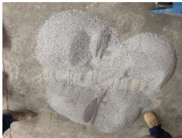
Ilustración 6 Cuarteo en Arenas
