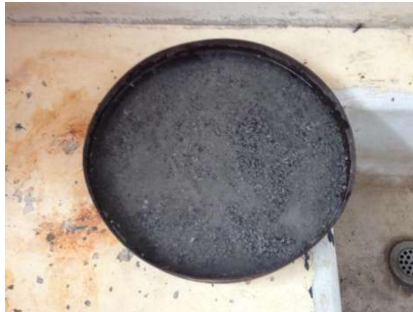
Ilustración 11 Muestra de agregados Finos totalmente Saturada.
