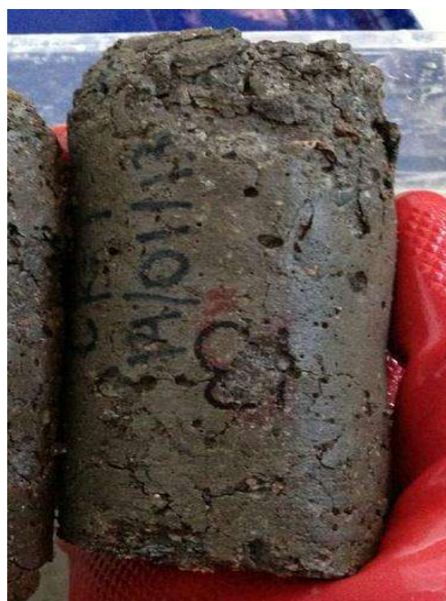
Ilustración 51 Comparativa de los especímenes con baja relación agua / cemento (izquierdo) y especímenes testigos (derecho) después de su Quinto ciclo en solución de sulfato.
