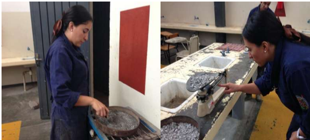
Ilustración 14 Secado y pesado de la muestra para la obtención de la Masa seca en gramos.
