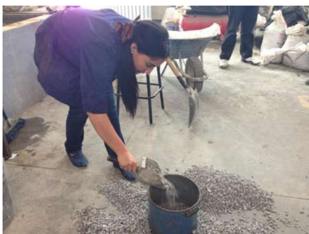
Ilustración 15 Llenado del recipiente para la obtención de M.V.S.S. de agregados gruesos.
