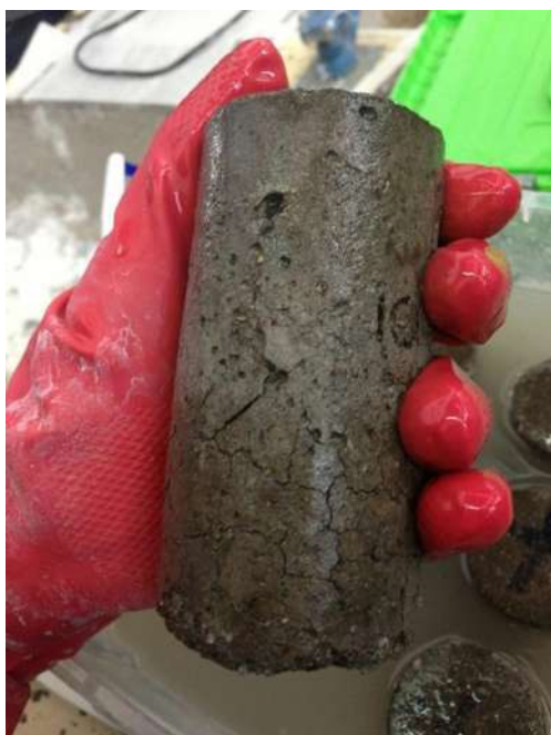
Ilustración 49 Comparativa de los especímenes con baja relación agua / cemento (izquierdo) y especímenes testigos (derecho) después de su Tercer ciclo en solución de sulfato.
