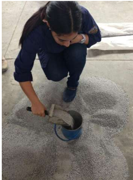
Ilustración 9 Llenado del Recipiente para la obtención de M.V.S.S del agregado Fino.
