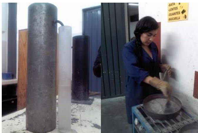
Ilustración 17 De lado izquierdo se muestra el picnómetro, de lado derecho el secado del agregado fino.
