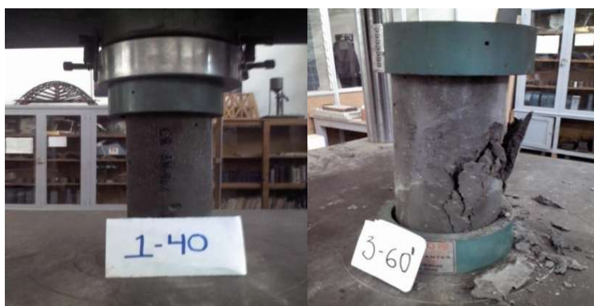
Ilustración 33 Prueba de Compresión a Especímenes con 40% y 60% de sustitución de agregado fino reciclado por agregado natural de río.
