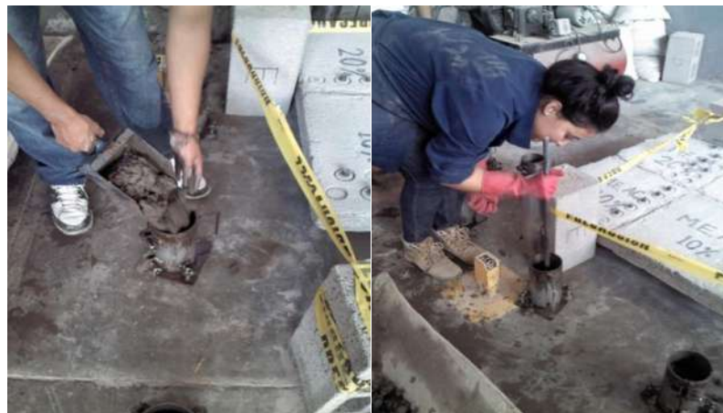
Ilustración 19 Llenado y varillado de los cilindros de 10 x 20 cm.
