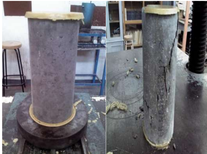
Ilustración 22 Cabeceado en cilindros de 10cm x 20 cm y modos de fallas del mismo cilindro después de que se le aplico una carga axial.
