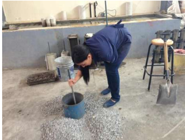
Ilustración 16 Varillado para la obtención de la M.V.S.V en agregados Grueso.
