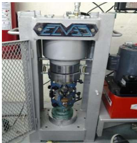
Ilustración 29 Prueba para Determinar el Modulo de Elasticidad a especímenes de 10x20 cm.
