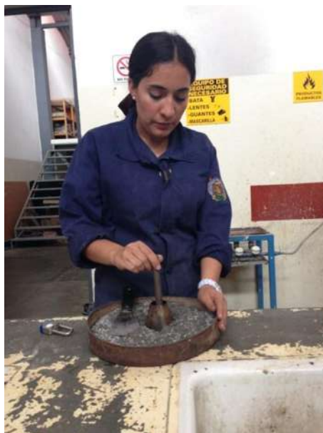
Ilustración 8 Secado Superficial del Agregado Fino
