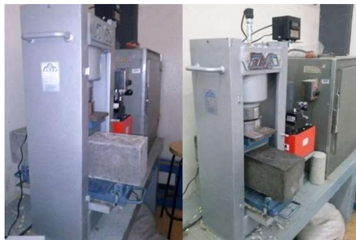
Ilustración 28 Aplicación de la Carga a Vigas de 15x60 cm.
