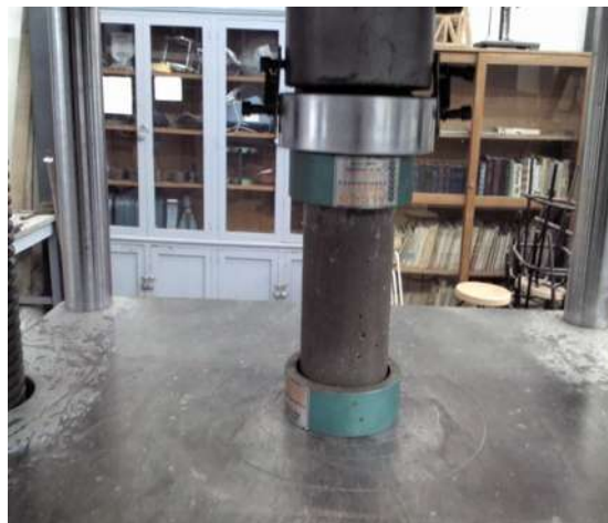
Ilustración 27 Aplicación de Carga al espécimen Testigos de 10 x 20 cm.
