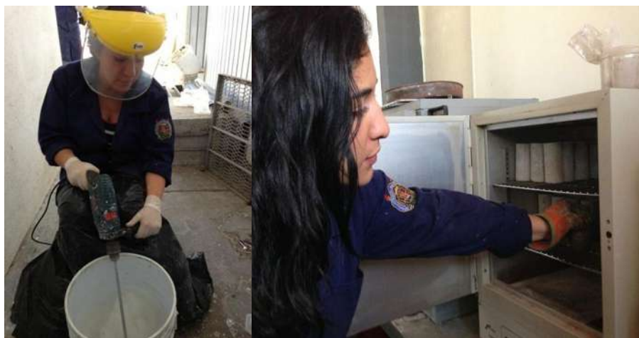
Ilustración 30 Elaboración de la solución de sulfato, Secado de los especímenes a horno.
