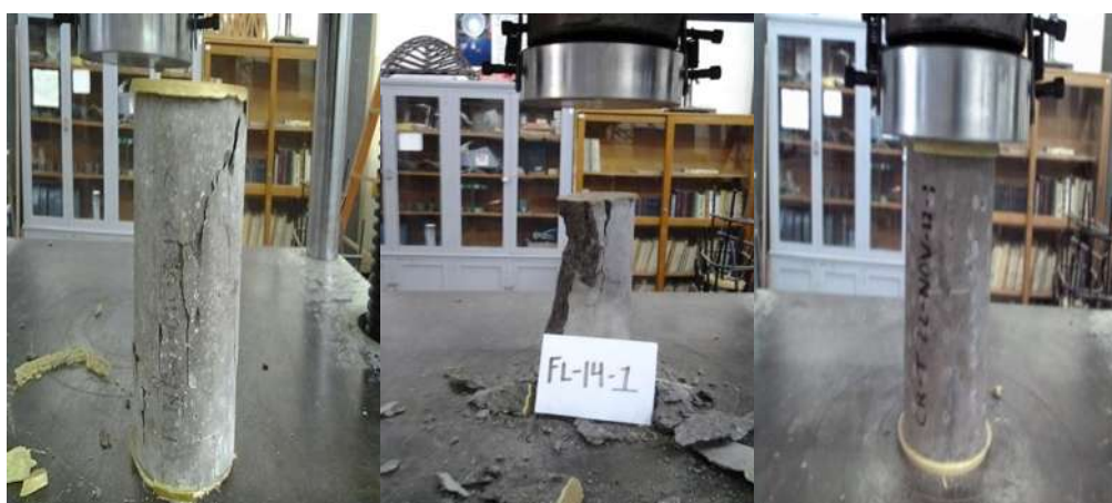
Ilustración 41 Prueba a compresión a especímenes Testigos y especímenes con baja relación agua/cemento.
