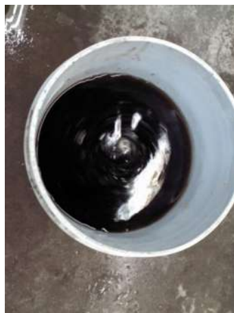
Ilustración 1 fluidificante CRISOTAN R-5 homogenizado en el agua para la elaboración de cilindros 10 cm x 20 cm
