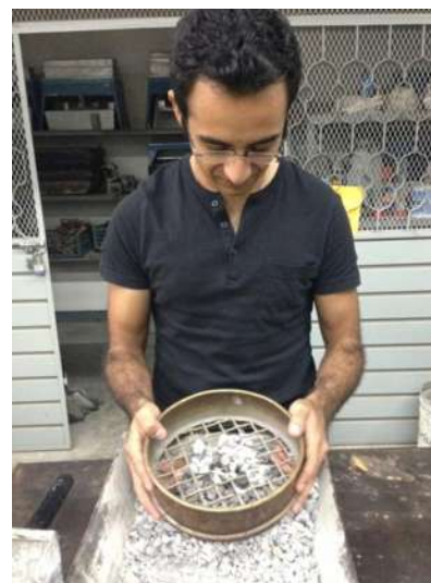
Figura 24. Cribado del agregado grueso.
