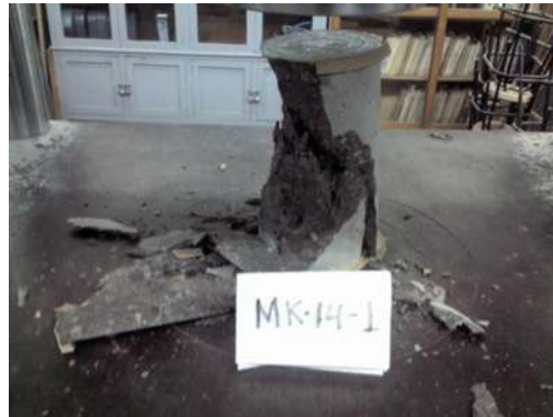
Figura 31. Prueba de resistencia a la compresión.
