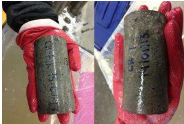
Figura 49. Ataque por sulfatos segundo ciclo.(Izquierda Metacaolín, derecha Testigo).
