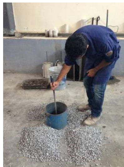
Figura 23. Varillado del agregado grueso.
