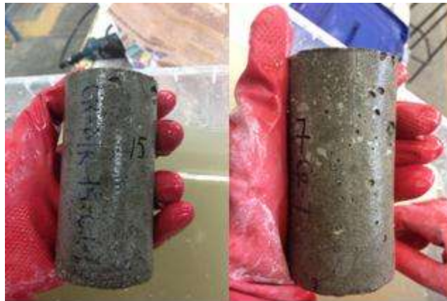
Figura 50. Ataque por sulfatos tercer ciclo (Izquierda Metacaolín, derecha Testigo).
