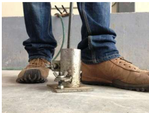
Figura 28. Elaboración de especímenes cilíndricos 5x10cm.
