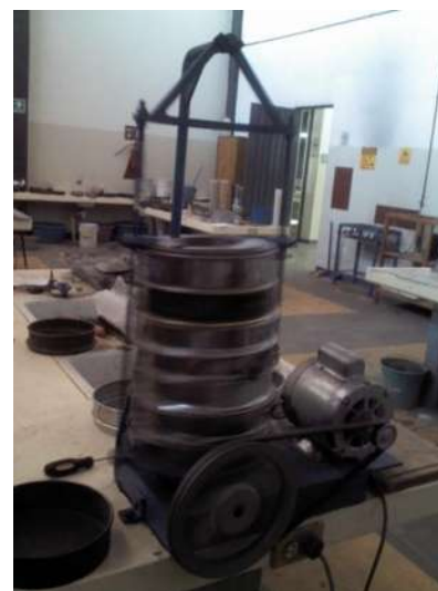
Figura 16. Ensayo granulométrico en arena.
