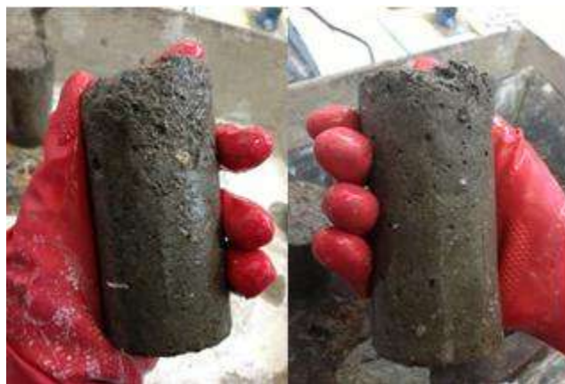
Figura 51. Ataque por sulfato cuarto ciclo (izquierda Metacaolín, derecho testigo)
