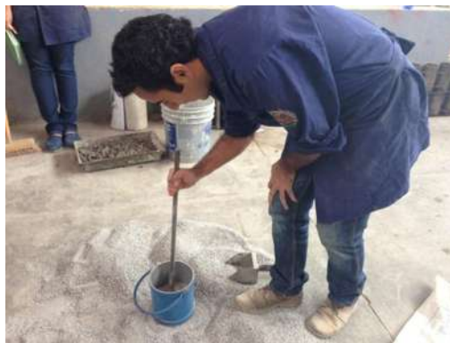
Figura 14. Varillado de la arena reciclada (M.V.S.V)
