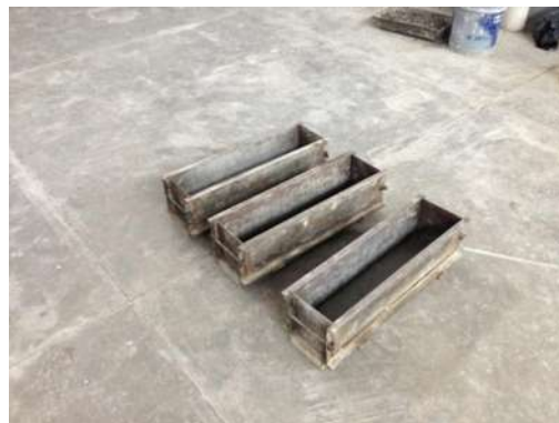
Figura 27. Moldes para vigas 15x60cm.
