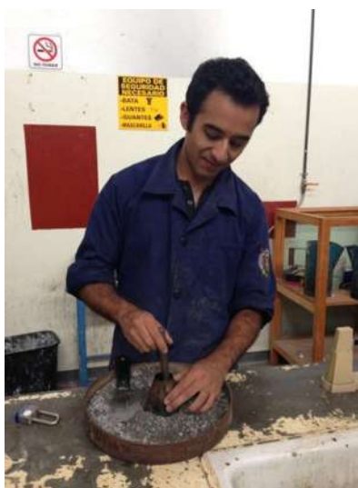
Figura 10. prueba de secado superficial con molde troncocónico.
