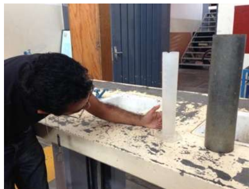
Figura 11. Prueba de densidad en arenas con picnómetro.
