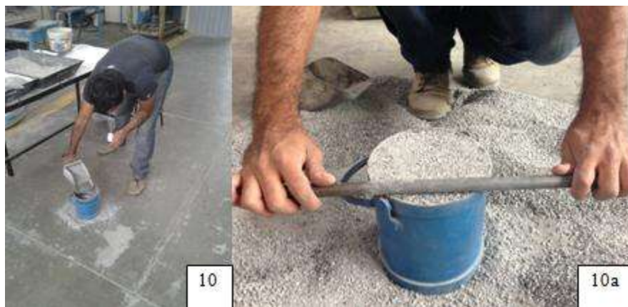
Figura 12. Vaciado de la arena al recipiente.; 10a. Enrasado del recipiente (M.V.S.S).
