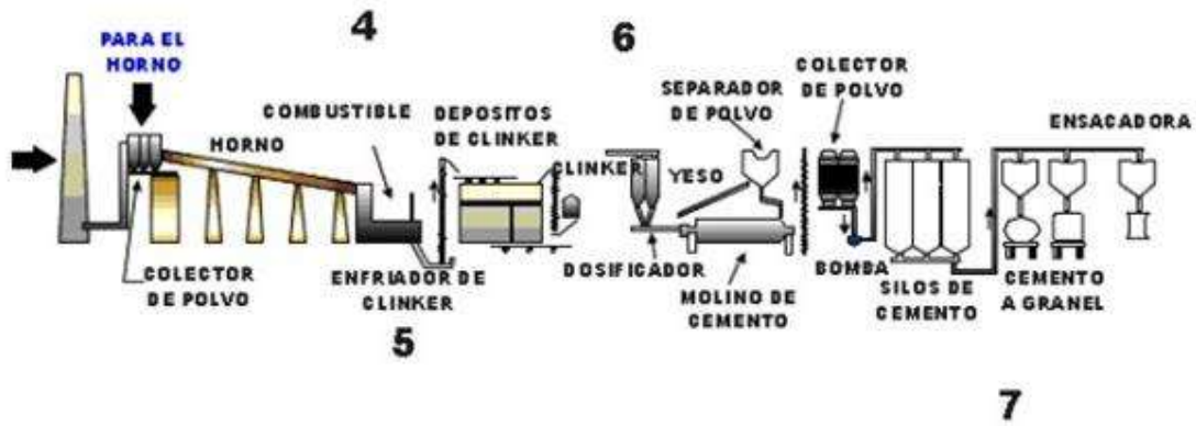
Figura 2. Fabricación del cemento fase 2.
