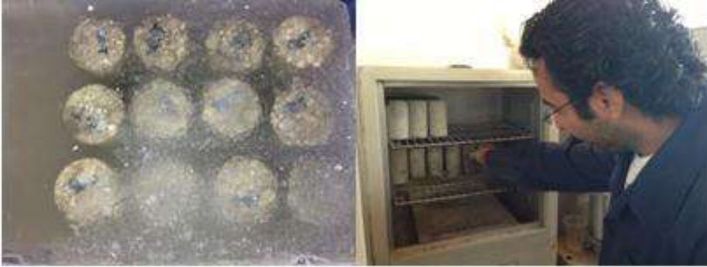
Figura 35. Especímenes sumergidos y en horno para la determinación de los ataques por sulfatos.
