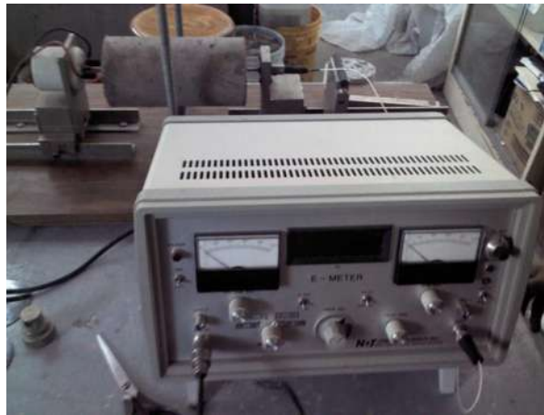
Figura 4. Sonómetro para determinar la frecuencia de resonancia
