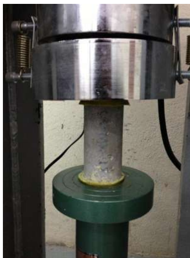
Figura 48. Prueba a compresión simple primer ciclo sulfatos (cilindros 5cm x 10cm).
