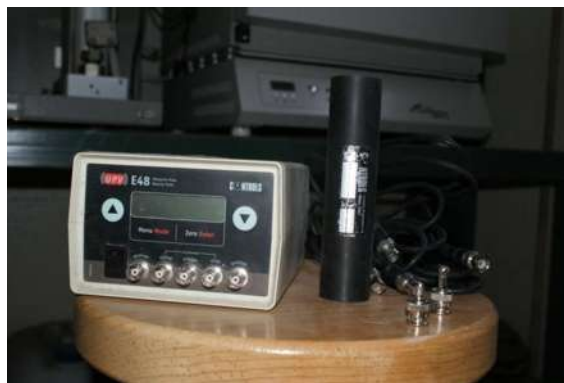
Figura 29. Aparato de medición de velocidad de pulso ultrasónico.
