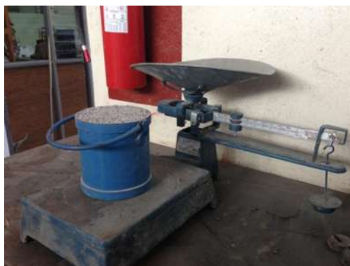
Figura 13. Pesado de agregado fino reciclado (M.V.S.S).
