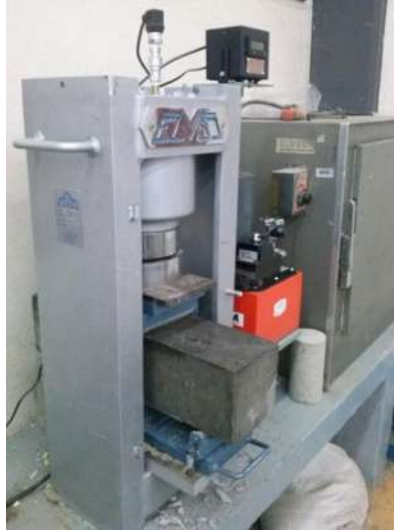
Figura 32. Prueba de resistencia a la flexión.
