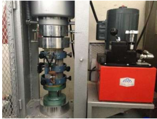
Figura 33. Determinación del módulo de elasticidad estático.
