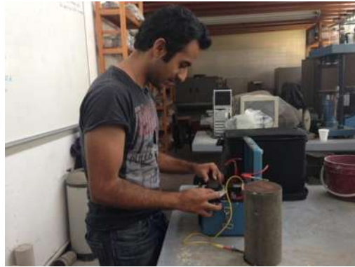
Figura 30. Medición de la resistividad.
