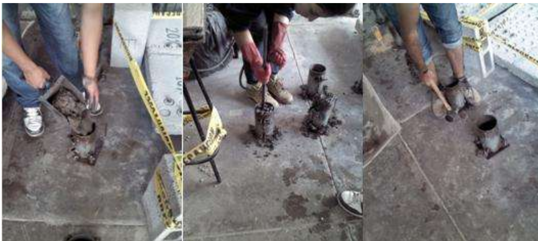
Figura 26. Elaboración de cilindros de 10x20cm.
