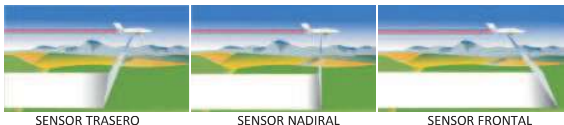
Fig. IIIb.- Ángulos de escaneo sistema lidar.
