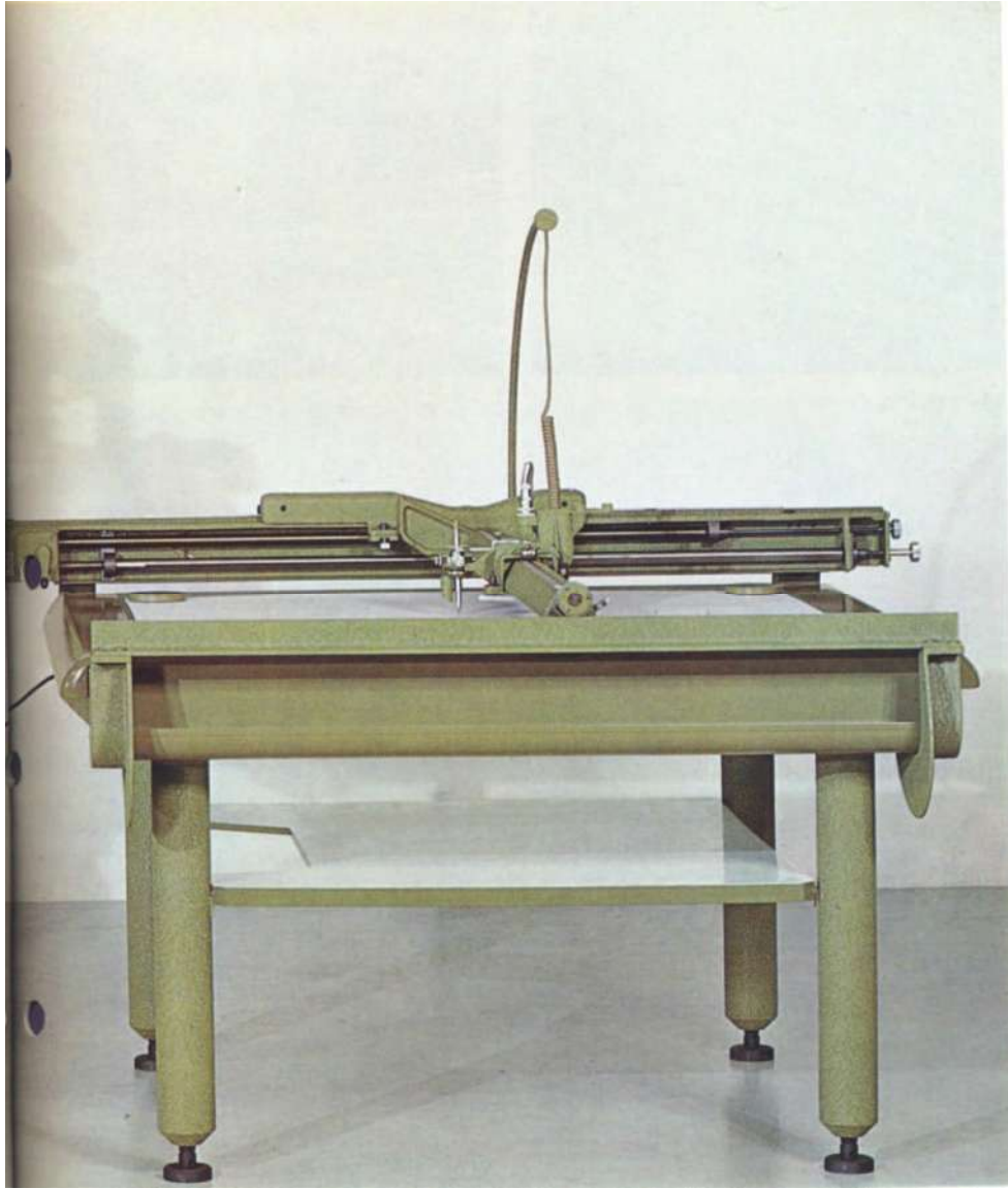
El autógrafo Wild A8 destinado para hacer mapas en escalas entre 1:20,000 y 1:1000 Dada su capacidad y gran precisión.
