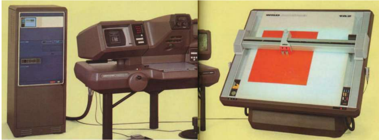
Fig. IVb.- Aviotab TA2 Forma un eficaz sistema de restitución estereométrica con mando por ordenador para cualquier tarea de restitución en la práctica fotogramétrica. Mesa de dibujo y pantógrafo.
