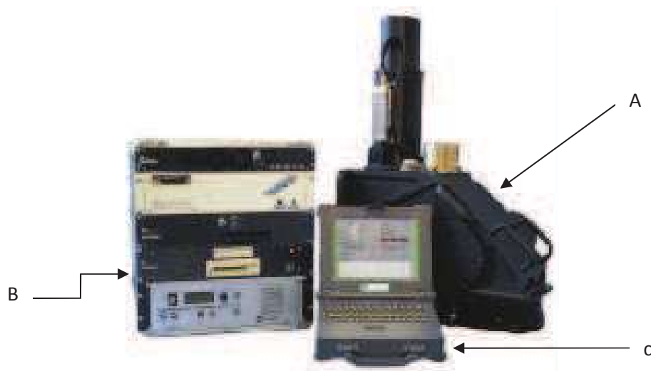
Fig.IIIg.- Componentes del sensor LH ALS40 (leyenda en el texto)
