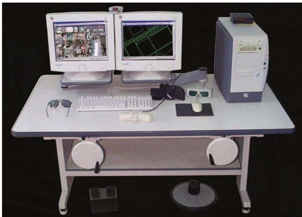
Fig. IVe.- ESTACIÓN FOTOGRAMÉTRICA DIGITAL, Manivelas y Pedales con precisión de 1 micron.
