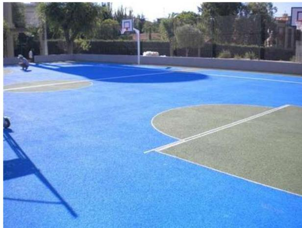
Figura 277. Pista deportiva. (PAVIMENTOS DE HORMIGÓN POROSO – HYDROMEDIA™, Efficient Building™ system, 8.2.2 – CAMINOS Y PAVIMENTOS, ESPAÑA, Marzo 2013.) Consultada el 26 de septiembre del 2013.
