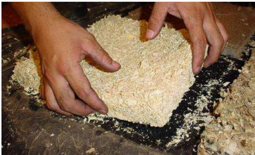
Figura 161. Probeta de 0-100% urea formaldehído – bajo sin poder de adhesión, desgranándose en la mano. (Celano, Jorge A. – Jacobo, Guillermo J. – Pereyra, Obdulio. Desarrollo de paneles termoacústicos a base de residuos de madera para el mercado de la construcción, UNIVERSIDAD NACIONAL DEL NORDESTE Comunicaciones Científicas y Tecnológicas 2006) consultada el 19 de septiembre del 2013.
