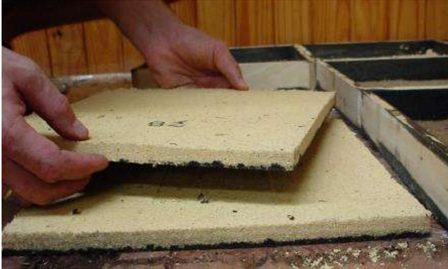
Figura 162. Probeta 0-100% adhesivo D3 – alto, de buena constitución y cohesión con mediana contracción plasticidad sin desgranamiento. (Celano, Jorge A. – Jacobo, Guillermo J. – Pereyra, Obdulio. Desarrollo de paneles termoacústicos a base de residuos de madera para el mercado de la construcción, UNIVERSIDAD NACIONAL DEL NORDESTE Comunicaciones Científicas y Tecnológicas 2006) consultada el 19 de septiembre del 2013.
