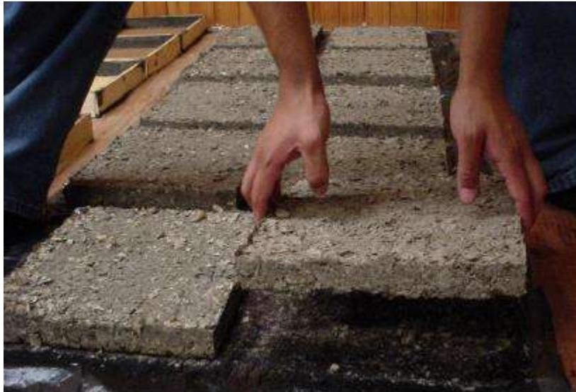
Figura 160. Desmolde de probeta de 50-50% cemento – alto de fácil de manipulación. (Celano, Jorge A. – Jacobo, Guillermo J. – Pereyra, Obdulio. Desarrollo de paneles termoacústicos a base de residuos de madera para el mercado de la construcción, UNIVERSIDAD NACIONAL DEL NORDESTE Comunicaciones Científicas y Tecnológicas 2006) consultada el 19 de septiembre del 2013.
