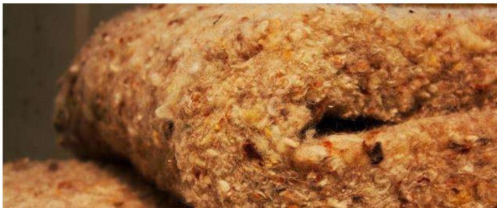
Figura 169. Espuma de vidrio (lana de vidrio). (<http://www.mimbrea.com/guia-practica/materiales-aislantes-fabricados-con-productos-reciclados>) consultada el 19 de septiembre del 2013.
