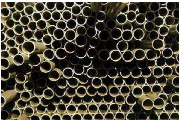
Figura 252. Tubos de CPVC. (<http://www.ehowenespanol.com/diferencia-tubos-pvc-cpvc-sobre-171008/#/caracteristicas-tuberias-cpvc-info-271351/>) consultada el 26 de septiembre del 2013.
