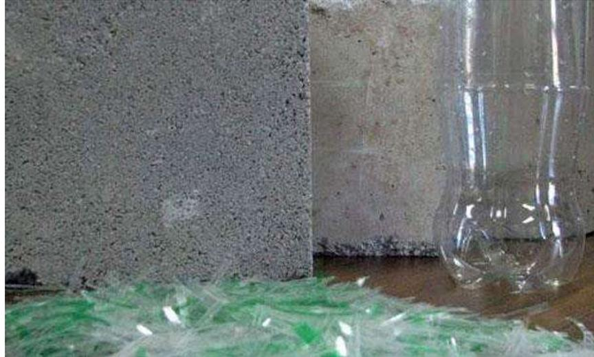
Figura 126. Utilizando este mismo material, hace un par de años, un alumno de la UAQ desarrolló un tabique reforzado con PET. Cada construcción realizada con este tipo de material podría permitir aprovechar unas 4 mil botellas de plástico.
