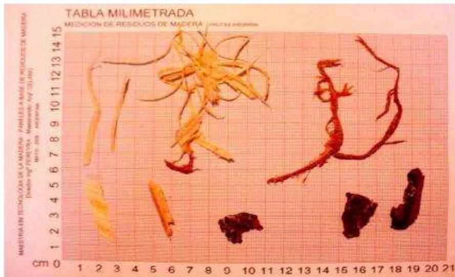
Figura 157. Caracterización de residuos según morfología, granulometría y densidad. (Celano, Jorge A. – Jacobo, Guillermo J. – Pereyra, Obdulio. Desarrollo de paneles termoacústicos a base de residuos de madera para el mercado de la construcción, UNIVERSIDAD NACIONAL DEL NORDESTE Comunicaciones Científicas y Tecnológicas 2006) consultada el 19 de septiembre del 2013.
