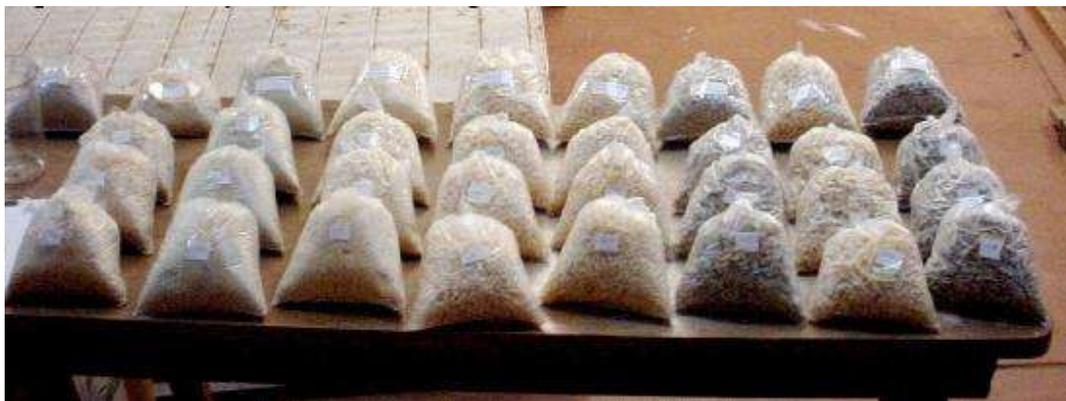
Figura 156. Acopio en 4 muestras por tipo de residuo. (Celano, Jorge A. – Jacobo, Guillermo J. – Pereyra, Obdulio. Desarrollo de paneles termoacústicos a base de residuos
