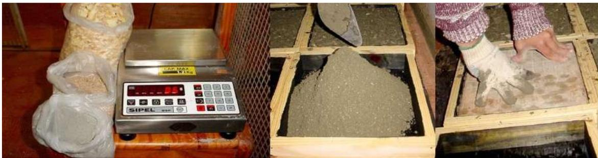
Figura 158. Dosificación de materiales por peso. Vertido de mezcla en molde. Presión de armado. (Celano, Jorge A. – Jacobo, Guillermo J. – Pereyra, Obdulio. Desarrollo de paneles termoacústicos a base de residuos de madera para el mercado de la construcción, UNIVERSIDAD NACIONAL DEL NORDESTE Comunicaciones Científicas y Tecnológicas 2006) consultada el 19 de septiembre del 2013.
