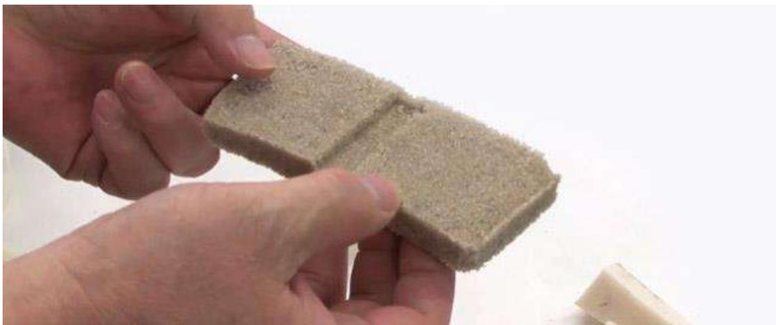
Figura 101. Ladrillos que absorben el CO<sub>2</sub>.
