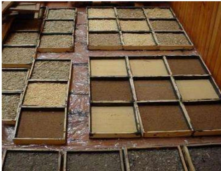
Figura 159. Variabilidad de texturas y colores según la mezcla utilizada de MFP y adhesivo. (Celano, Jorge A. – Jacobo, Guillermo J. – Pereyra, Obdulio. Desarrollo de paneles termoacústicos a base de residuos de madera para el mercado de la construcción, UNIVERSIDAD NACIONAL DEL NORDESTE Comunicaciones Científicas y Tecnológicas 2006) consultada el 19 de septiembre del 2013.
