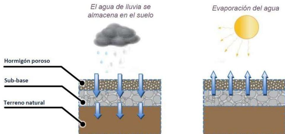
Figura 278. Sistema permeable Hydromedia™. (PAVIMENTOS DE HORMIGÓN POROSO – HYDROMEDIA™, Efficient Building™ system, 8.2.2 – CAMINOS Y PAVIMENTOS, ESPAÑA, Marzo 2013.) Consultada el 26 de septiembre del 2013.
