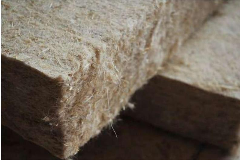
Figura 176. Fibras de madera. (<http://www.mimbrea.com/guia-practica/materiales-aislantes-fabricados-con-productos-reciclad0s>) consultada el 19 de septiembre del 2013.
