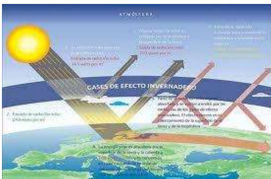
Figura 2.29.1. Efecto invernadero, causa del calentamiento global [83].
