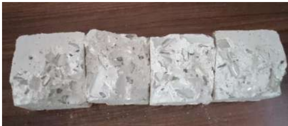
Imagen 5.5. En esta prueba la mezcla de adhirió bastante al molde por lo cual tuve que desmoldar como fuera posible [propia].
