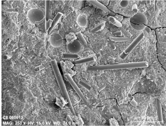
6) Burbujas de látex en conjunto con la fibra molida vista en filamentos, 250x [SEM].
