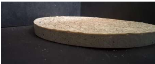
Imagen 4.32. La coloración es debido al polvo de vidrio color ámbar [propia].
