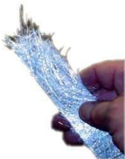
Figura 2.10.0.1. La fibra de vidrio es la resultante de mezclar la malla de vidrio con una resina epoxi [23].
