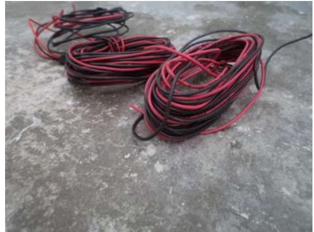
Imagen 6.20. El cable es necesario para hacer las conexiones entre los Led's, es un cable delgado y preferentemente debe ser alambre [propia].
