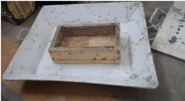
Imagen 3.23. Los tamices son de madera armados manualmente [propia].
