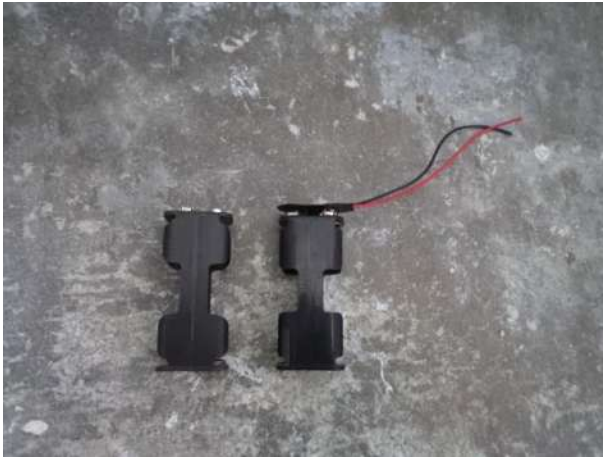
Imagen 6.19. El porta baterías (para AA de 3 V) es un aditamento necesario para hacer las pruebas pero se puede utilizar en caso de no tener corriente eléctrica directa [propia].
