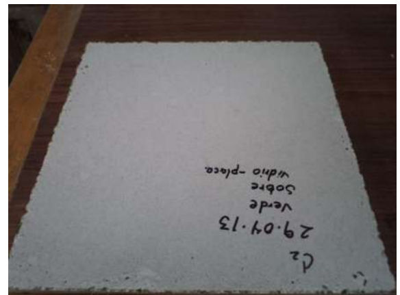
Imagen 5.15. En esta placa fue colocada una placa de vidrio y al derramar el material por los lados provocó fragilidad en las orillas [propia].
