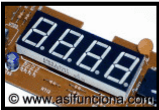
Figura 2.20.10. Display de matriz de diodos numérica, muy utilizada para mostrar la frecuencia sintonizada en los radiorreceptores o mostrar la hora en los relojes digitales [76].
