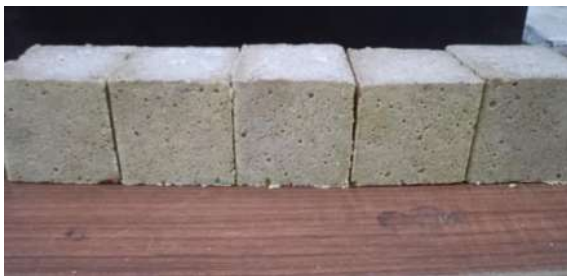
Imagen 5.73. Los finos en conjunto con los demás agregados tienen buena fusión [propia].
