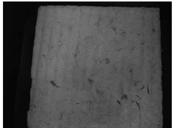
Imagen 4.0.28. Al introducirla al horno para el recalentamiento la placa adopta la forma de la rejilla de soporte del horno [propia].
