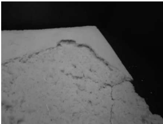
Imagen 4.0.31. Se aprecia la porosidad que forma internamente la prueba, pensando que la causante de este problema es la fibra de vidrio [propia].
