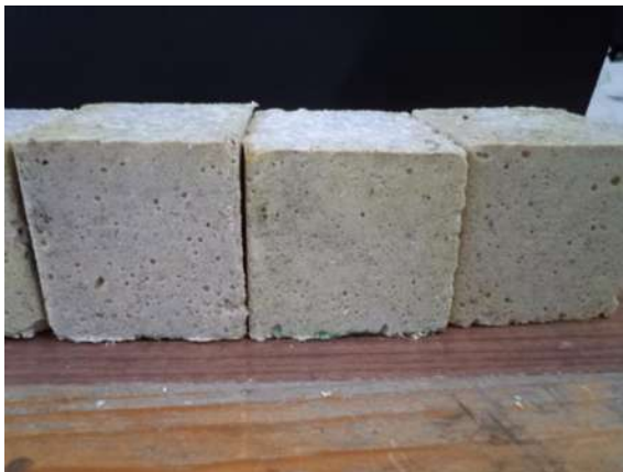
Imagen 5.63. Sigue habiendo buena adherencia entre los componentes de la mezcla [propia].
