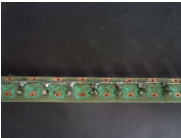
Imagen 6.46. Los circuitos que van ligados se unen con soldadura de estaño y aluminio, así como un fundente y la ayuda de un cautín [propia].
