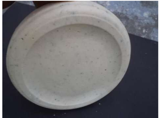
Imagen 6.28. La muestra toma la forma del contenedor, y obtiene buen aspecto [propia].
