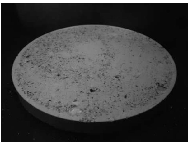
Imagen 4.52. De nuevo el látex interfiere en este tipo de composiciones presentándose en la superficie [propia].
