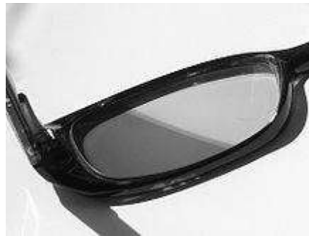
Figura 2.6.1.5. Lente fotocromática para gafas. La coloración se consigue con nanopartículas de plata [18].
