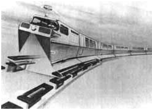
Figura 2.22.2. Dibujo que muestra un tren levitado por campos magnéticos producidos por corrientes superconductoras [58].
