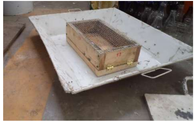
Imagen 3.24. Se granulometreará el vidrio para realizar las pruebas respectivas y que el tamaño no sea un problema [propia].
