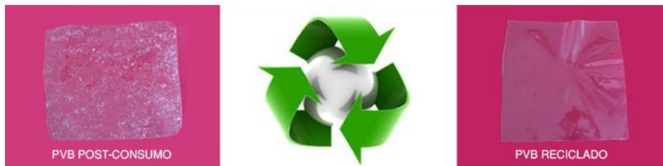
Figura 2.19.1.2. Diferencia entre un PVB usado y el resultado después de su reciclado [50].
