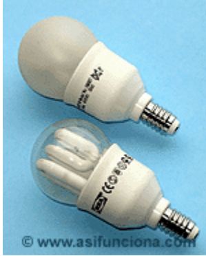
Figura 2.20.5. Lámpara CFL con casquillo de rosca. La variedad de lámparas disponibles de este tipo y los diferentes casquillos y conectores con que se pueden encontrar en el mercado facilita que cualquier lámpara incandescente se pueda sustituir por una CFL sin necesidad de cambiar el portalámparas [76].
