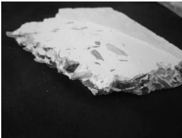
Imagen 6.17. Se aprecian embebidos los fragmentos de vidrio en la mezcla, se nota que el vidrio se distribuye uniformemente [propia].
