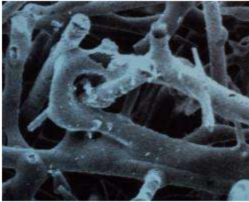
Figura 2.12.1.3. Nanoporos de la estructura interna del aerogel [33]. La conducción de volumen a través de los sólidos es por lo tanto muy baja, el 97% restante del volumen está compuesto de aire en nanoporos, es decir, de medidas nanométricas. El aire tiene poco espacio para moverse, lo cual inhibe tanto la convección como la conducción de la fase gaseosa. Estas características hacen que el aerogel sea el sólido de más baja densidad del mundo y el aislamiento térmico más eficaz.
