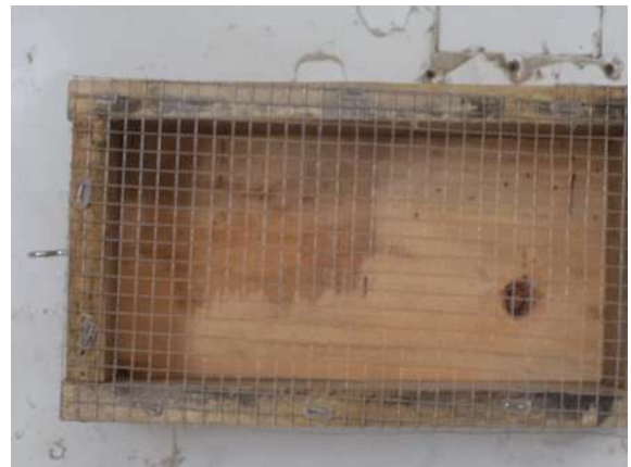
Imagen 3.26. Posteriormente se pasará por otra malla de menor abertura para separar los finos (polvo de vidrio) [propia].
