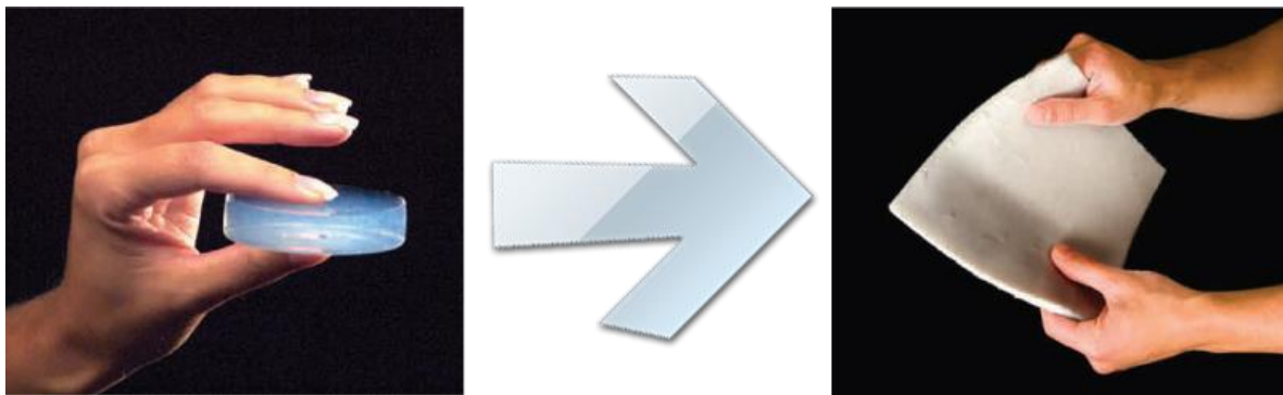
Figura 2.12.1.4. Aislamiento industrial flexible con barrera integral de vapor para aplicaciones criogénicas y sub-ambientales [33].
