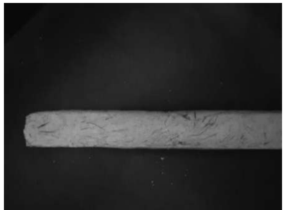
Imagen 4.0.23. La fibra de vidrio sería un refuerzo a la tensión, y la fibra de carbono se utilizó como conductor eléctrico [propia].
