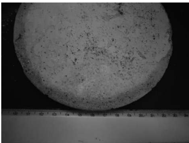
Imagen 4.52. De nuevo el látex interfiere en este tipo de composiciones presentándose en la superficie [propia].
