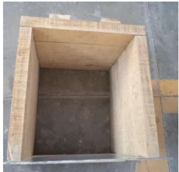
Imagen 3.19. Vista superficial o aérea del cajón ya que no tiene base, y lo que se uso o como base sólida fue la placa metálica [propia].
