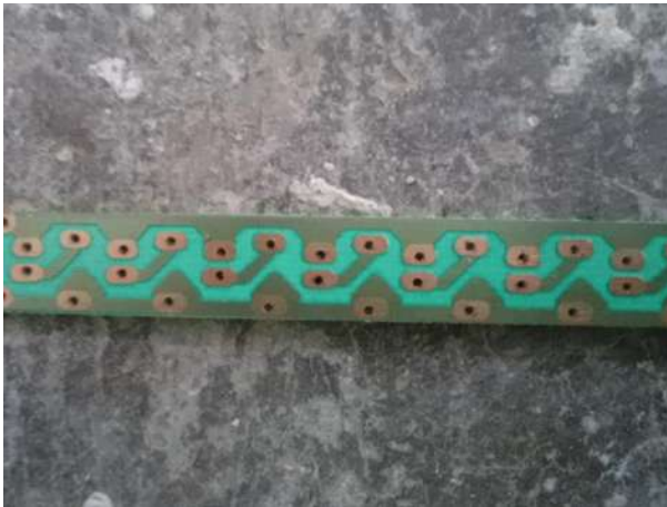
Imagen 6.23. Las tiras de circuitos impresos son indispensables para que los leds no se muevan y permanezcan en su lugar así como para transmitir la corriente, aunque esto último como segunda opción [propia].
