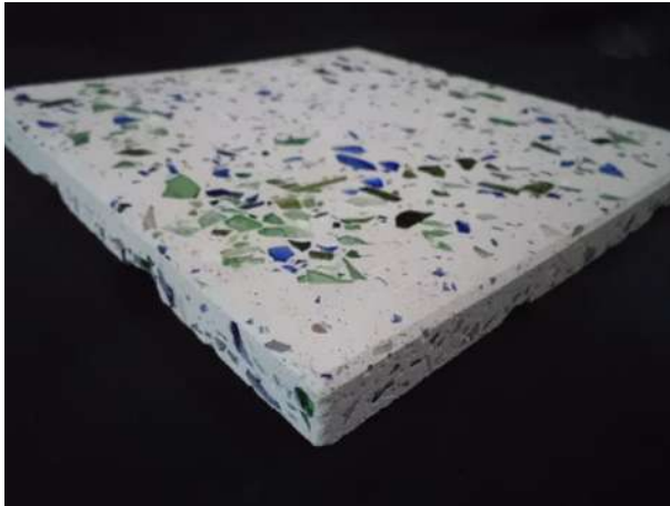
Imagen 6.9. La loseta soporte fácilmente el pulido [propia].
