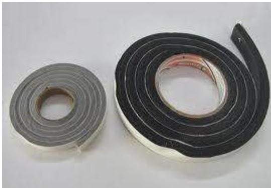
» Figura 2.22.5. Vinilo: tienen como función principal aislar y empalmar cables de baja tensión (usualmente máximo hasta 600 Volts). También son usados como respaldo y protección contra UV (instalaciones tipo exterior) en las chaquetas de cables de media tensión [60].
