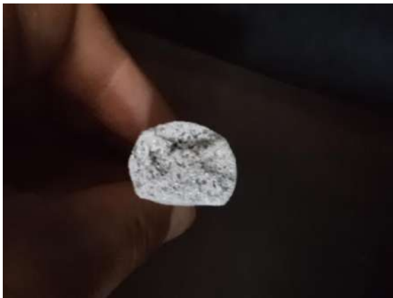
Imagen 4.0.20. Logra verse la porosidad que generan ambas fibras [propia].
