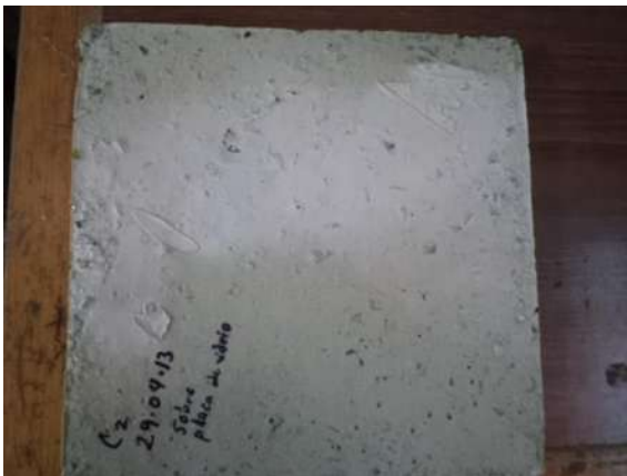
Imagen 5.18. El vibrado genera un buen acabado [propia].
