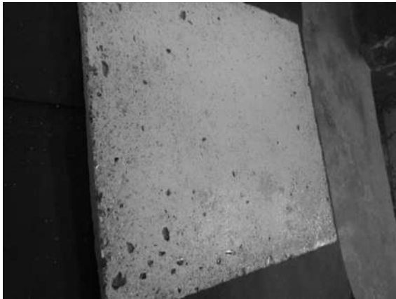
Imagen 5.22. La fuerza de los medio naturales del sol, aire y lluvia lograron que los fragmentos de vidrio grueso afloraran [propia].
