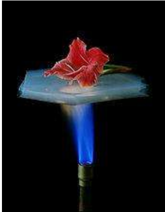
Figura 2.12.0.1 La flor no se consume bajo el fuego del mechero Bunsen debido a las propiedades aislantes del aerogel [33].
