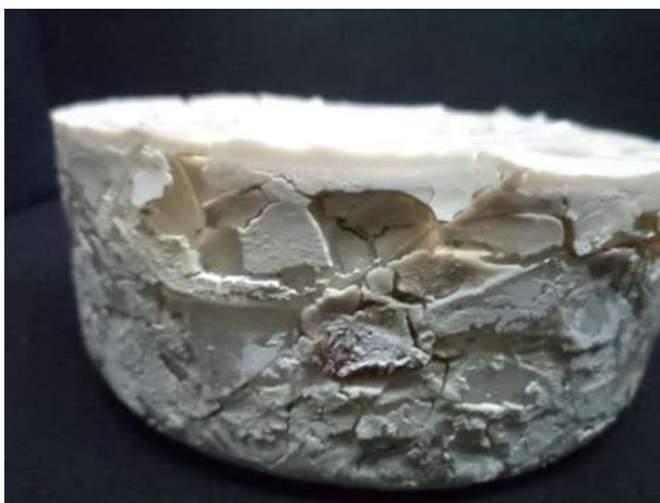
Imagen 4.9. La primer muestra con un adhesivo preparado y adicionando vidrio resultó bastante frágil [propia].
