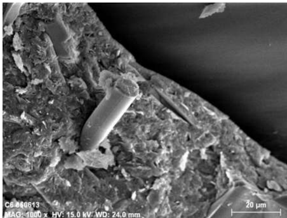
6) Fibra en relación con la mezcla, al fondo un vidrio, 1000x [SEM].
