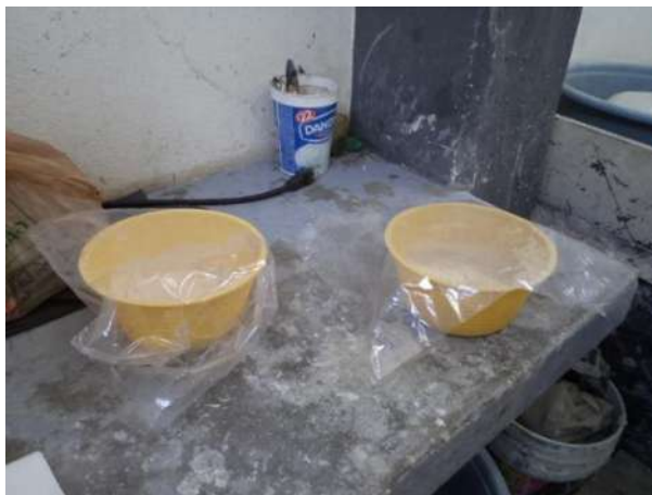
Imagen 6.25. Las pruebas preliminares son para determinar algunas características de la loseta final. Se aprecia uno de los pasos del proceso, el curado, para que la humedad no se vaya por completo [propia].
