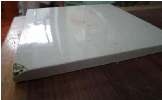
Imagen 5.16. Poco desprendimiento [propia].
