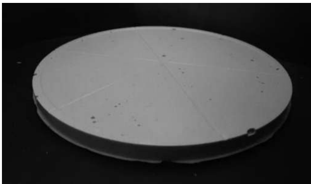
Imagen 4.79. La pastilla es de menor espesor pero es muy estable [propia].
