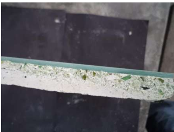
Imagen 5.49. Por espesor es suficiente para evitar fracturas [propia].
