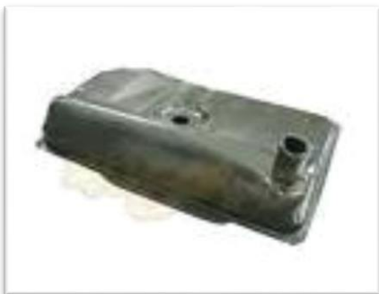
Figura 2.26.3. Tanque de combustible acero con superficies exterior e interior con capa de compuestos epóxicos ricos en aluminio (exterior) y en zinc (interior) [64].
