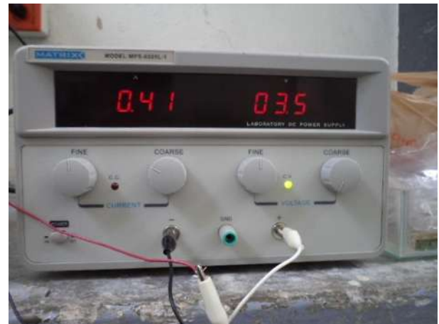
Imagen 6.55. Se incrementa el voltaje para tener mayor luminosidad y mejores resultados y disminuye un poco el amperaje [propia].
