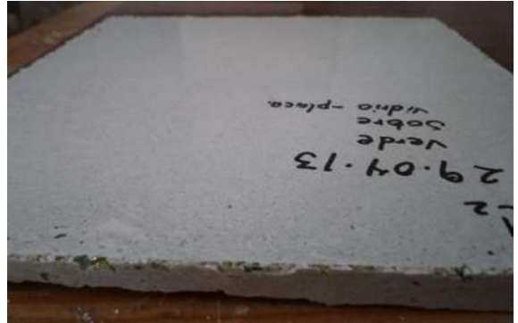
Imagen 5.13. Hay un poco de desprendimiento de material en la orilla pero en general es sólido [propia].
