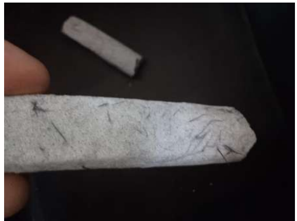
Imagen 4.0.21. La fragilidad no se hace esperar en la prueba [propia].
