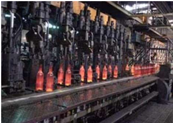
Figura 2.3.1.11. Modelo de botellas salidas de los moldes con maquinaria programada [12].
