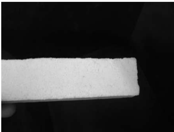
Imagen 4.0.3. Una segunda prueba de la misma composición pero sin recalentamiento logro ser estable [propia].
