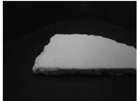
Imagen 4.0.35. La parte en contacto con el molde logra ser lisa a pesar de los poros [propia].
