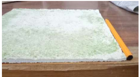
Imagen 5.41. Poco espesor, muy frágil [propia].
