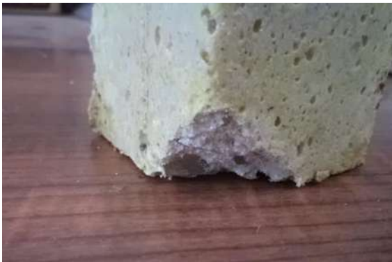
Imagen 5.61. La fibra cortada genera más espacios interiores y provoca un poco de fragilidad [propia].
