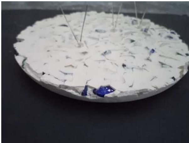
Imagen 6.33. En esta mezcla se prueba con otra composición diferente así como con otro tipo de led, más potentes [propia].
