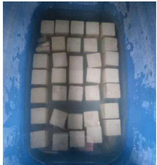
Imagen 5.82. Se coloca suficiente agua para que no les falte durante el tiempo que se dejan dentro [propia].
