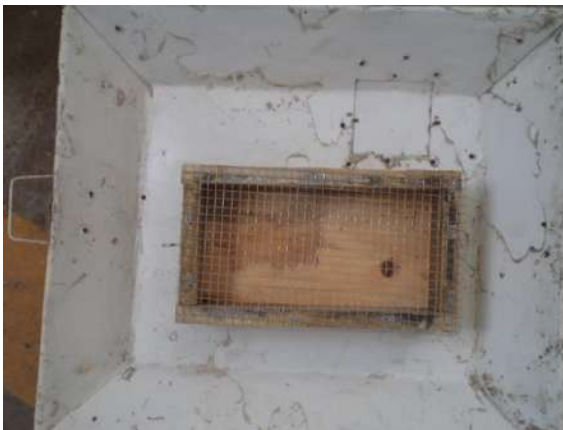
Imagen 3.25. La charola es un factor importante en este proceso para que no se riegue el vidrio triturado [propia].
