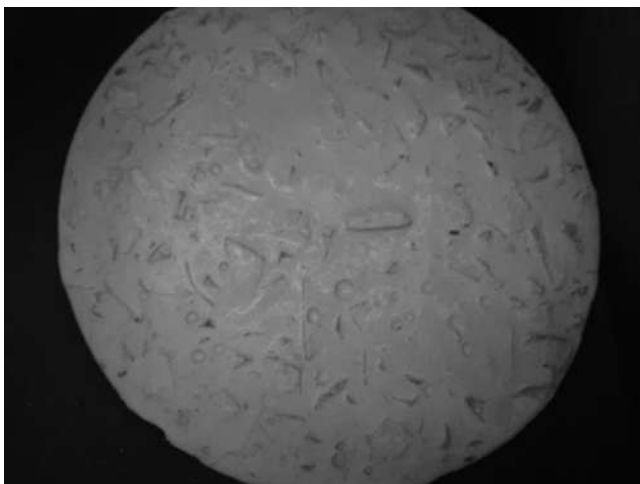
Imagen 4.80. Aflora el vidrio en la superficie [propia].
