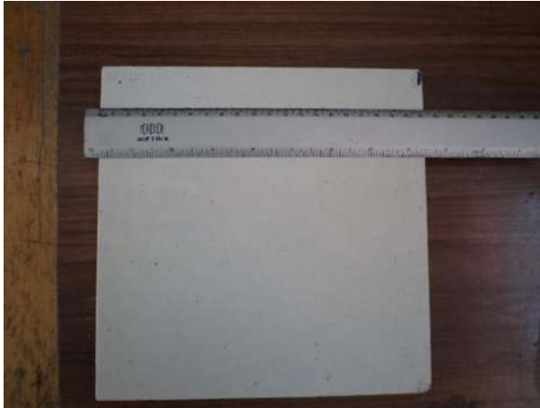
Imagen 6.1. Esta es una loseta cuya composición es la estándar, con marmolinas y un porcentaje de látex con refuerzo [propia].
