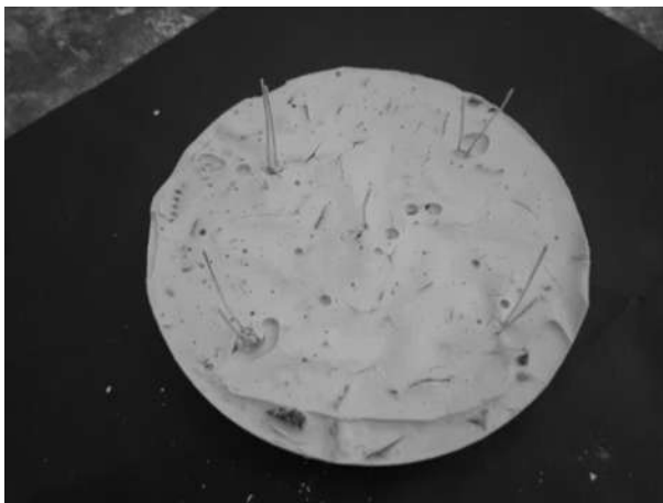
Imagen 6.29. La muestra por la parte superficial, es un poco irregular por el plástico en contacto con la mezcla para el curado [propia].
