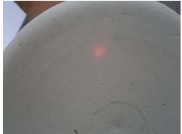
Imagen 6.32. La luz del Led en la parte frontal de la muestra es muy tenue, le falta intensidad para pueda transmitir luz visible [propia].
