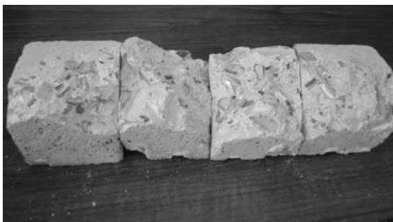
Imagen 5.7. Faltó un poco de lubricante o desmoldante [propia].
