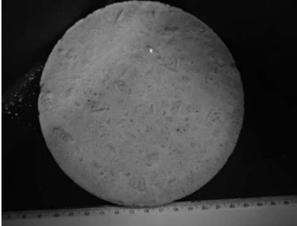
Imagen 4.60. No son buenos los espesores menores de 8 mm [propia].
