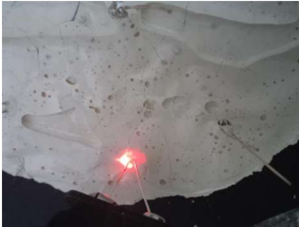
Imagen 6.31. El Led por la parte posterior parece no dar buen resultado, ya que no abarca mucho radio de luminosidad [propia].
