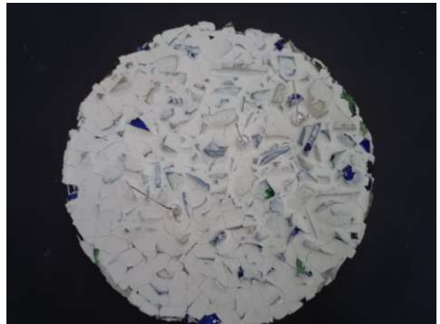
Imagen 6.34. La mezcla no fue la indicada porque se fractura muy fácilmente, sin embargo los leds nos muestran buen resultado [propia].
