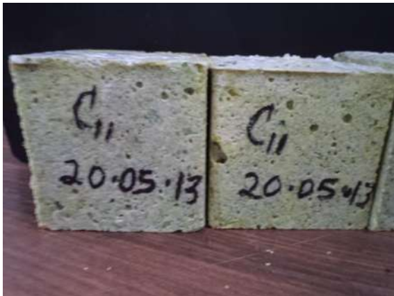
Imagen 5.70. Hay algunos huecos pero no afecta el resto de la muestra [propia].
