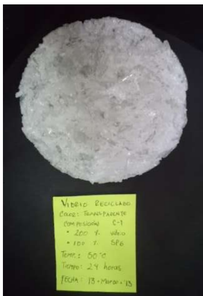
Imagen 4.1. Primera prueba realizada con vidrio de 1 cm de espesor [propia].
