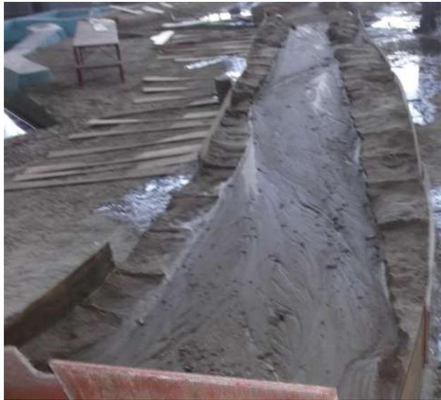
*Imagen 5.9. Modelo deformado por el flujo.*
