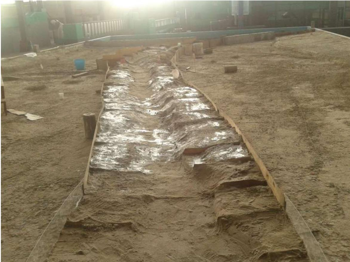
*Imagen 5.21. Vista panorámica del modelo, con paredes estabilizadas.*
