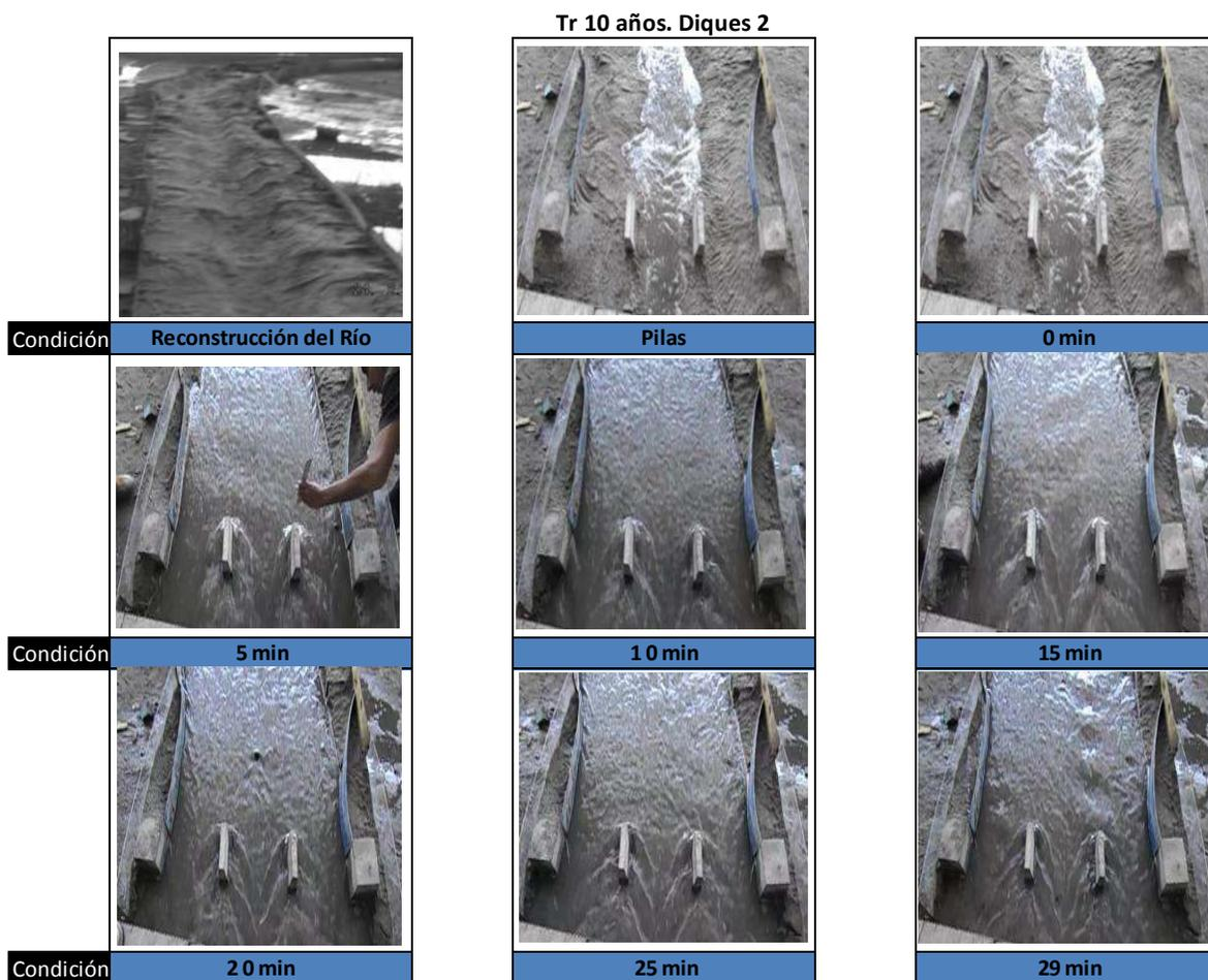
Imagen 5.42. Comportamiento del flujo con las pilas y estribos para  $Tr$  10 años, con diques de encauzamiento.
