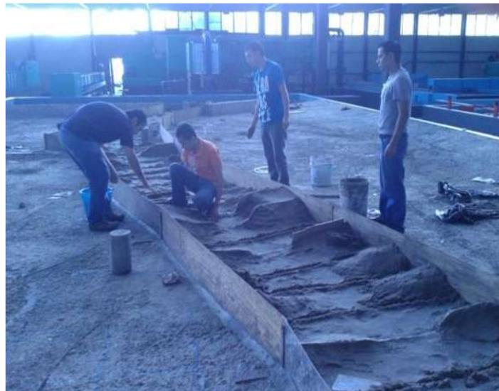
*Imagen 4.13. Colocación de las secciones transversales así como de la arena.*
