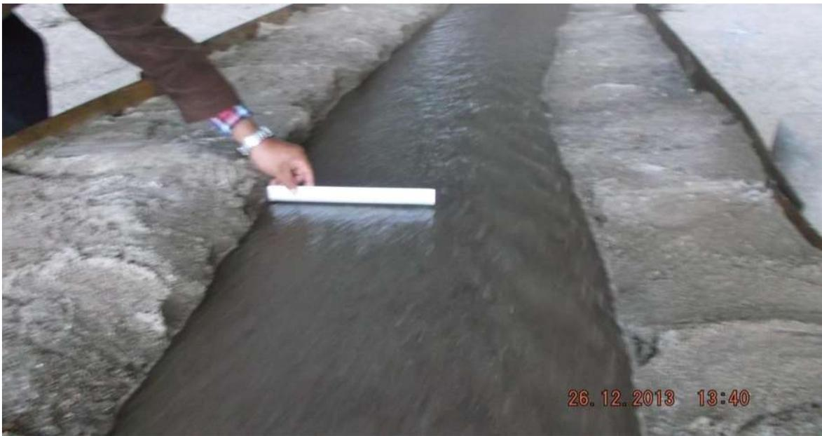
*Imagen 5.16. Medición de la deformación del bordo.*
