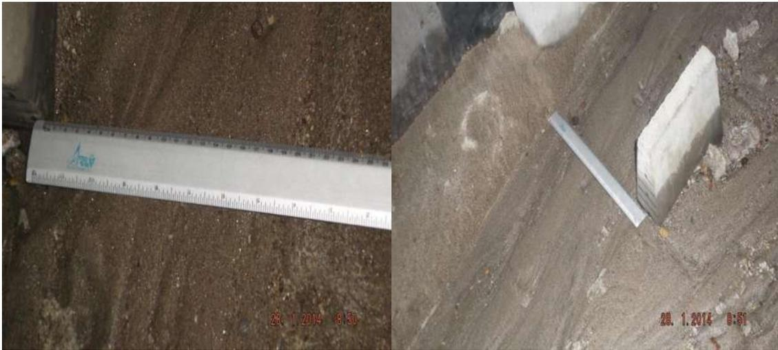
*Imagen 5.28. Medición de la erosión de las paredes con respecto a las pilas.*
