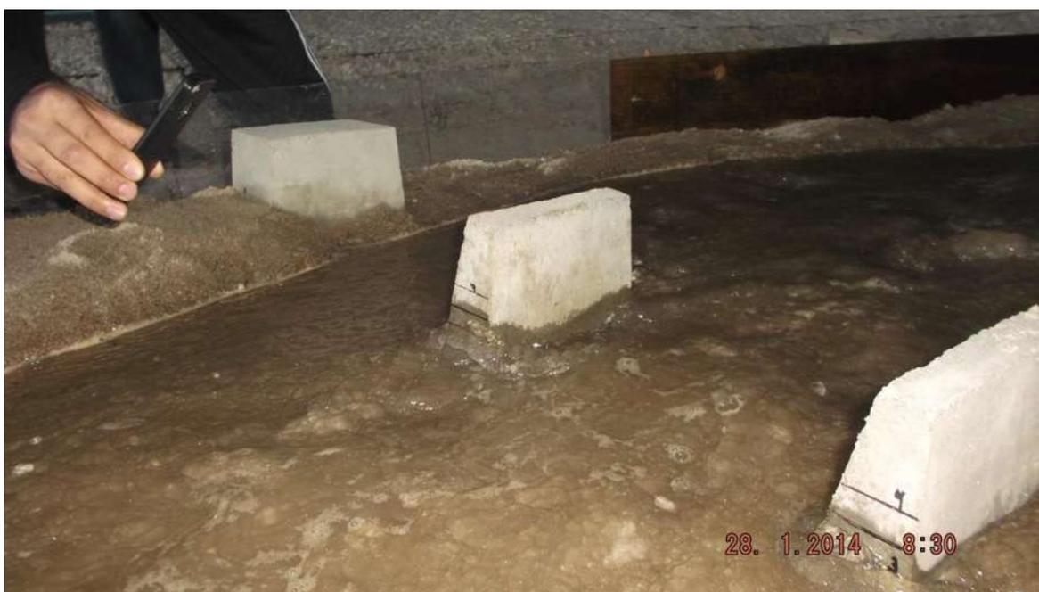
*Imagen 5.27. Estribo 1, y pila 1 y 2. Con flujo circulando entre ellos.*
