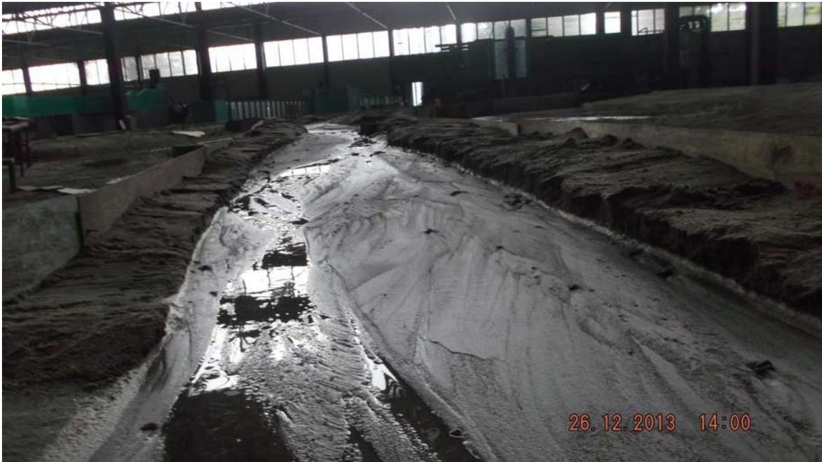
*Imagen 5.19. Deformación después del flujo, alcanzando 1m de extremo a extremo.*
