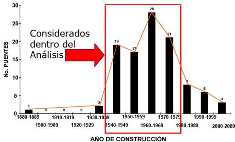
Figura 2.5. Año de construcción de los puentes con trabajos de cauce hasta el 2009. Fuente: Proyecto No. EE17/10. Discriminación de puentes de la DGCC/SCT con alta probabilidad de socavación.
