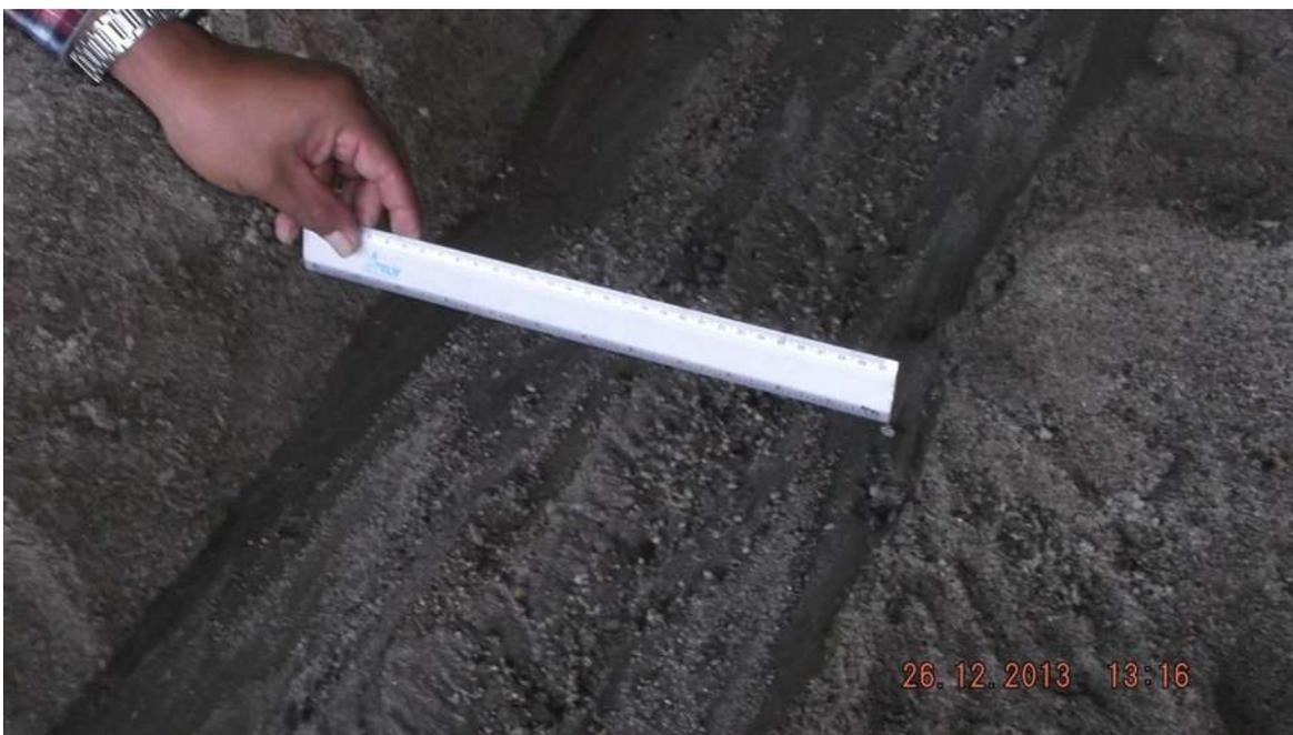
*Imagen 5.11. Medición de borde en la sección 0+560, 32cm de bordo, lo equivalente a 16m en el prototipo.*
