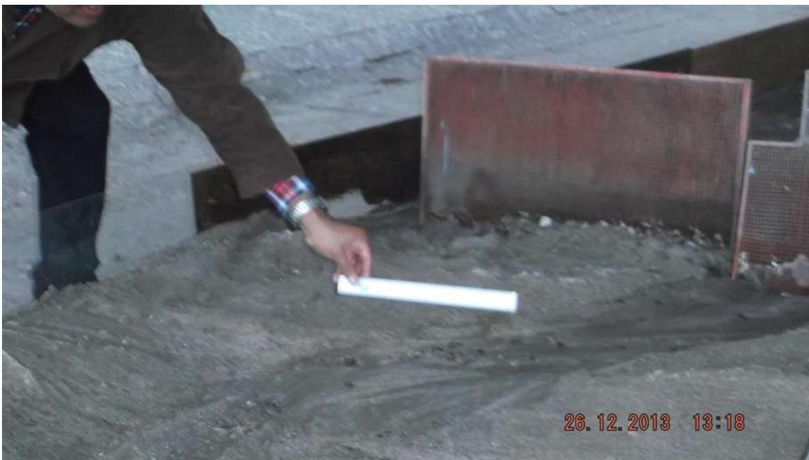
*Imagen 5.12. Medición en la sección 0+340 con aproximadamente 38cm de bordo.*
