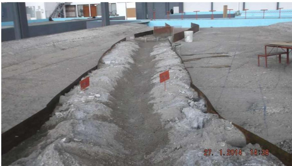
*Imagen 5.24. Modelo del río de tiripitio reconstruido un día antes de la prueba.*
