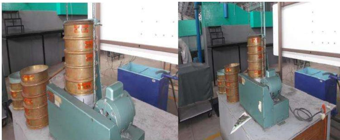
*Imagen 2.3 Realización de las pruebas granulométricas*
