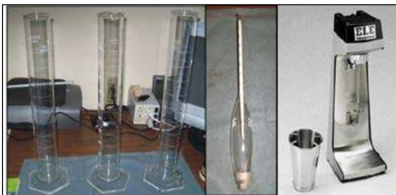
Equipo para la prueba del hidrómetro (Probeta de vidrio de capacidad de 1000 ml, hidrómetro, mezclador mecánico).
