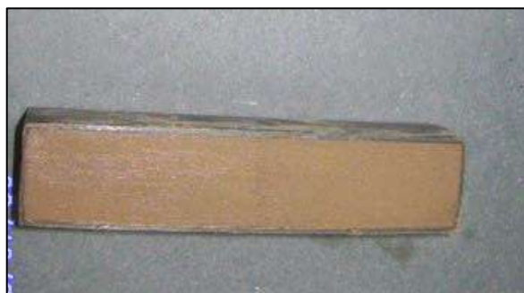
Muestra de Espécimen para contracción lineal.
