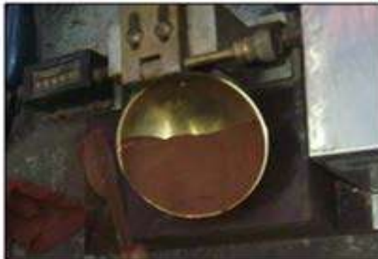
Extendido de material en la copa de Casagrande.
