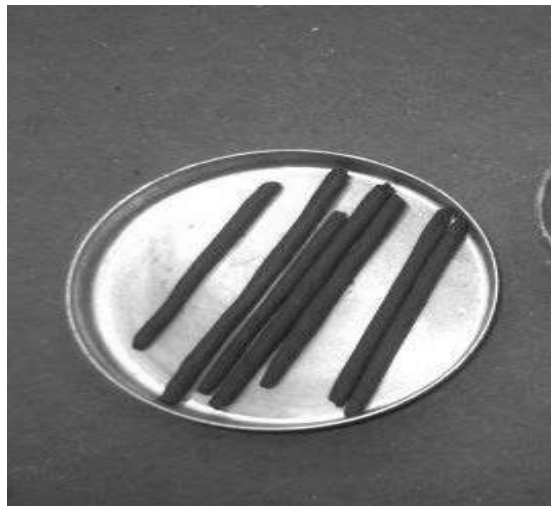
Muestra de Cilindros para Limite Liquido
