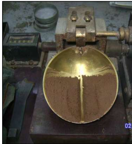
Ranuración del material en la copa de Casagrande.
