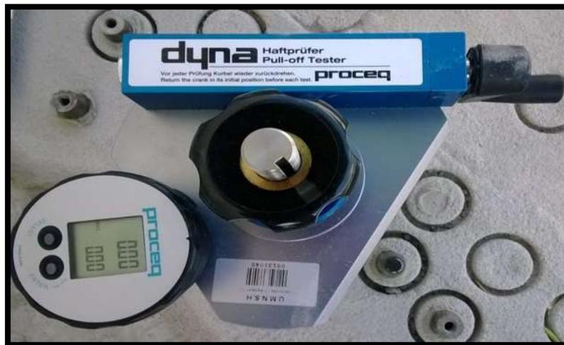
**Ilustración 66. Instrumento de medición Pull Off**
