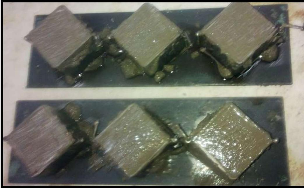
**Ilustración 39 . Llenado de los moldes cúbicos en cuatro capas.**
