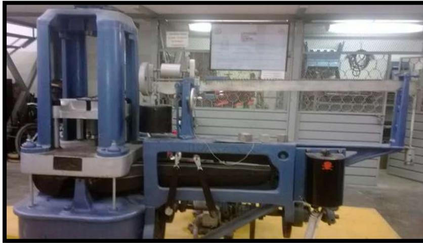
**Ilustracion 55. Máquina universal Tinius Olsen utilizada para las pruebas de compresión.**
