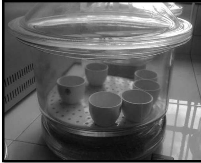
**Ilustracion 29. El desecador donde se dejan enfriar la muestra a temperatura ambiente.**
