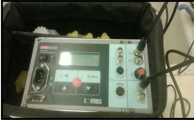
**Ilustración 51. Equipo de velocidad de pulso ultrasónico, modelo 58-E0049 marca CONTROLS.**
