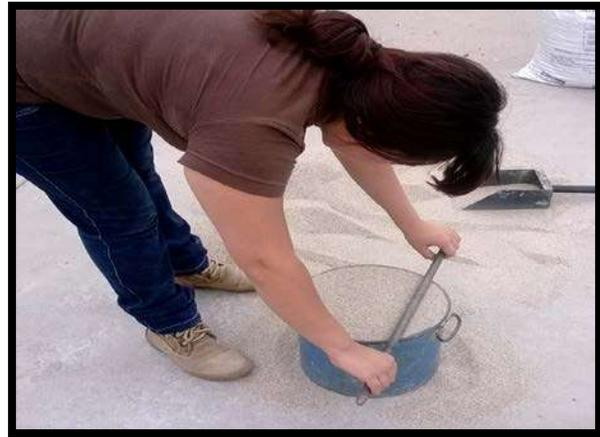
**Ilustración 12. Llenado y enrasado del material inerte.**
