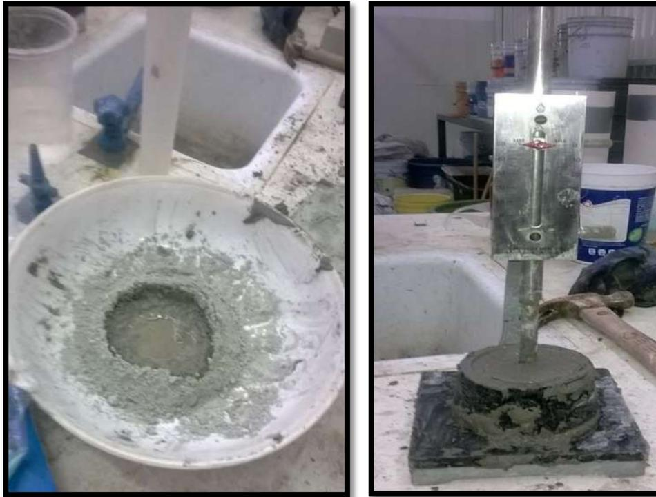
**Ilustración 34. Preparación de la mezcla y medición de la consistencia.**
