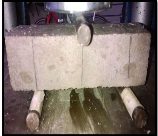
**Ilustración 58. Aplicación de la carga en la maquina universal Tinius Olsen en el punto medio del prisma.**
