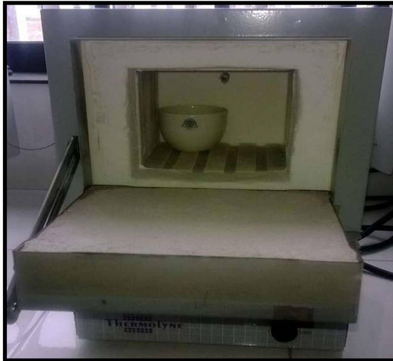
**Ilustracion 28. Los crisoles se introducen a la mufla a una temperatura de  $550^{\circ}\text{C} \pm 50^{\circ}\text{C}$ .**
