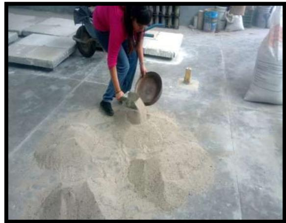
**Ilustración 10. Realización del cuarteo en arena.**
