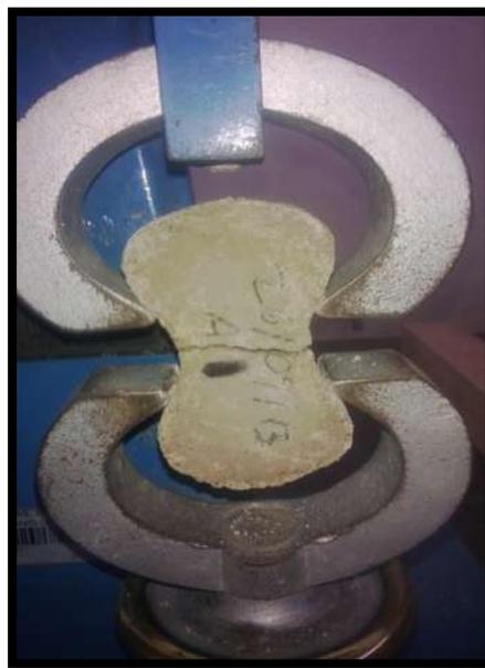
**Ilustración 59. Falla del espécimen por medio de la aplicación constante de municiones.**
