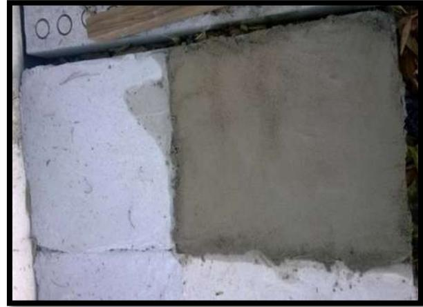
**Ilustración 48. Revestimiento de la losa con las cuatro marcas del mortero en investigación.**
