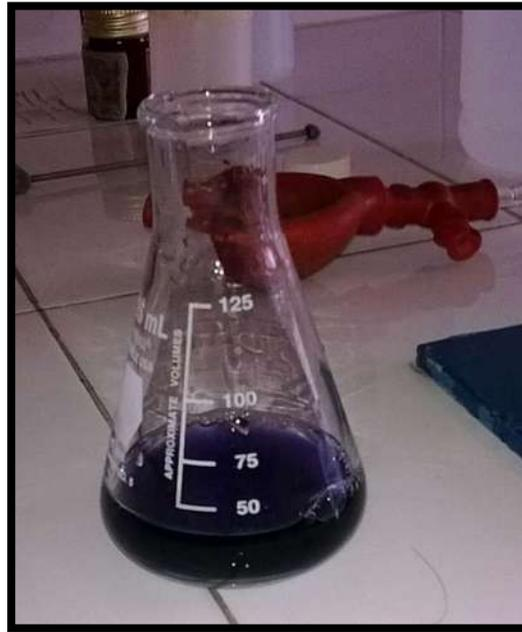
**Ilustración 23. Titulación de la disolución cambio de color rojizo a azul**
