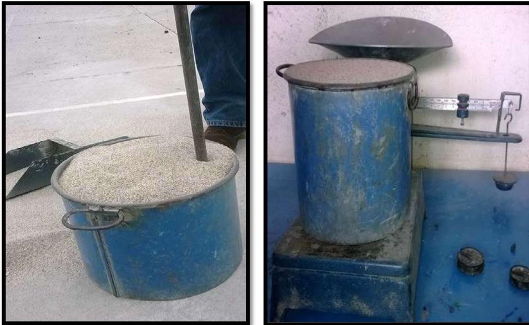
**Ilustración 12. Llenado y enrasado del material inerte..**
