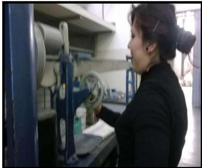
**Ilustracion 56. Aplicación de carga constante a los especímenes cubicos en la maquina universal Tinius Olsen a la edades antes mencionadas.**
