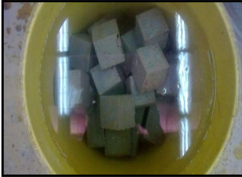
**Ilustración 41. Curado de los especímenes en recipientes de 19 litros.**
