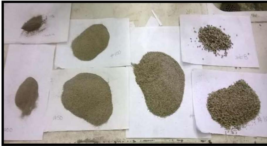
**Ilustración 16.** Material que se iba reteniendo en las mallas mencionadas con anterioridad.
