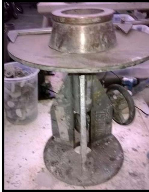
**Ilustración 31. Mesa de fluidez con ensaye de bronce y calibrador, los instrumentos para realizar la prueba de fluidez.**
