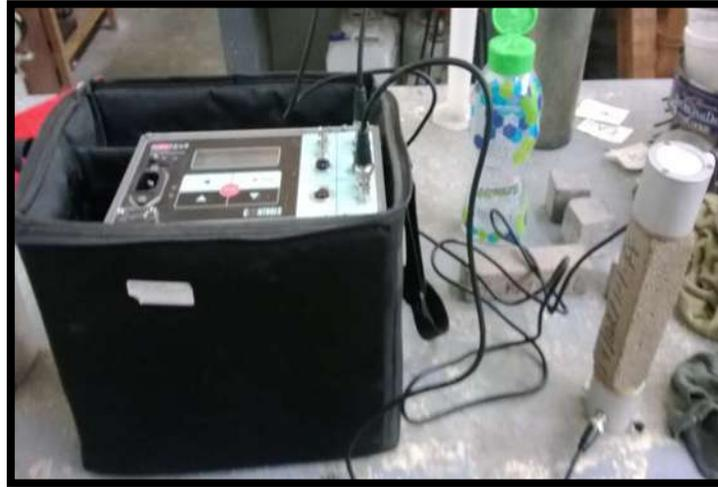
**Ilustración 52.** Se muestra el procedimiento para la correcta ubicación de los transductores en los cubos, así como el aparato de ultrasonido empleado para la realización de esta prueba.
