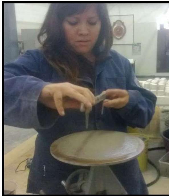
**Ilustración 33. Realización de las mediciones en la mesa de fluidez.**
