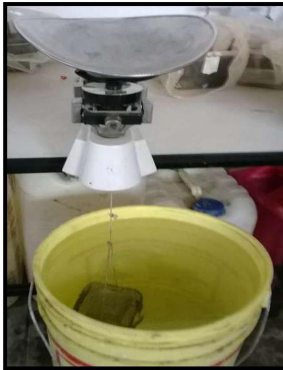
**Ilustración 49. Realización de la prueba de Gravedad específica con la canastilla ya adaptada.**
