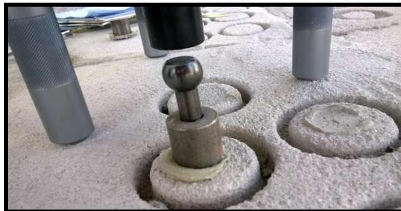
**Ilustración 67. Perno con cabeza de pelota al cual se le introduce el Pull Off.**
