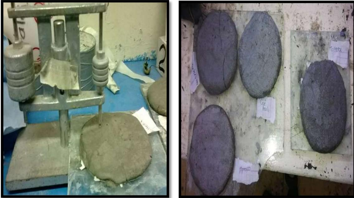
**Ilustración 35. Tiempo inicial y final del fraguado de los morteros.**
