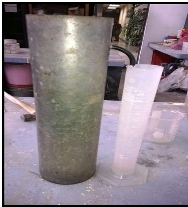
**Ilustración 50. Desalojo del agua después de colocar el espécimen dentro del picnómetro.**
