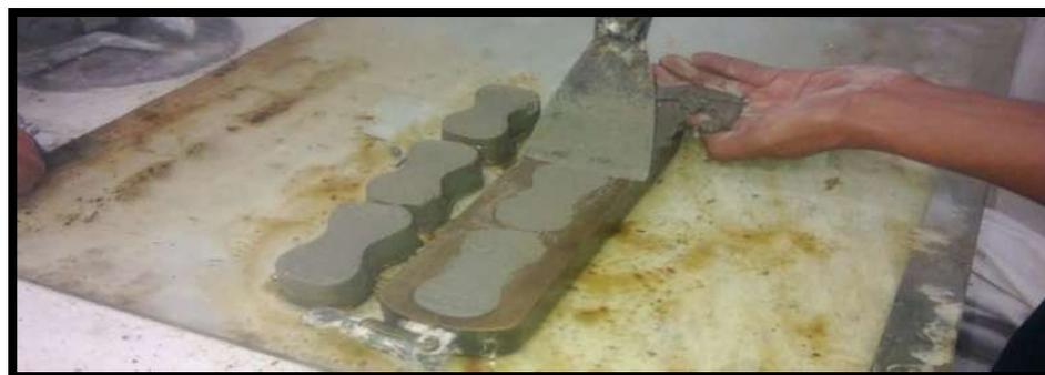
**Ilustración 46. Enrazamiento y elaboración de las briquetas.**
