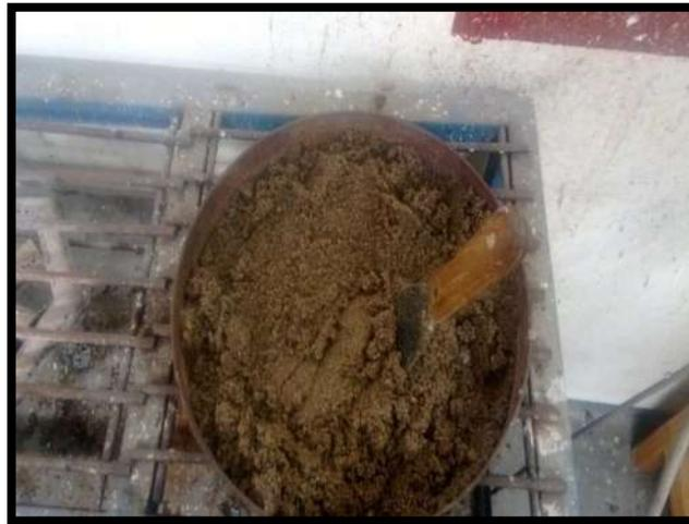
**Ilustración 11. Secado artificial de la muestra representativa de arena.**
