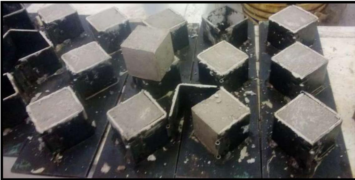
**Ilustración 40. Descimbrado de los especímenes transcurridas las 24 horas.**
