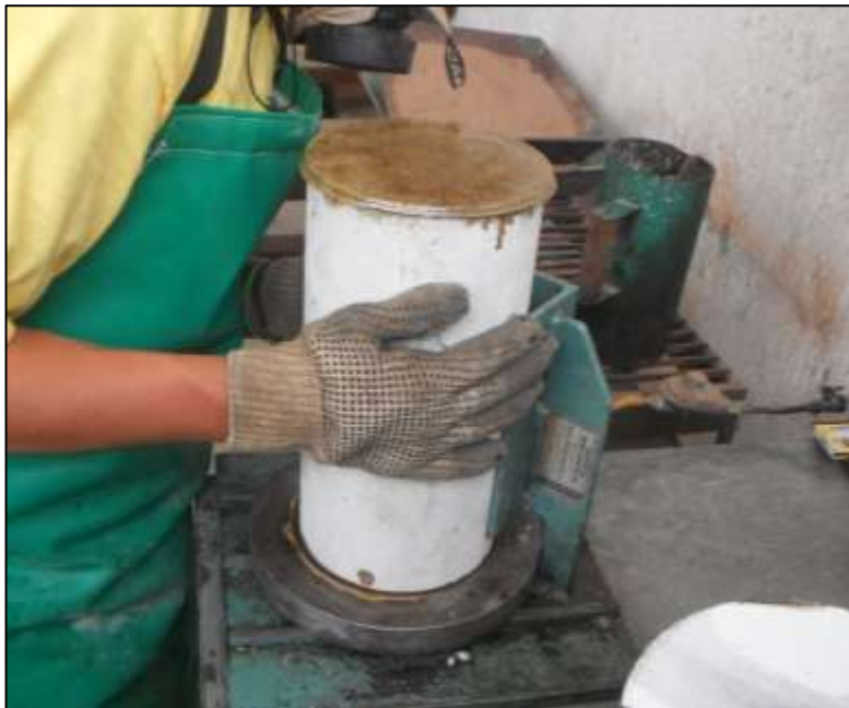
Imagen 3.18.- Cabeceo de cilindros de concreto hidráulico en el laboratorio.
