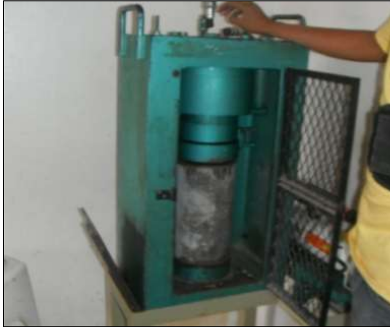
Imagen 3.19.- Ensayo a compresión de cilindros de concreto hidráulico.
