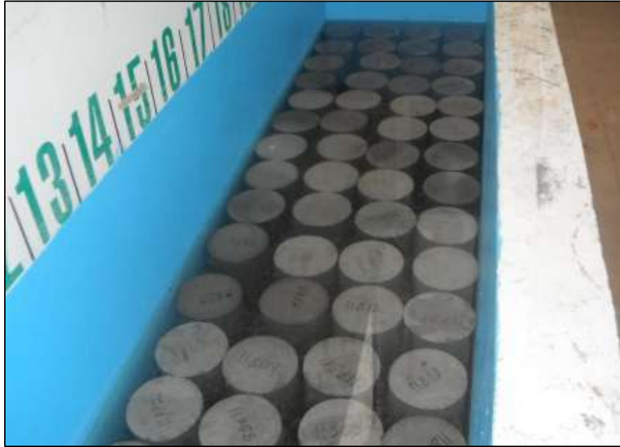
Imagen 3.17.- Curado de los especímenes de concreto hidráulico en una pileta.
