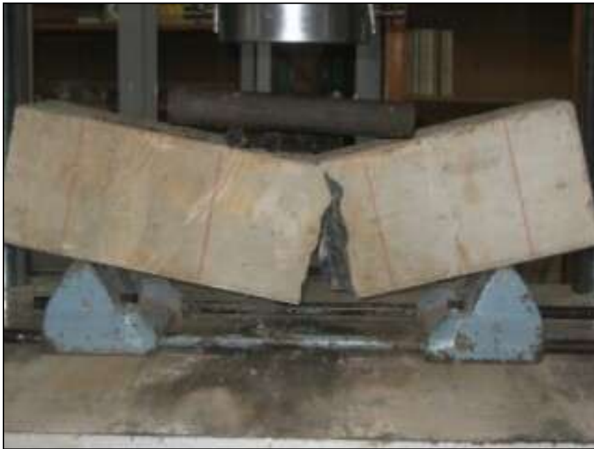
Imagen 4.7.- Ensayo de vigas de concreto hidráulico.
