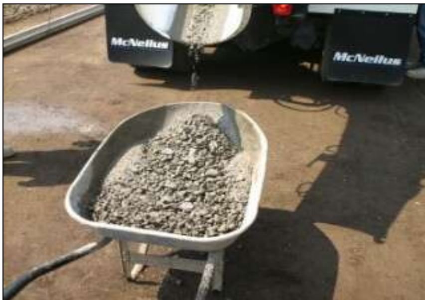
Imagen 3.14.- Toma de muestra de concreto para elaboración de especímenes.
