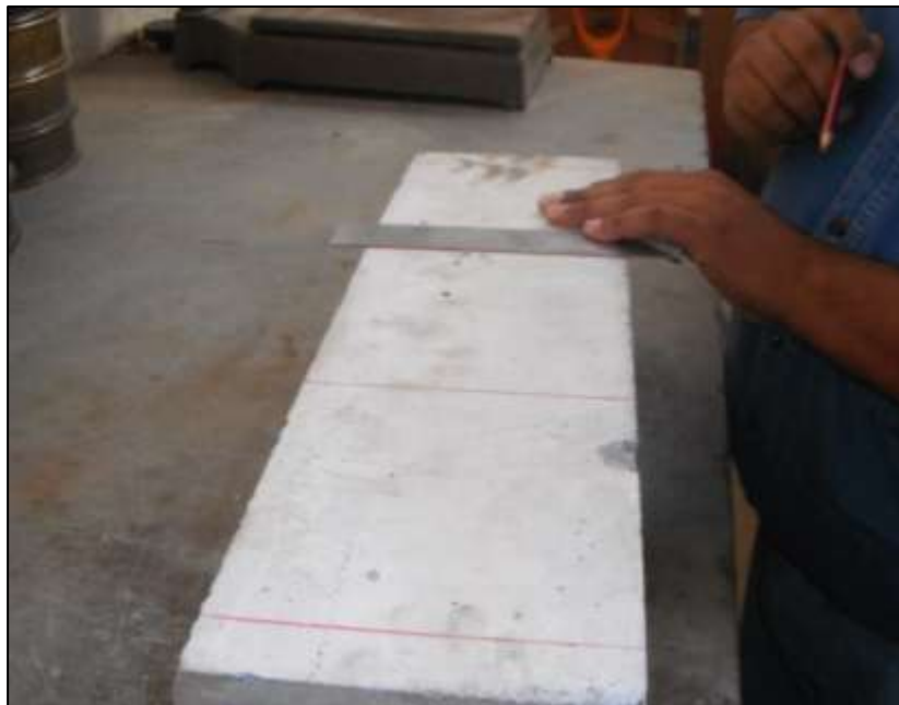
Imagen 4.6.- Preparación para su ensaye de una de las vigas de concreto hidráulico.
