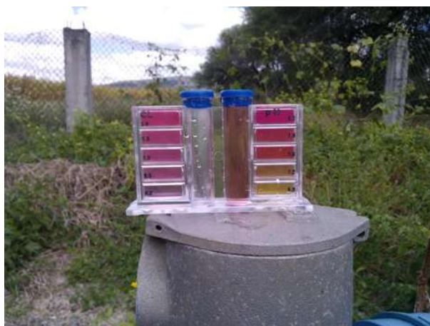
Figura 6.13, prueba de cloro en campo
