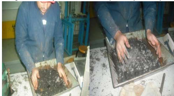
Fig.28.- Muestra la homogenización del material.
