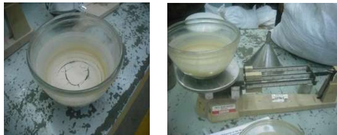
Fig.26.- Muestra lista para pesarse después de haber estado en el horno y estar totalmente seca.
