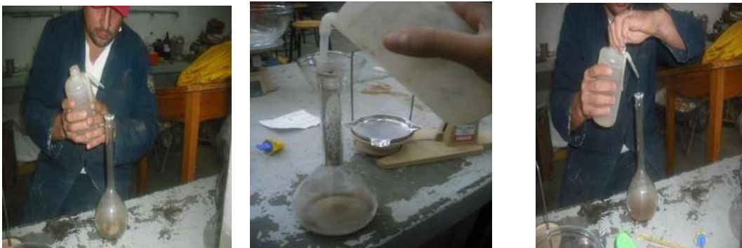
Fig.21.- Llenado de los matraces con agua destilada.
