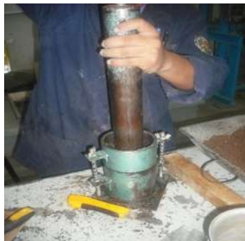
Fig.29.- Muestra la compactación de una de la capas.
