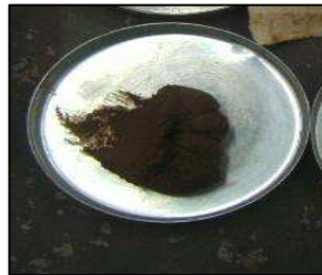
Fig.17.- Porción de material para obtener su humedad.
