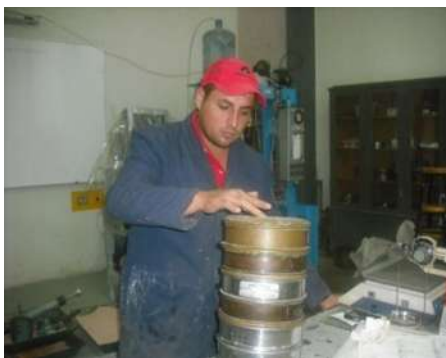
Fig.10.- Muestra la forma de colocar las mallas para efectuar el cribado de material que paso la malla N°4.
