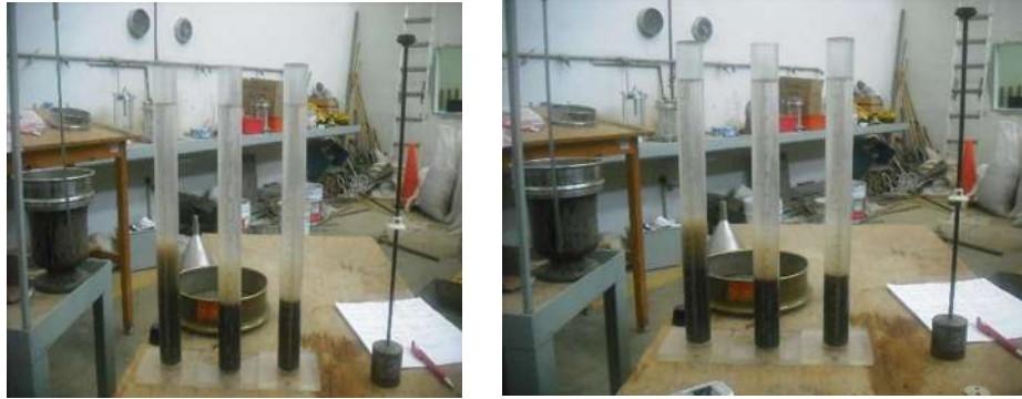
Fig.47.- Muestras reposando para la prueba equivalente de arenas.
