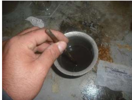
Fig.7.- Agregando 500 cm (Aproximados) de agua al material.
