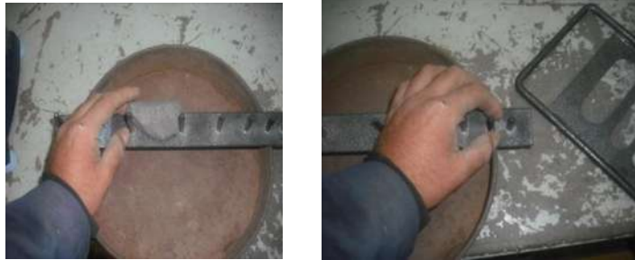
Fig.53.- Muestra como pasan las partículas alargadas.
