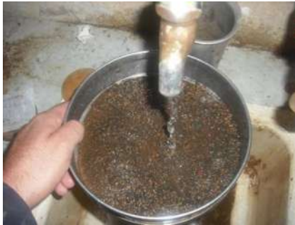
Fig.8.-Vertido y lavado de material fino
