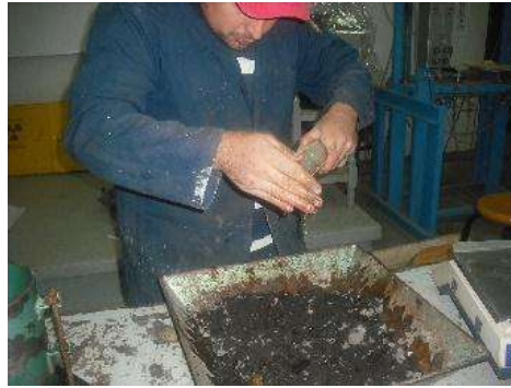
Fig.27.- Muestra incorporación de agua al material.
