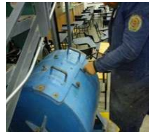
Fig.50.- Colocación de las esferas requeridas dentro de la máquina.
