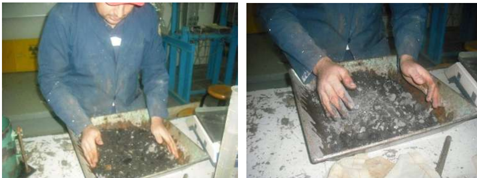
Fig.32.- Muestra homogenización de la muestra.
