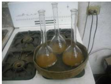
Fig.22.- Puesta del agua de los matraces en ebullición para facilitar la expulsión del aire atrapado.
