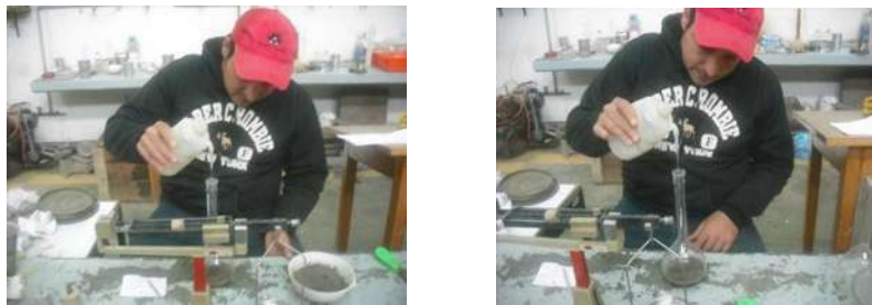
Fig.24.- Adición de agua destilada hasta la marca indicadora de los matraces, una vez que se ha llevado a cabo la succión del aire.
