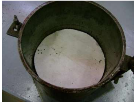
Fig.38.- Muestra la colocación del papel filtro en la muestra.
