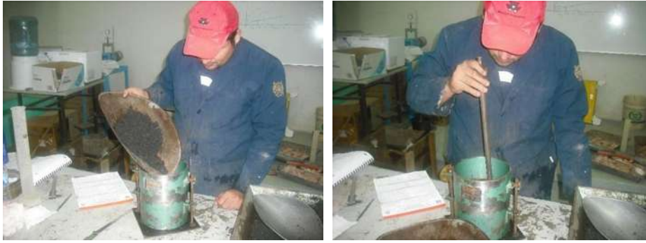
Fig.33.- Colocacion y varillado de la muestra en el molde.
