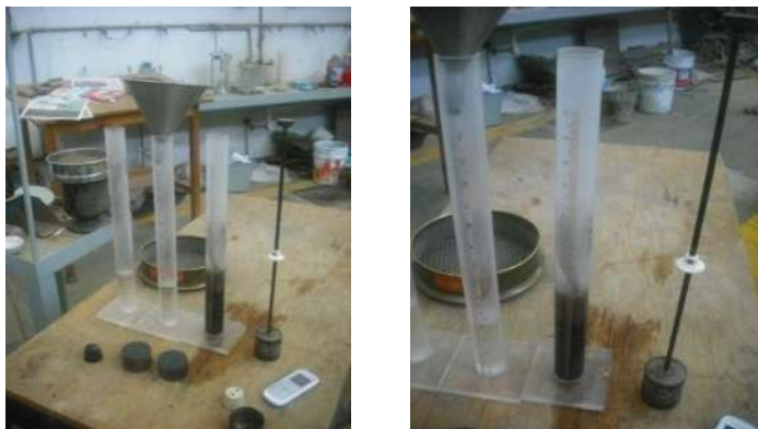
Fig.43.-Llenado del cilindro con la solucion asta la altura de 4".
