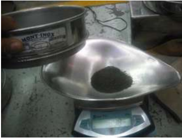
Fig.11.- Muestra el pesado del material retenido en mallas finas
