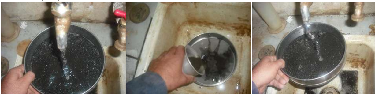
Fig.2.- Colocación de la muestra fina y lavado por la malla No. 200.
