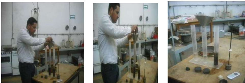
Fig.44.- Colocacion del material con la ayuda de un embudo.
