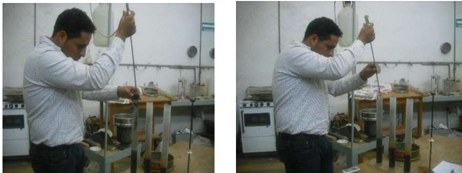
Fig.46.-vLlenado del cilindro de prueba hasta la altura de 15"
