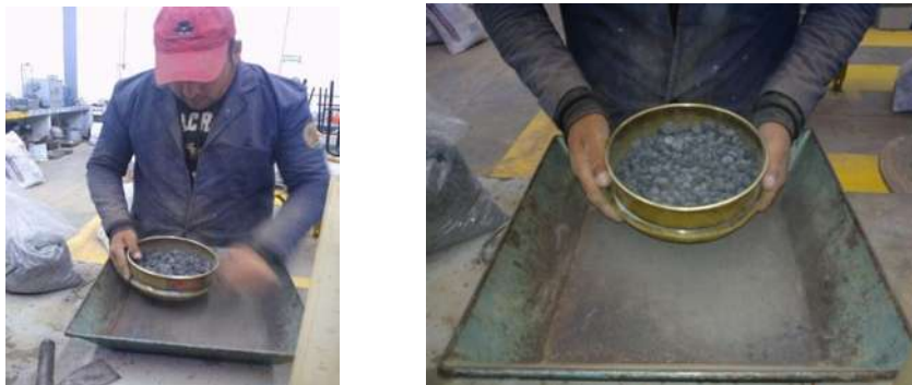
Fig.52.- Se criba el material resultante por la malla No. 12 para así obtener el pf.
