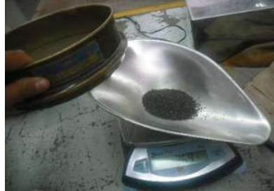
Fig.11.- Muestra el pesado del material retenido en mallas finas
