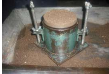
Fig.30.- Muestra el enrazado del molde.
