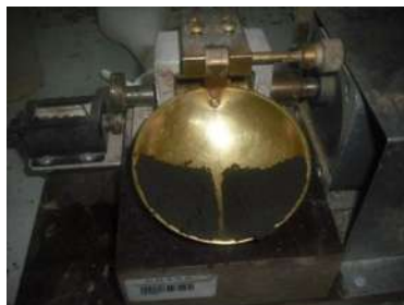
Fig.15.- Ranuración del material en la copa de Casagrande.
