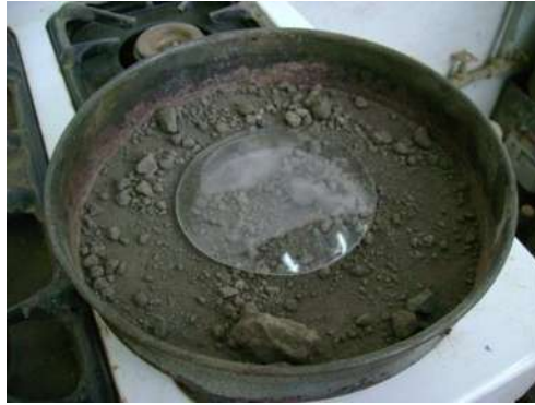
Fig.37.- Muestra secado de material para obtener la humedad.
