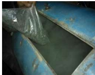
Fig.49.- Con las muestras correspondientes de cada material pesado se colocan dentro de la máquina.
