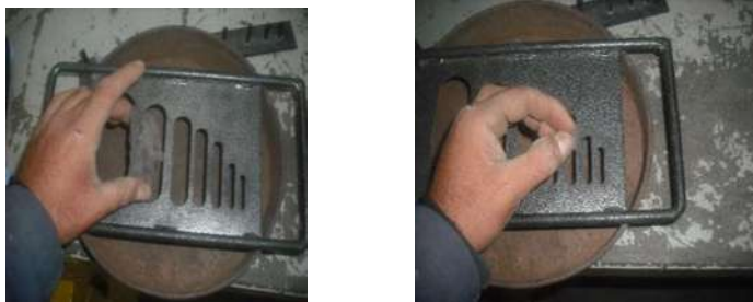
Fig.54.- Muestra la forma en que se pasan las partículas lajeadas
