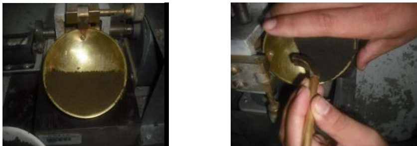
Fig.14.- Extendido de material en la copa de Casagrande
