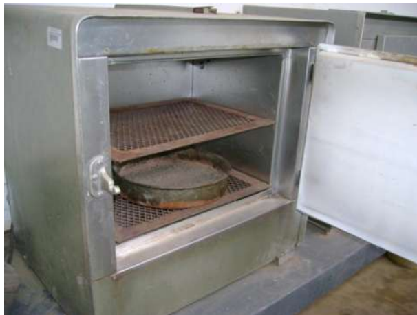
Fig.4.- Secado del material que será utilizado en la granulometría fina.
