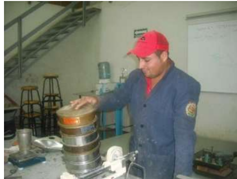
Fig.10.- Muestra la forma de colocar las mallas para efectuar el cribado de material que paso la malla N°4.
