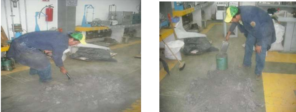
Fig.1.- Cuarteo de la muestra representativa.
