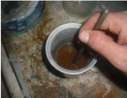
Fig.7.- Agregando 500 cm (Aproximados) de agua al material.
