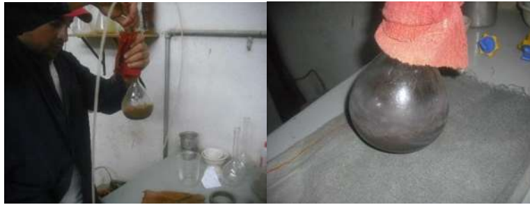
Fig.23.- Puede observarse como se utiliza el dispositivo de succión, y la manera como brotan las burbujas de aire en las muestras.
