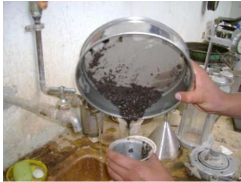
Fig.9.- Muestra la forma de devolver al vaso el material retenido en la malla N° 200.
