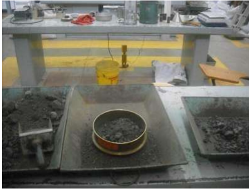
Fig.31.- Muestra el cribado y pesado de la muestra a utilizar.
