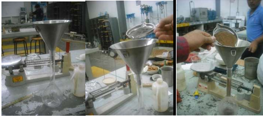
Fig.20.- Llenado de los tres matraces necesarios para realizar la Densidad de sólidos.
