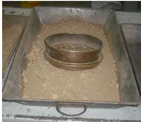
Fig.3.- Muestra el cribado a través de la malla N° 4.
