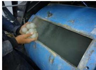
Fig.50.- Colocación de las esferas requeridas dentro de la máquina.
