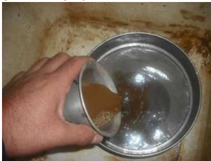
Fig.8.-Vertido y lavado de material fino
