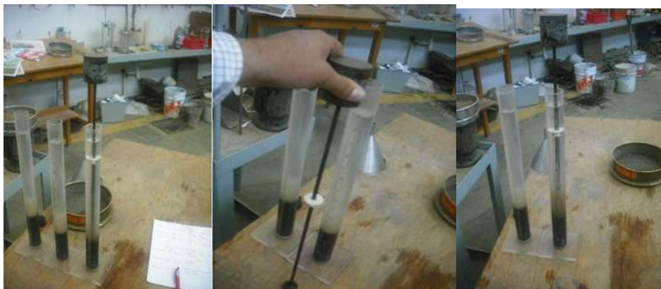
Fig.48.- Se toma la lectura de arena con la ayuda la varilla con pison.
