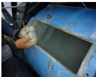
Fig.50.- Colocación de las esferas requeridas dentro de la máquina.
