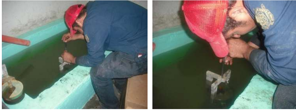
Fig.40.- Muestra la colocación de la muestra en el depósito de agua.
