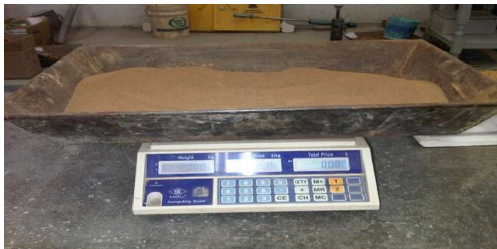
Fig. 44 Preparación de la muestra que pasa la malla N° 40.
