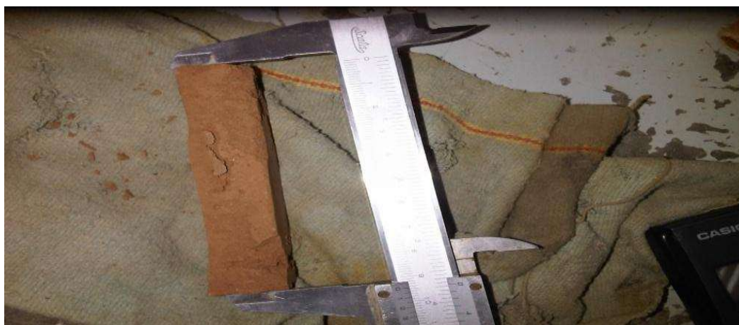
Fig. 39 Obteniendo longitud y ancho de la muestra fuera del molde.
