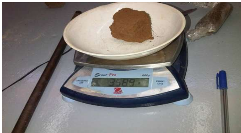
Fig. 47 Extracción de una porción de la muestra para su obtención del peso seco.
