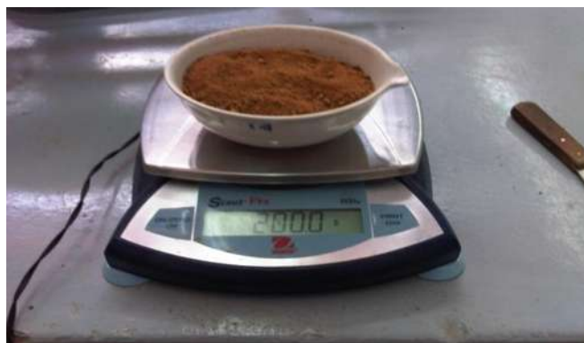
Fig. 57 Muestra extraída y secado en el horno para obtener su peso seco.
