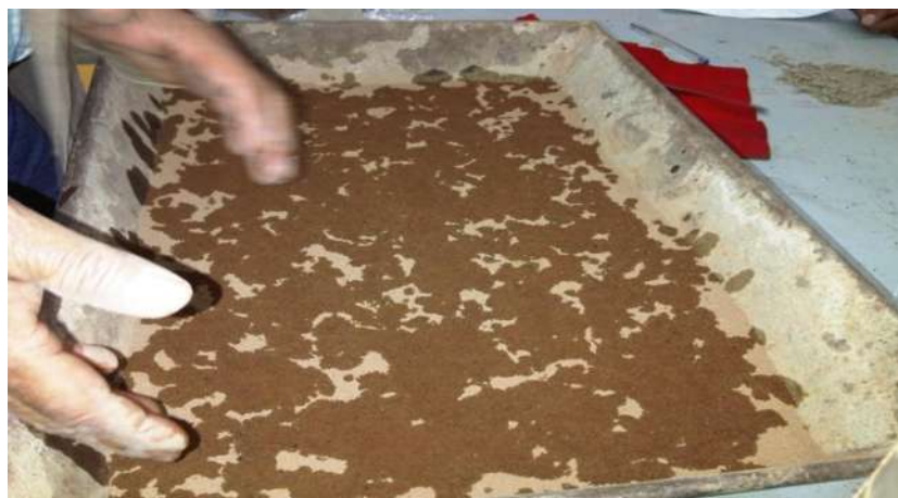
Fig. 61 Homogenización de la muestra
