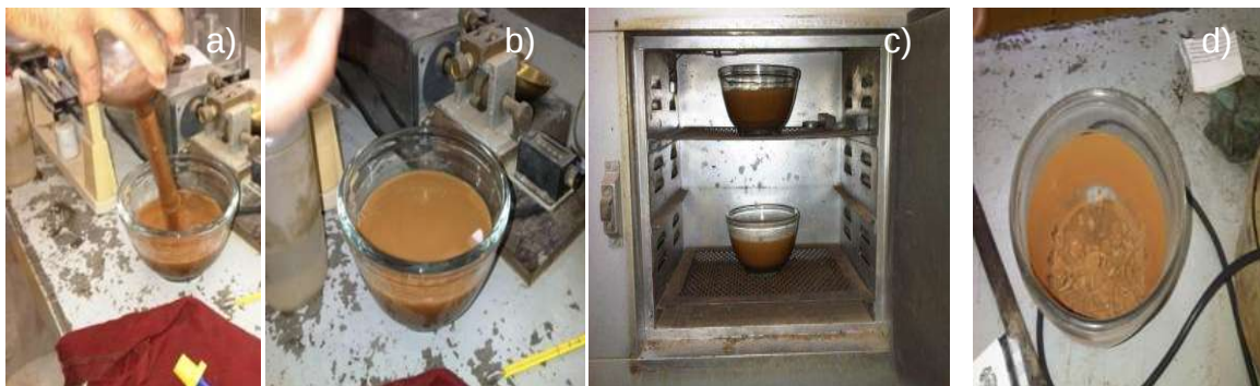
Fig. 32 a) Vaciado del material en una capsula de porcelana, b) Pesado de la muestra más tara, c) Introducción al horno, d) Obtención peso muestra seca.
