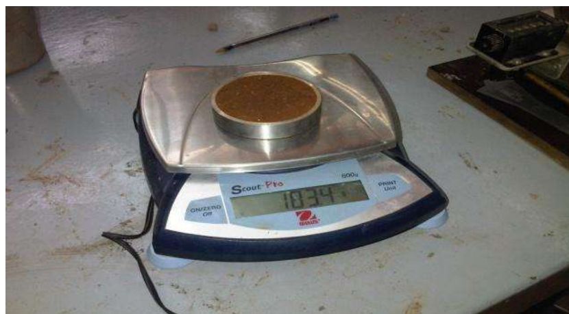
Fig. 66 Peso de la muestra húmeda con el anillo.
