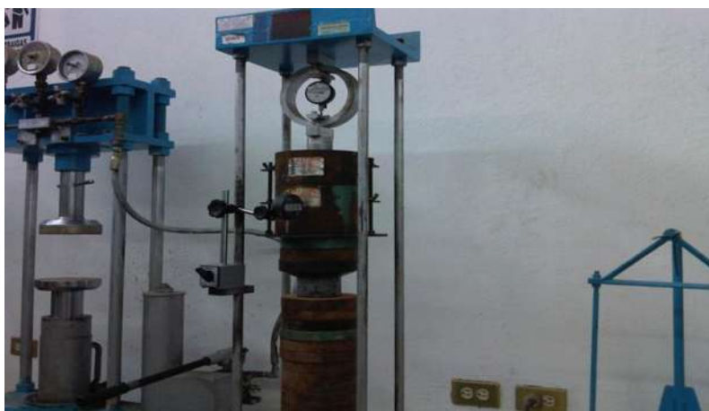
Fig. 55 Colocación de la muestra para obtener la penetración en la prensa del V. R.S.
