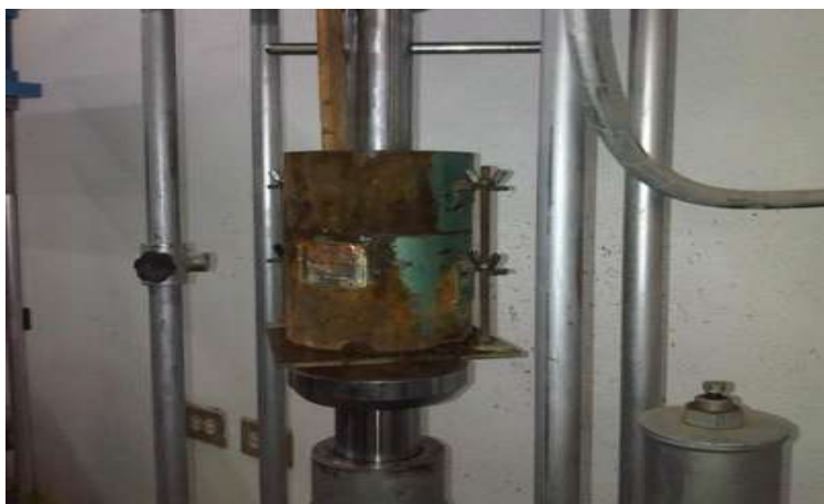
Fig. 63 Aplicación de esfuerzo con la máquina de prensar hidráulico
