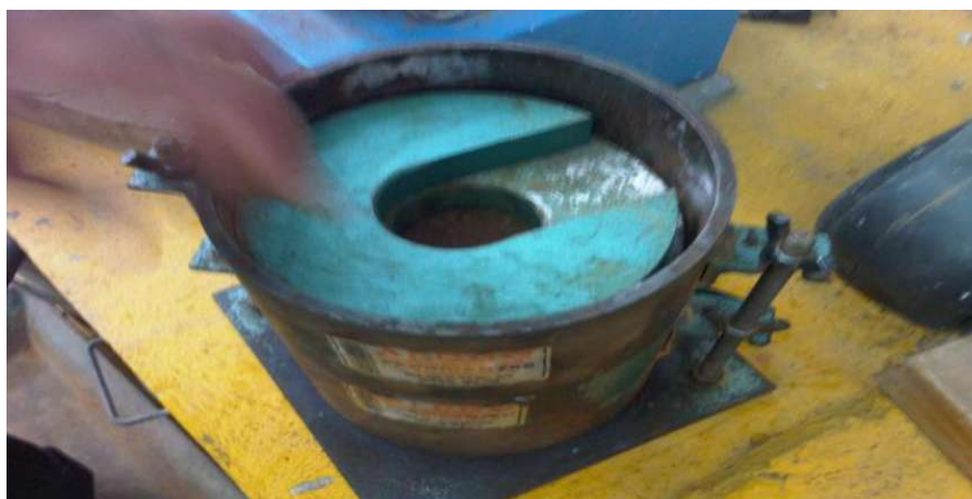
Fig. 54 Se le coloca dos placas de acero encima de la muestra pero dentro del molde antes de colocarla en la prensa de V. R. S.
