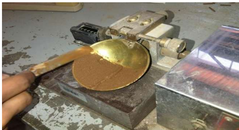
Fig. 35 Abertura de la ranura sobre el material
