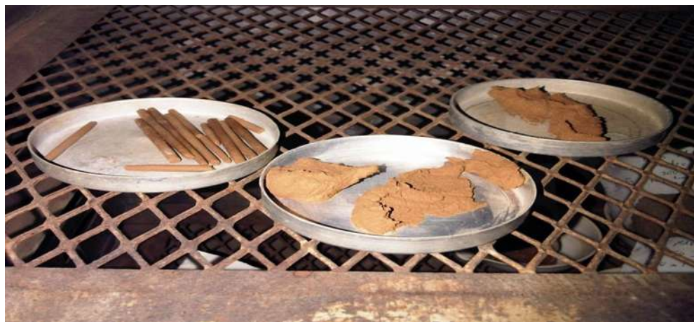
Fig. 37 Obtención de peso seco del material del límite plástico
