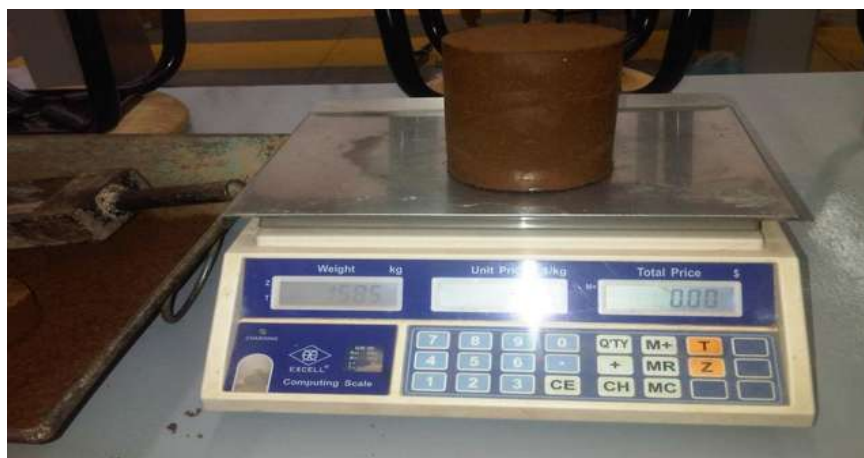
Fig. 46 Extracción de la muestra del molde para obtener su peso.
