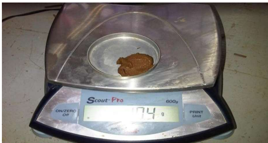
Fig. 36 Obtención del peso de la muestra húmeda
