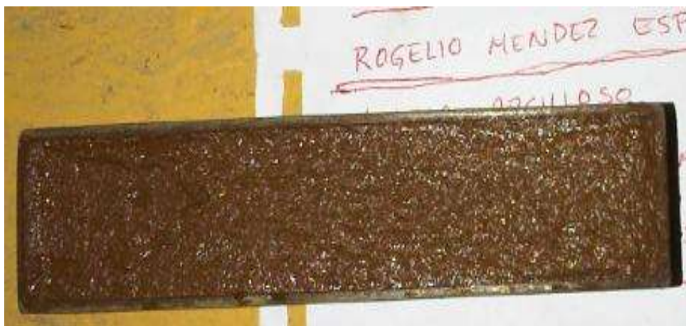
Fig. 38 Muestra homogenizada dentro del molde para obtener la contracción lineal.
