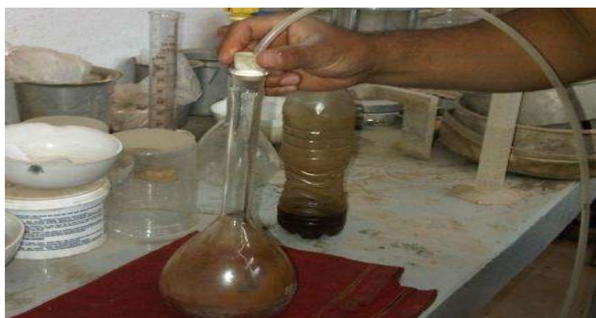
Fig. 30 Expulsión de aire de la muestra después del baño María
