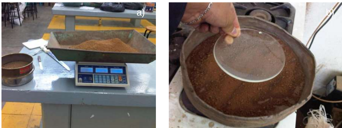
Fig. 50 a) Preparación del material, b) Obtención de humedad inicial de la muestra.
