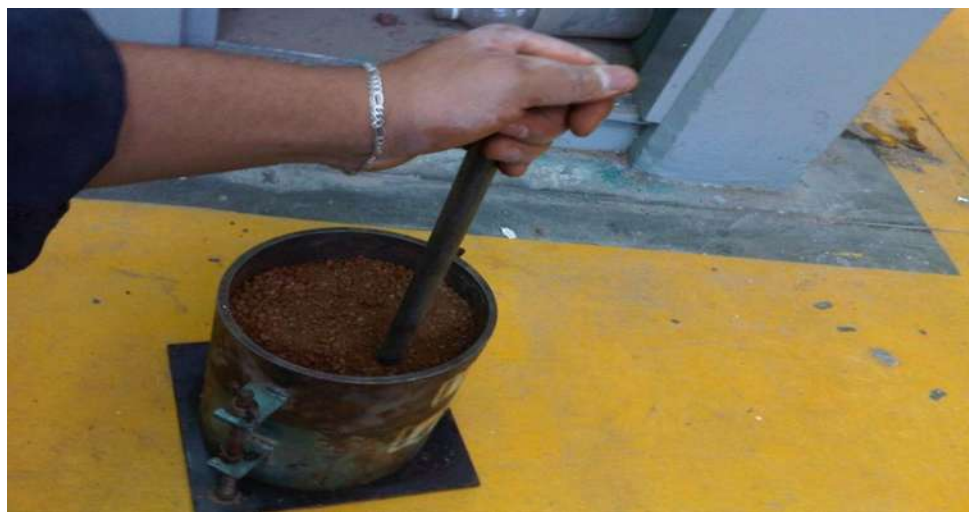
Fig. 52 La muestra se vierte en el molde en tres capas con 25 golpes cada una.
