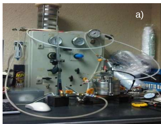
Fig. 71 a) Demostración de la gráfica al poner en prueba un espécimen de suelo al consolidometro y b) Manómetros que se usan al momento de montar la prueba.
