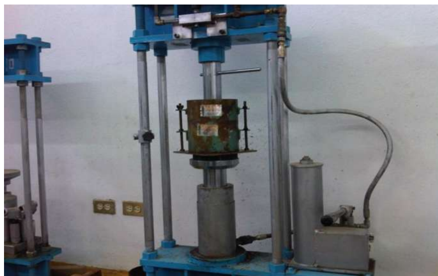
Fig. 53 Se le aplica una carga a la muestra con el prensador hidráulico
