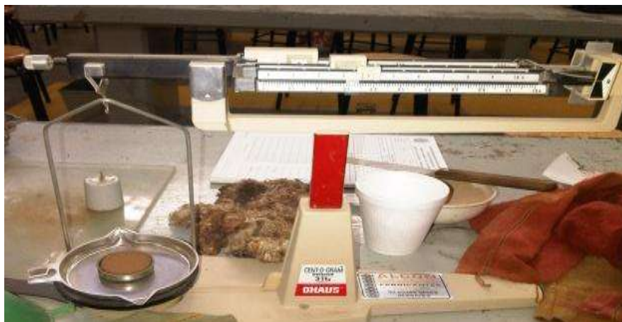
Fig. 40 Material seco para su determinación de la contracción volumétrica
