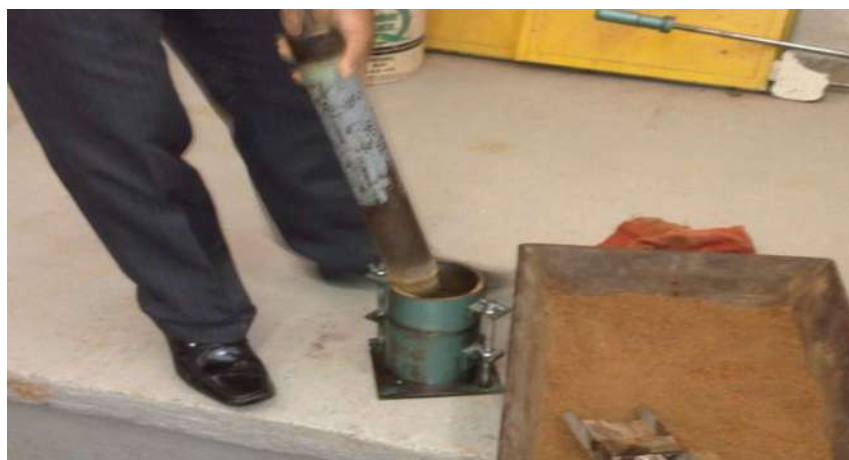
Fig. 45 Apisonado de la muestra dentro del molde en tres capas, 25 golpes cada capa.
