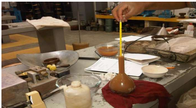
Fig. 31 Medición de temperatura después de la expulsión de aire y llenado de agua destilada hasta el aforo de la probeta.
