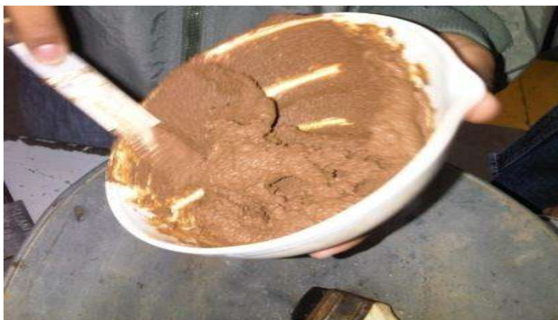
Fig. 34 Homogenización de la muestra
