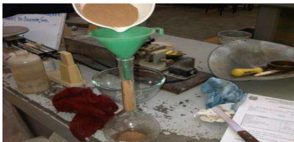
Fig. 28 Mezcla de la muestra con agua destilada.
