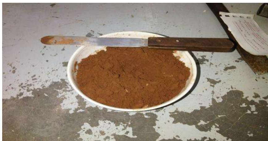
Fig. 33 Preparación de la muestra para su homogenización
