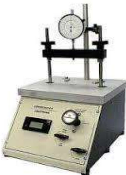
Fig. 6 Liga 3 Consolidometro neumático GEOTEC
