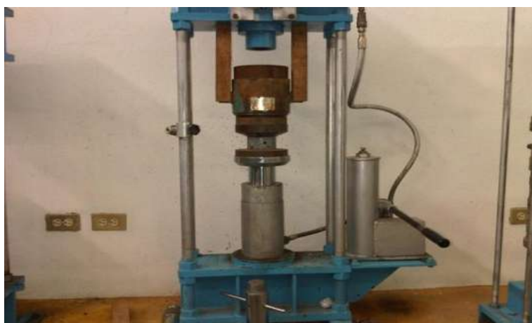
Fig. 64 Extracción de la muestra con el prensador hidráulico.
