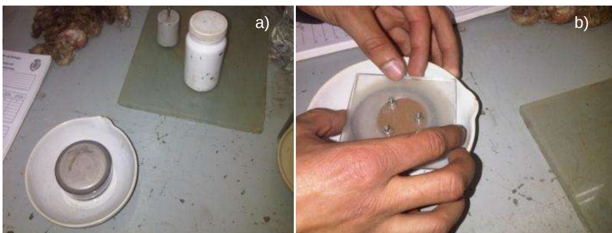
Fig. 41 Determinación de la contracción volumétrica con mercurio fig. a) y b).
