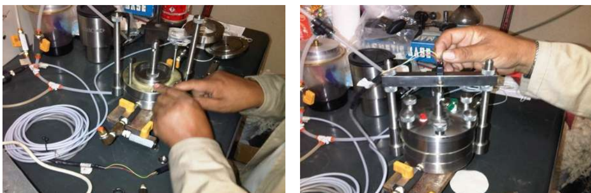
Fig. 68 Montaje del espécimen den el aparato de consolidación
