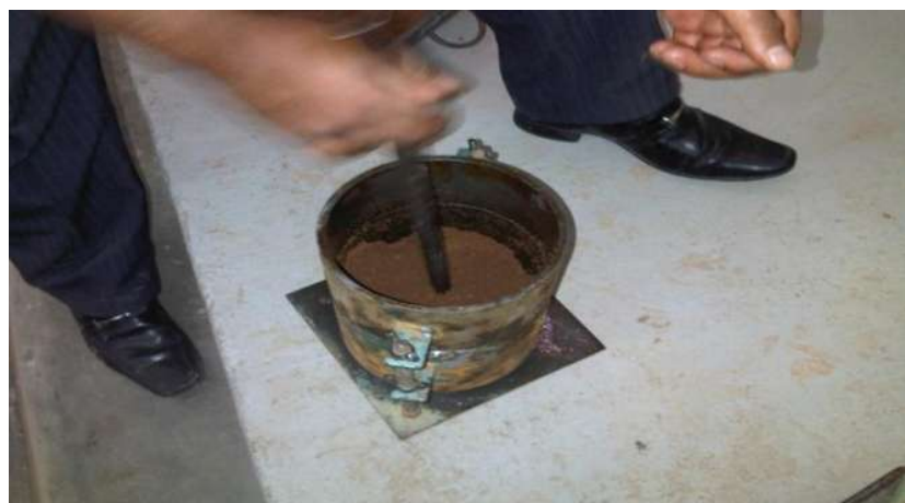
Fig. 62 Vertido de la muestra al molde en tres capas.
