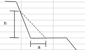
SECCION EXTRACCION DERRUMBES
